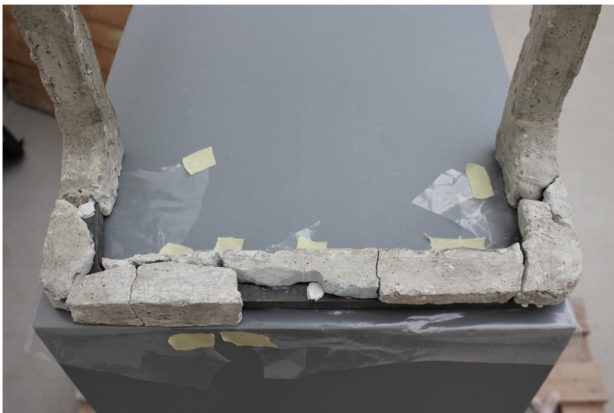
Obr. č. 46. Lepení fragmentů spodní části překážky
