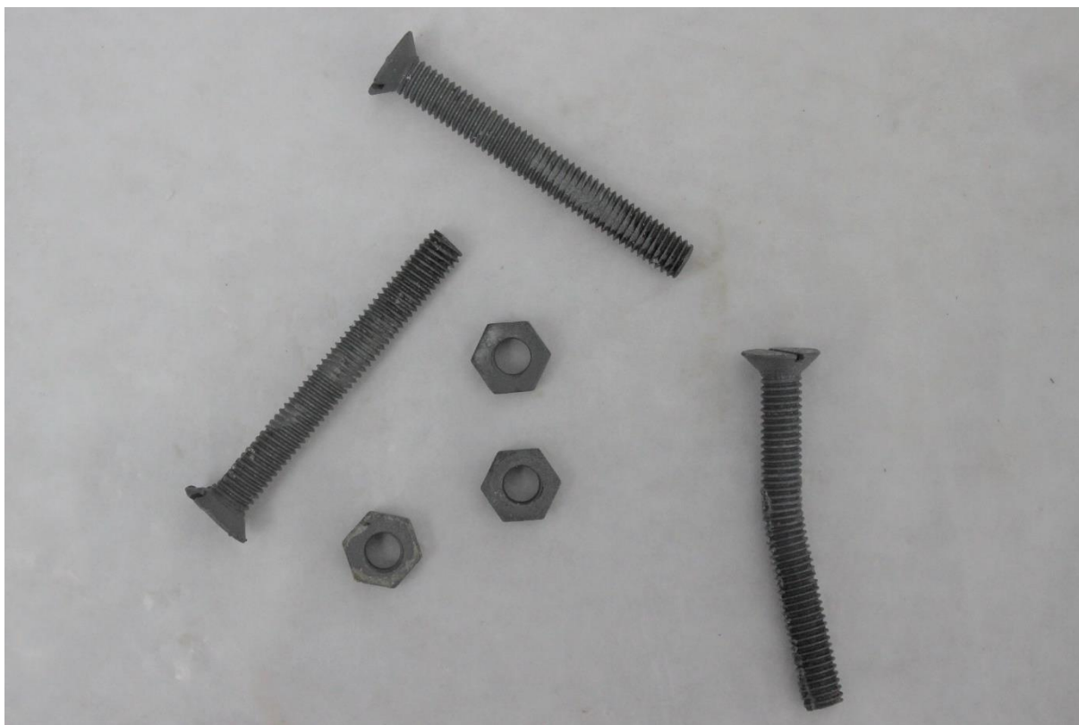
Obr. č. 36. Šrouby po pískování a ošetření inhibitem kovu
