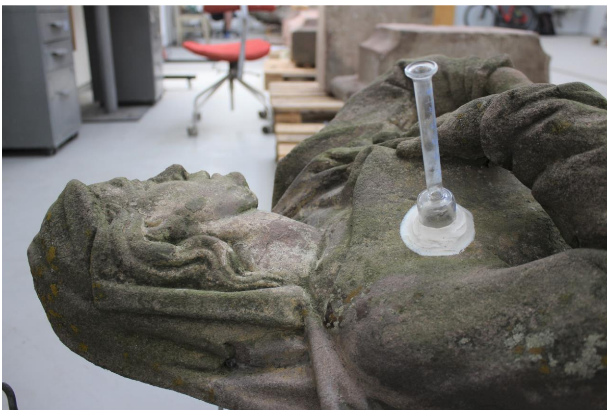
Obr. č. 23. Měření nasákavosti materiálu Karstenovou trubicí
