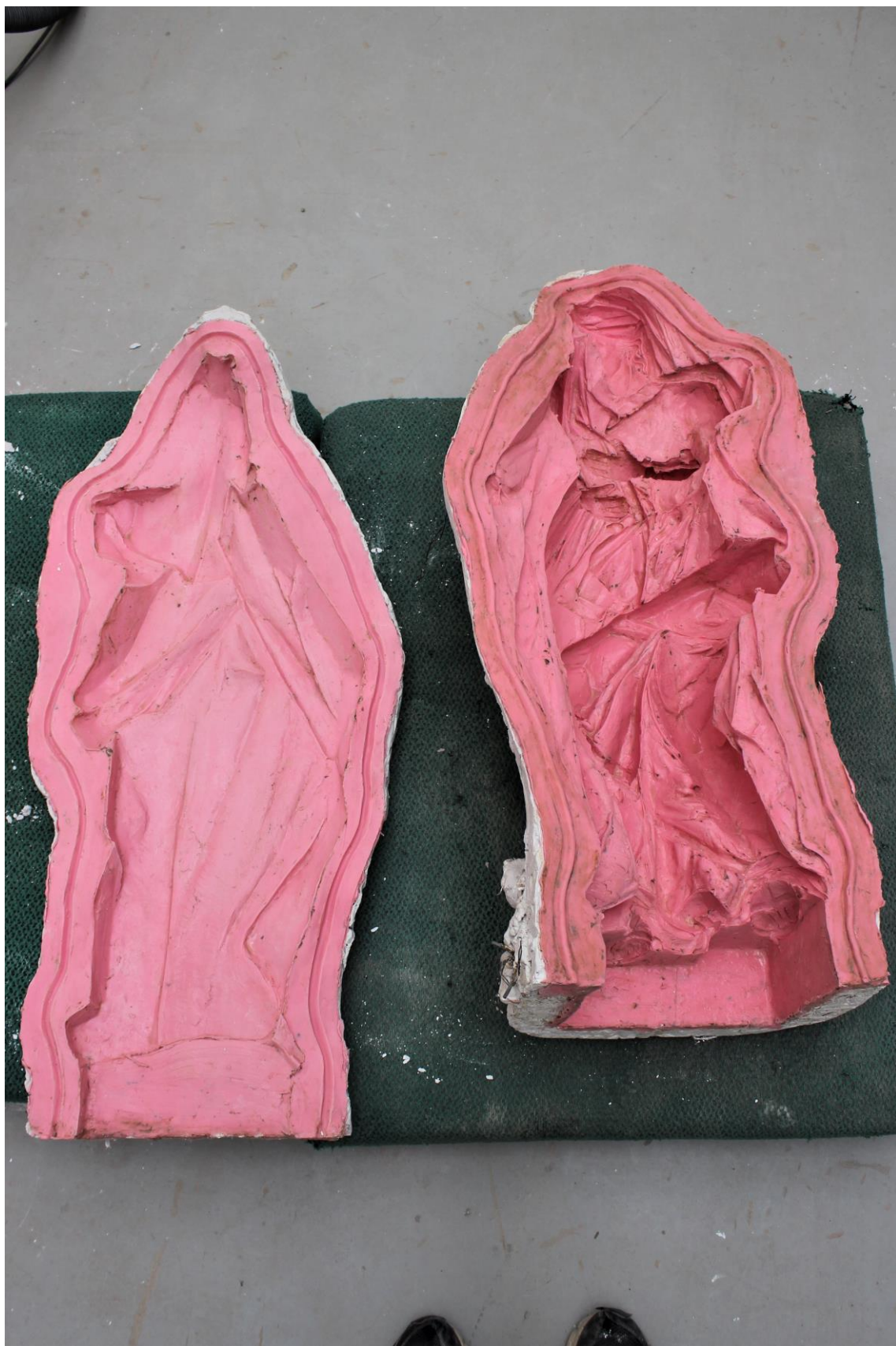
Obř. č. 8. Vytvoření kombinované silikonové formy
