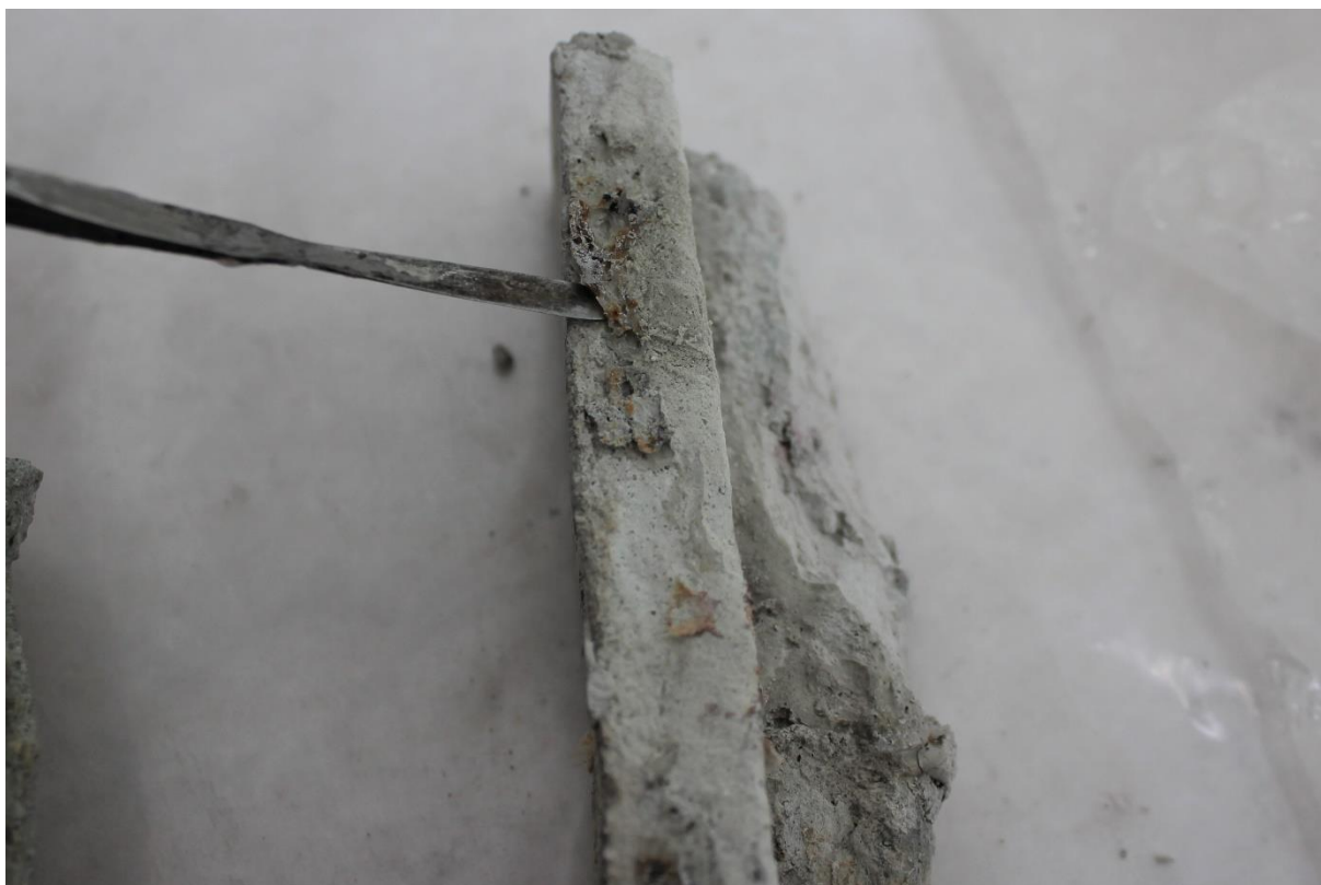
Obr. č. 41. Mechanické odstraňování zbytků lepidla z odlomených částí překážky
