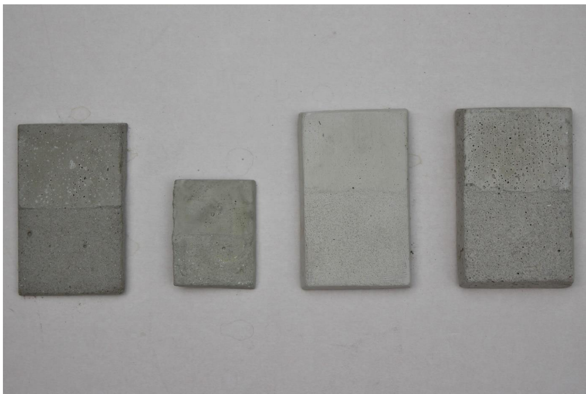
Obr. č. 34. Zkouška tmelů, jako nejvhodnější byl vybrán třetí a čtvrtý tmel
