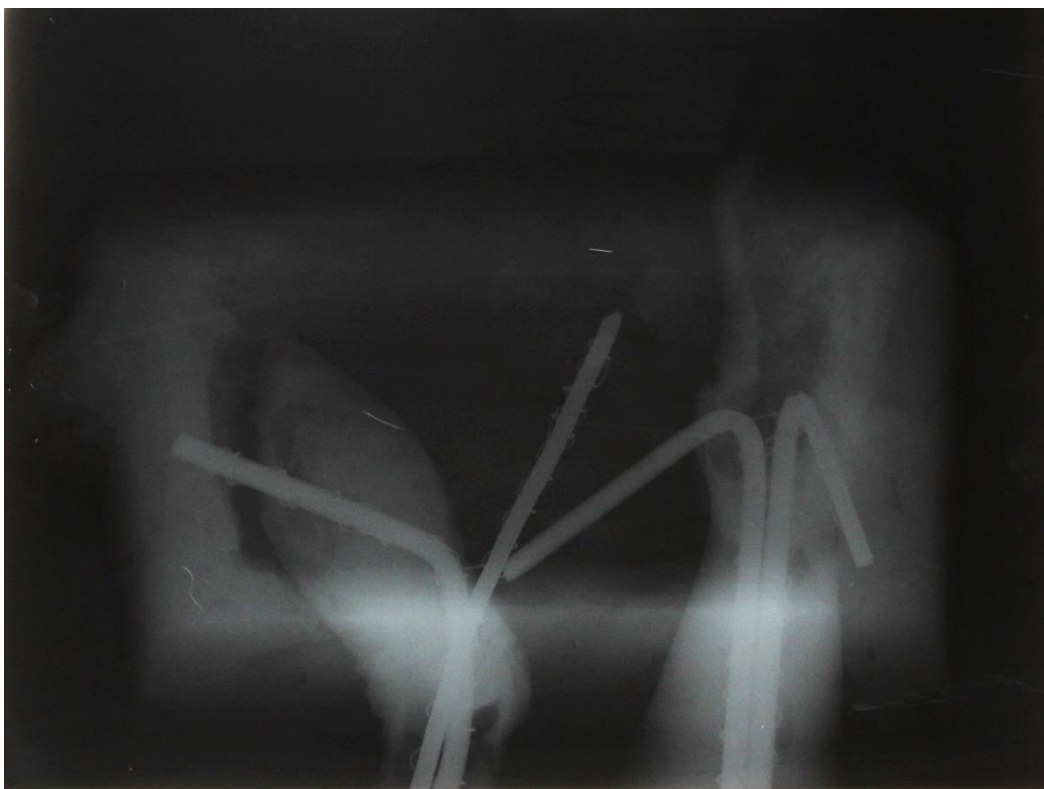
RTG snímek dokumentující kovovou armaturu v obou dolních končetinách a soklu
