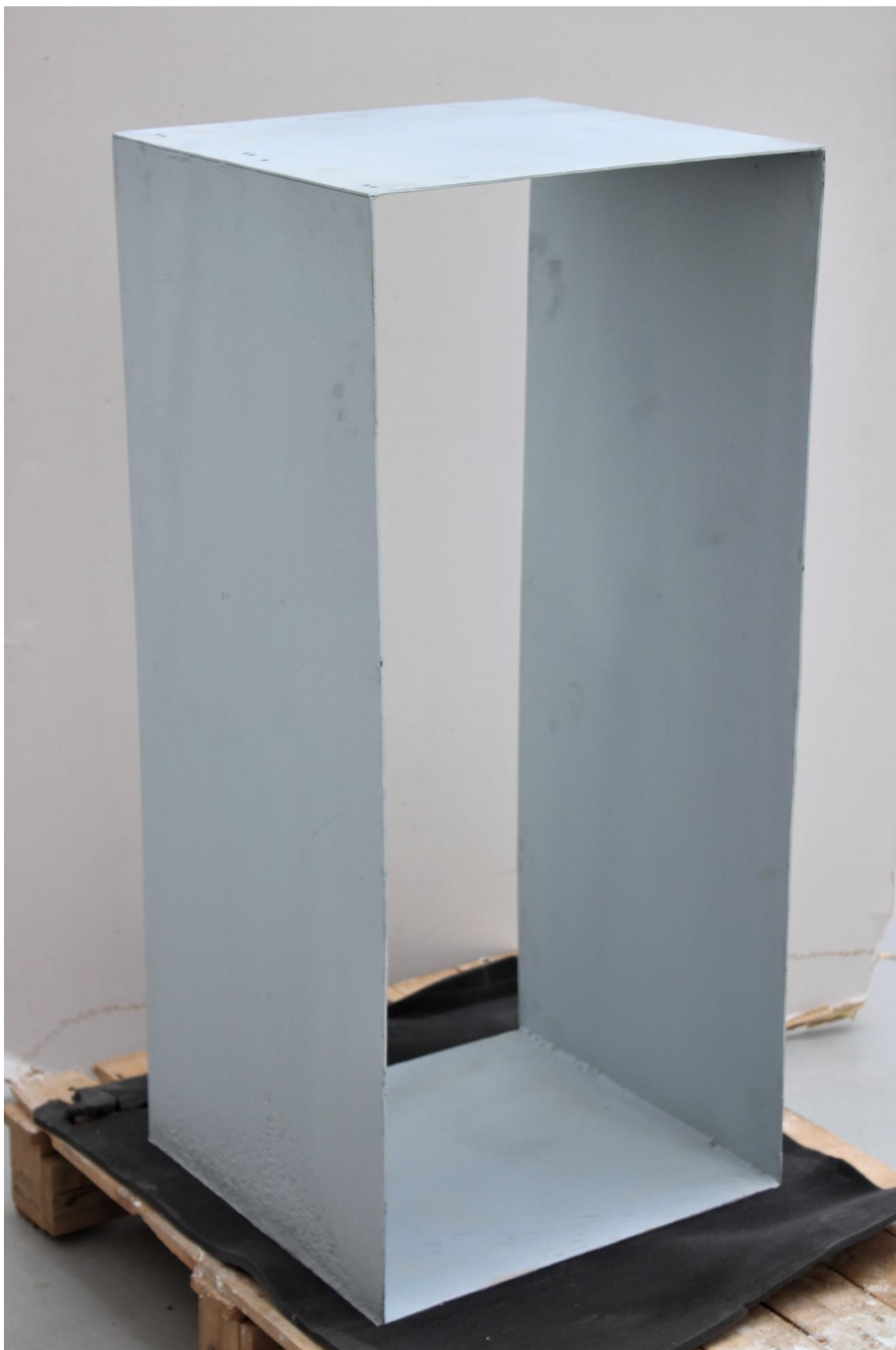
Obr. č. 30. Podstavec po pískování a zinkování
