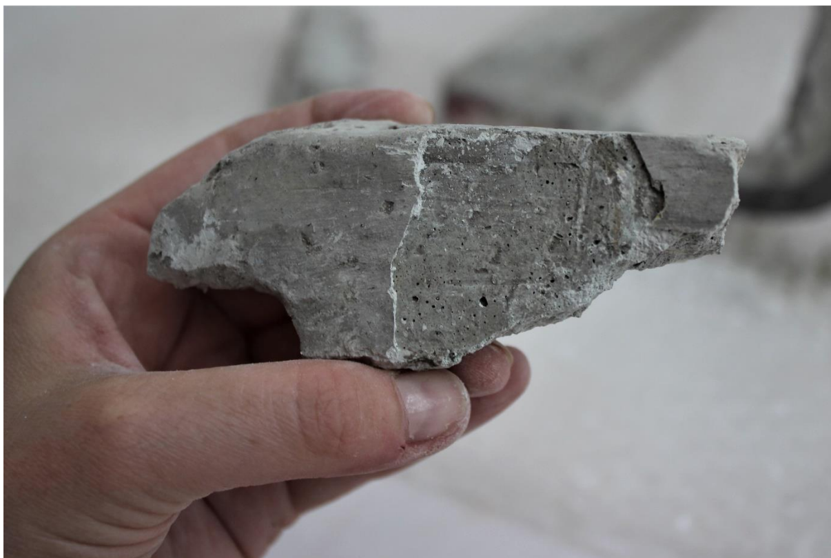
Obr. č. 39. Průběh mechanického snímání sádrové vrstvy z odlomené části překážky
