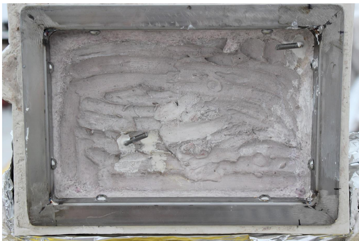
Obr. č. 65. Vložení nerezových armatur do dolních končetin
