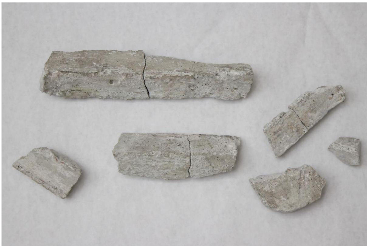
Obr. č. 44. Lepení očištěných fragmentů spodní části překážky
