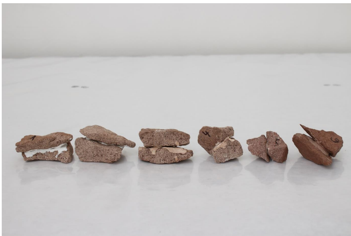
Obr. č. 40. Zkoušky pevnosti minerálních drtí s KSE Remmers
