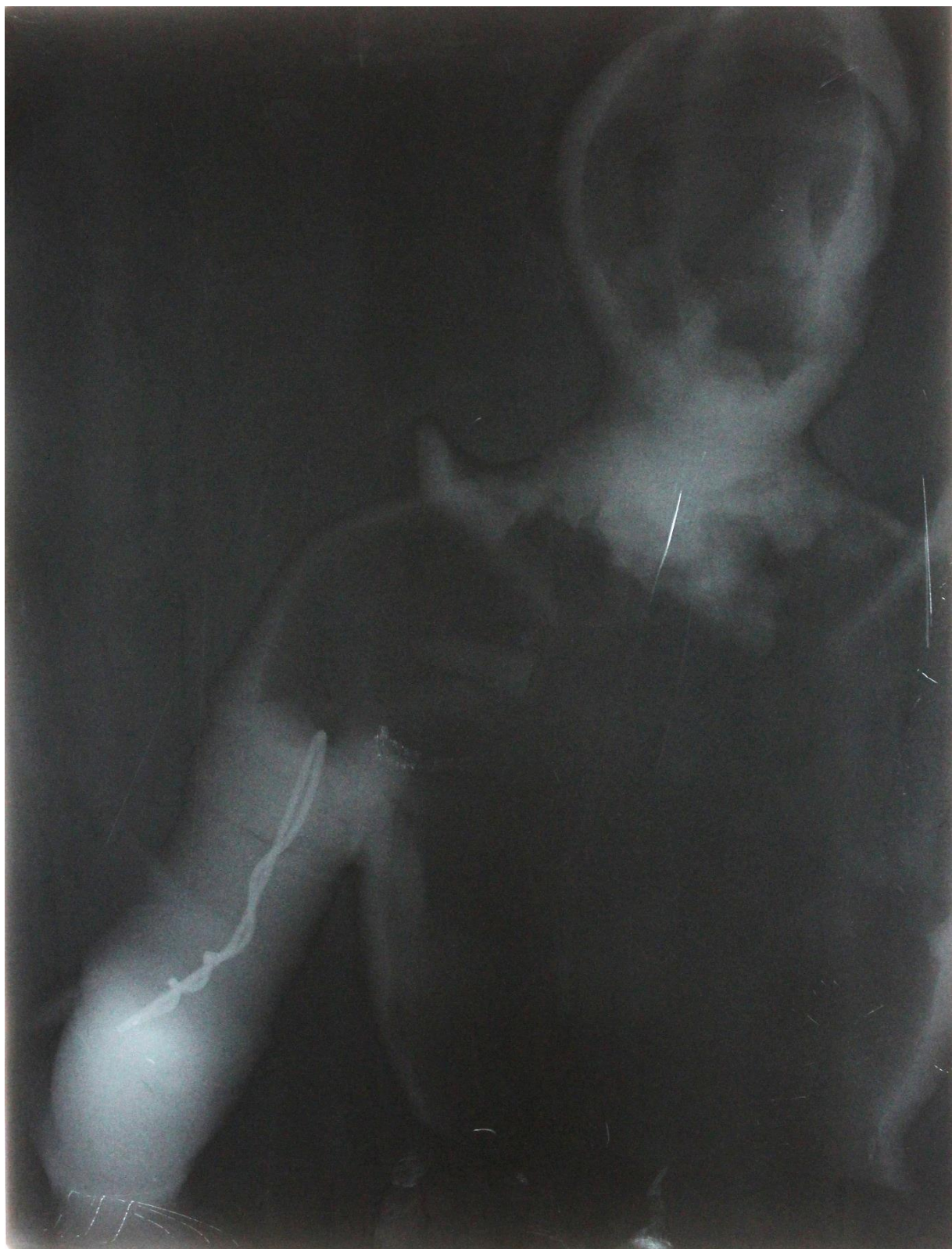
RTG snímek dokumentující kovovou armaturu v pravé ruce
