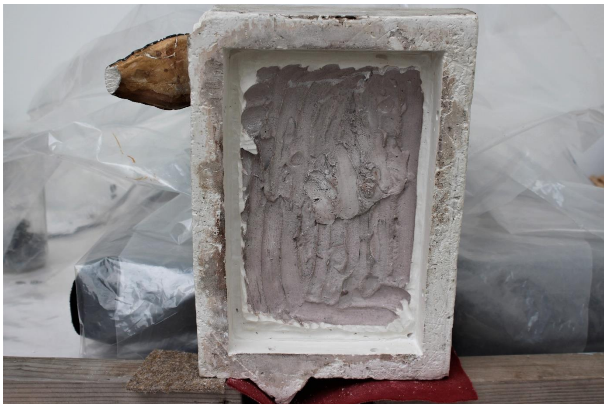
Obr. č. 55. Vytvoření prostoru pro nerezový rámeček
