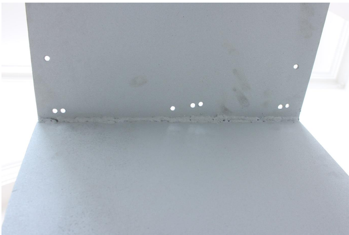
Obr. č. 32. Podstavec po pískování a zinkování
