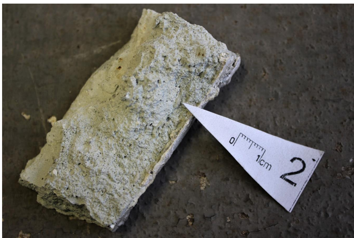
Místo odběru vzorku č. 2. – zadní strana překážky, vnitřní strana odlomené části – lepidlo
