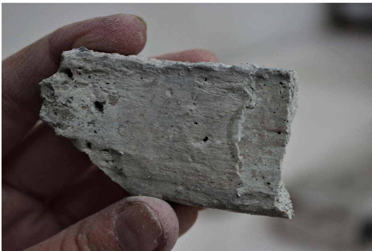
Obr. č. 40. Průběh mechanického snímání sádrové vrstvy z odlomené části překážky
