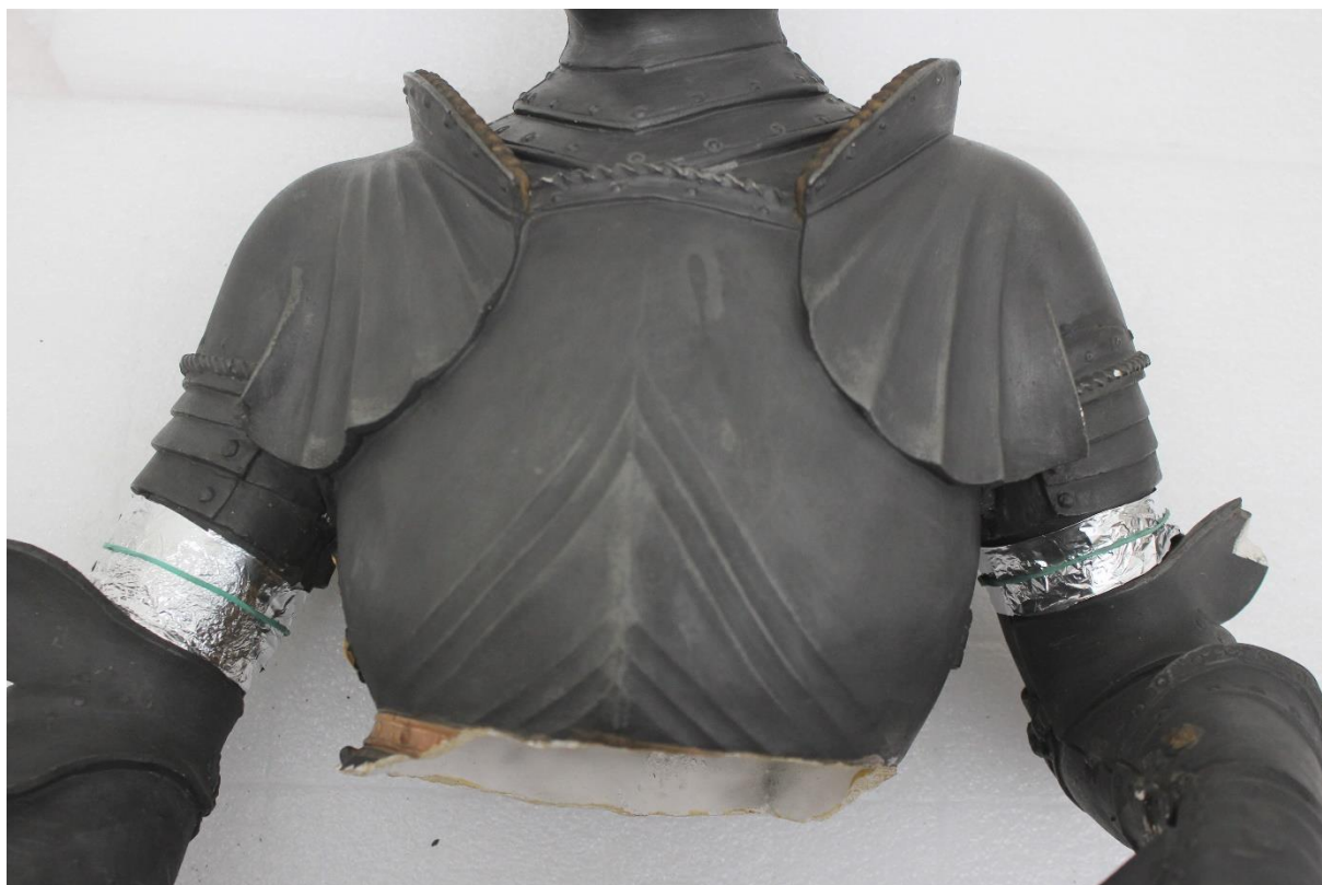
Obr. č. 39. Aluminiová fólie jako separační vrstva pod sádrové lůžko
