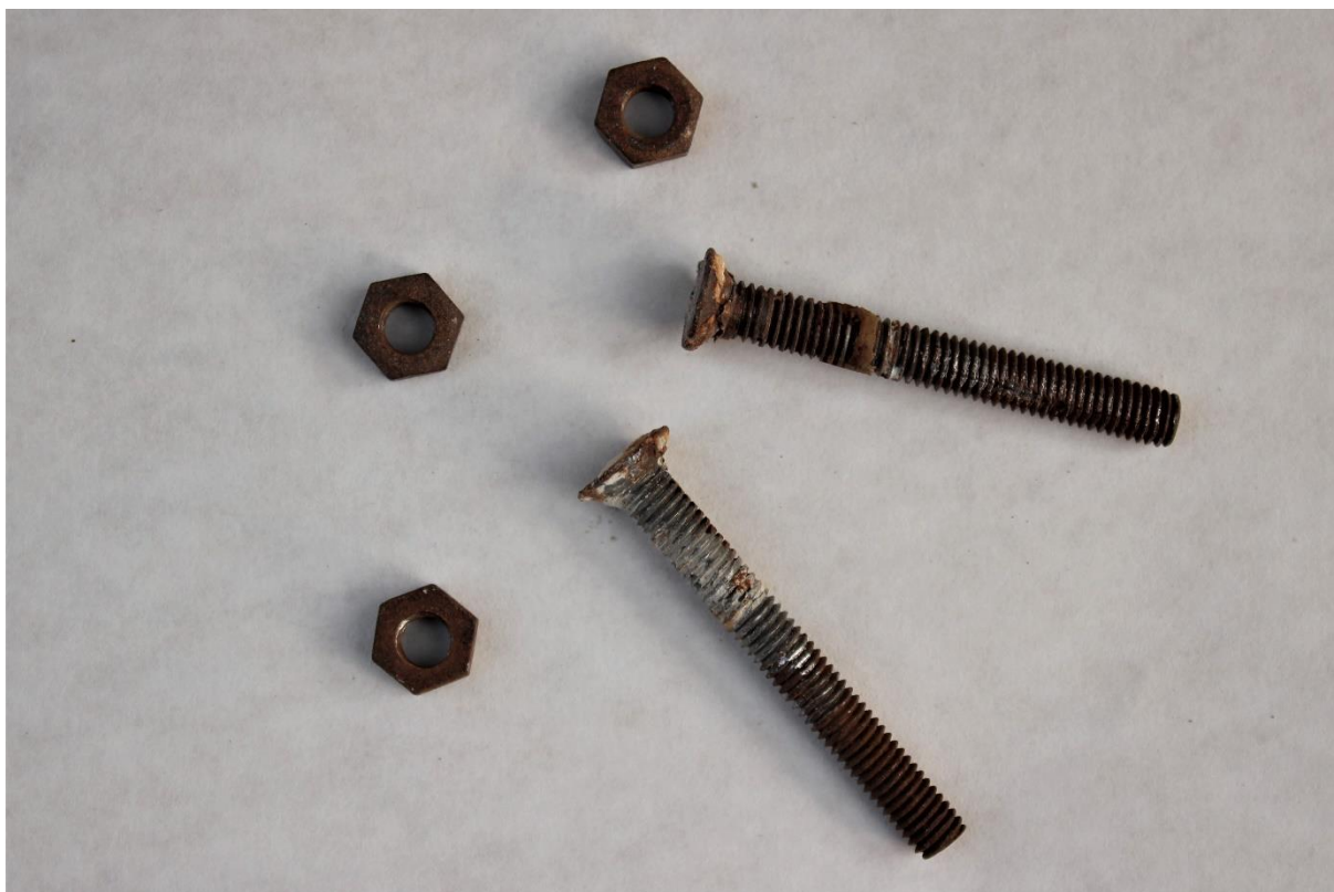
Obr. č. 35. Neošetřené šrouby z vnitřní armatury překážky
