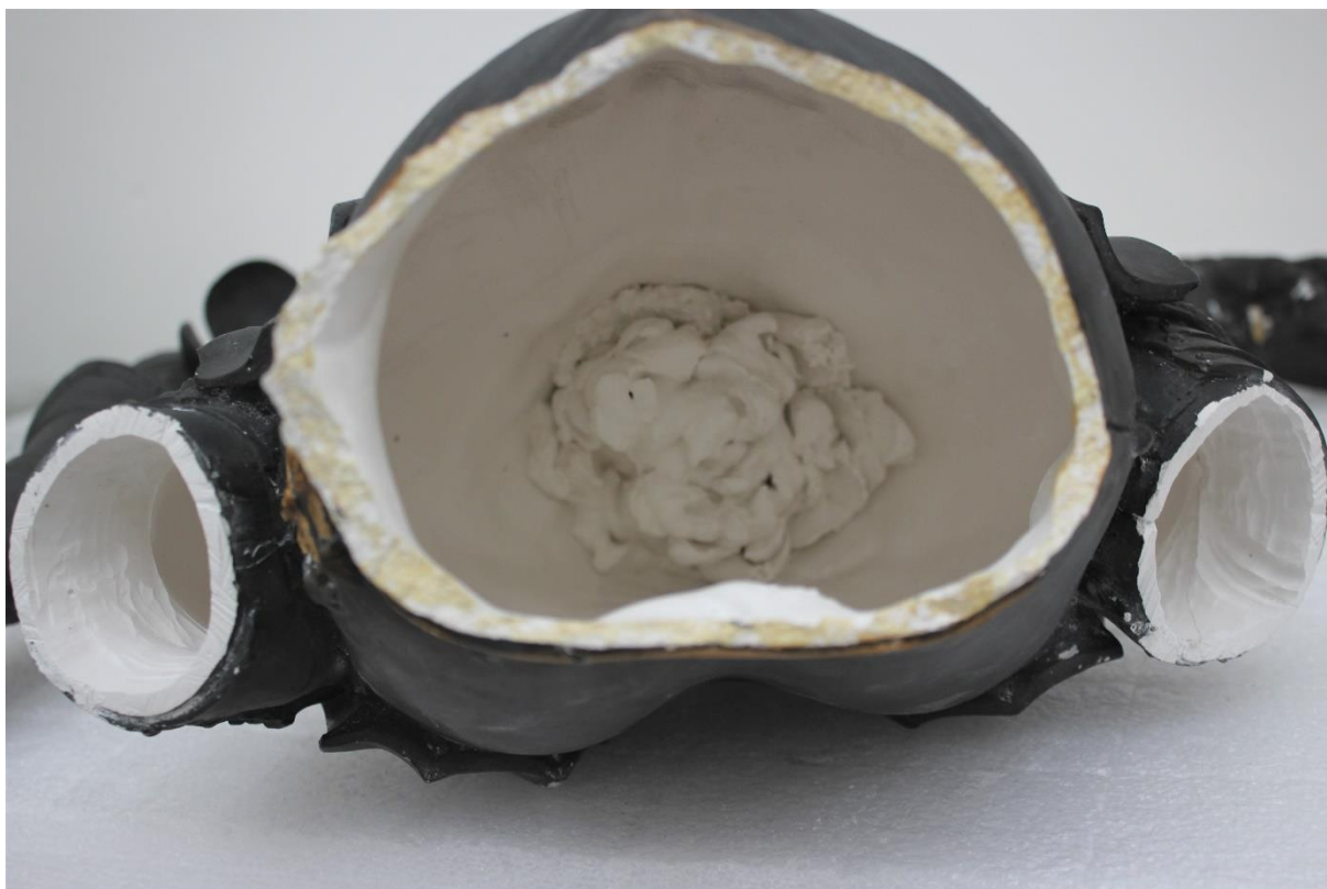
Obr. č. 43. Odfrézování vnitřního sádrového materiálu z paží
