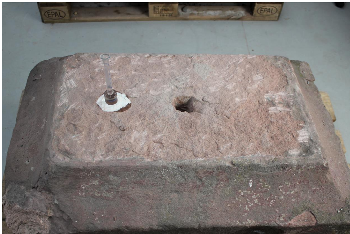
Obr. č. 24. Měření nasákavosti materiálu Karstenovou trubicí
