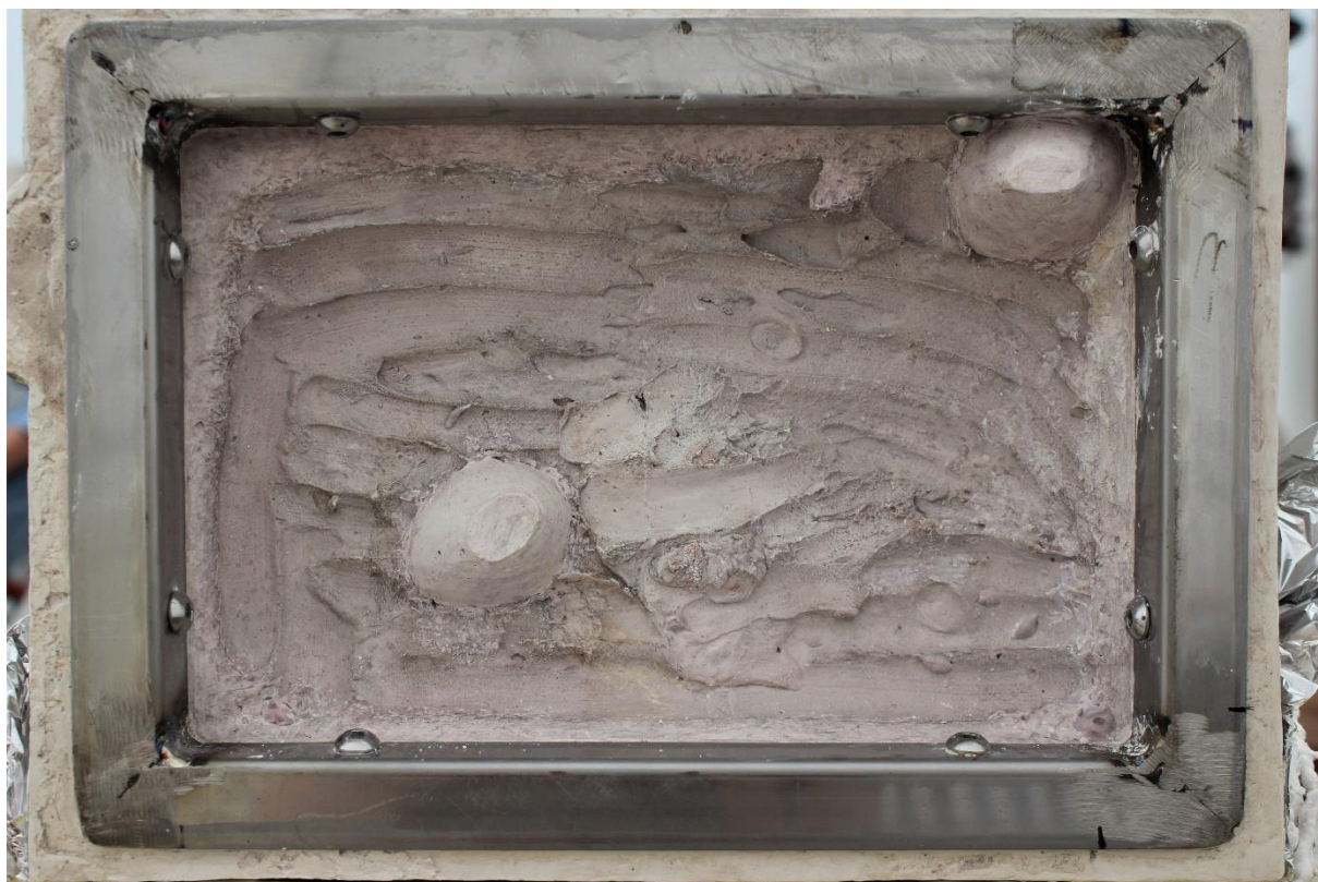
Obr. č. 66. Vytvoření sádrové ochrany na nerezové armatury
