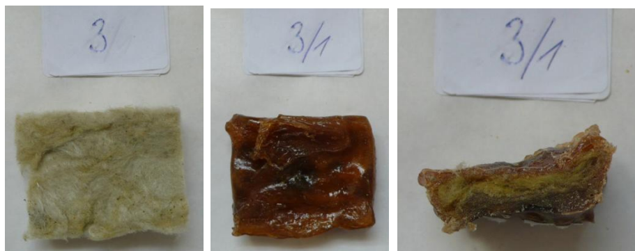
Vzorek č. 3; 3/1 Minerální vata ISOVER UNI bez nátěru a s nátěrem Revultexu MR
