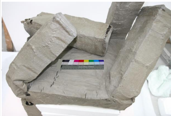
Obr. č. 3 až 5 Snímek v denním světle, ukázky poškození – degradace obou materiálů, úbytek hmoty Molitanu a praskliny v Revultexu
