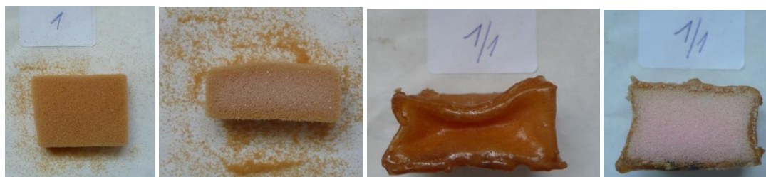
Vzorek č. 1; 1/1 PUR pěna RX 46065 bez nátěru a s nátěrem Revultexu MR
