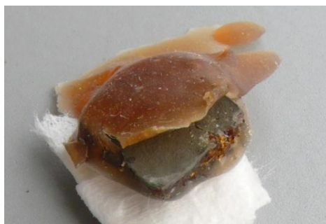
Obr. č. 12 Na původní vrstvě Revultexu je nanesena nová vrstva Revultexu MR
