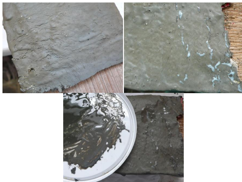
Detail poškození Revultexu Tmelení pomocí lepidla Kleberit Kontaktkleber 410.2
