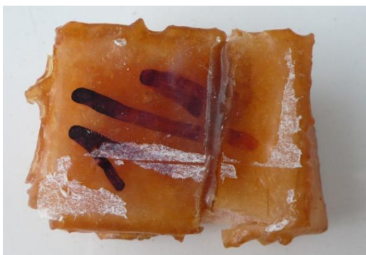
Obr. č. 11 Řez v degradovaném vzorku č. 1/1 doplněný a spojený novým Revultexem MR
