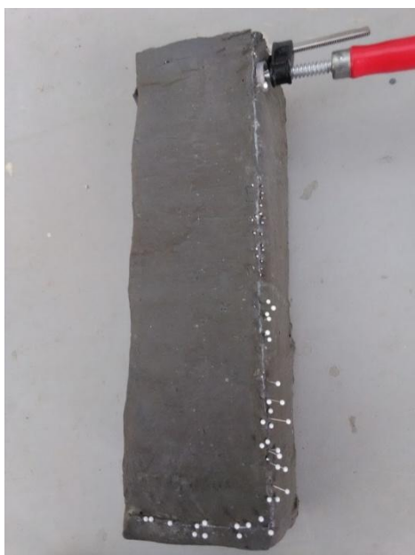
c) a d) Lepení sekundárních řezů nohy a ukázka kotvení sekundárních řezů
