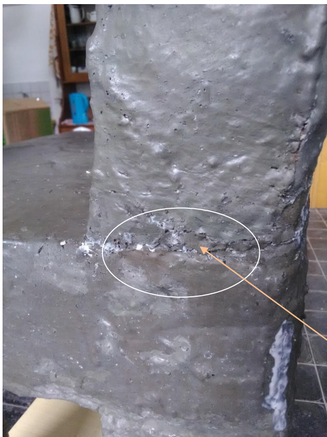
Obr. č. 110 a, b, c Ukázky postupu doplňování hmoty a tmelení
