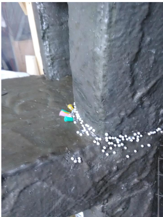
Obr. č. 107 Detail lepení spoje opěradla k sedací části
