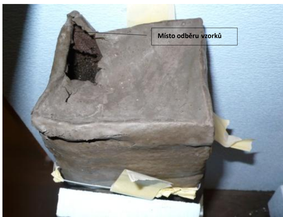
Obr. č. 17 Noha židle, označení místa odběru vzorků
