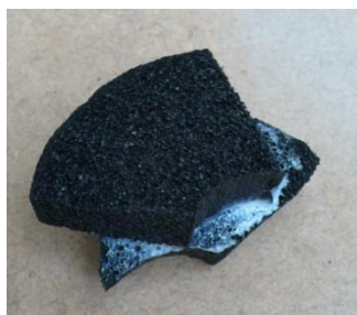
Obr. č. 62 Lepení syntetického kaučuku syntetického kaučuku Kaiflex EPDM navzájem
