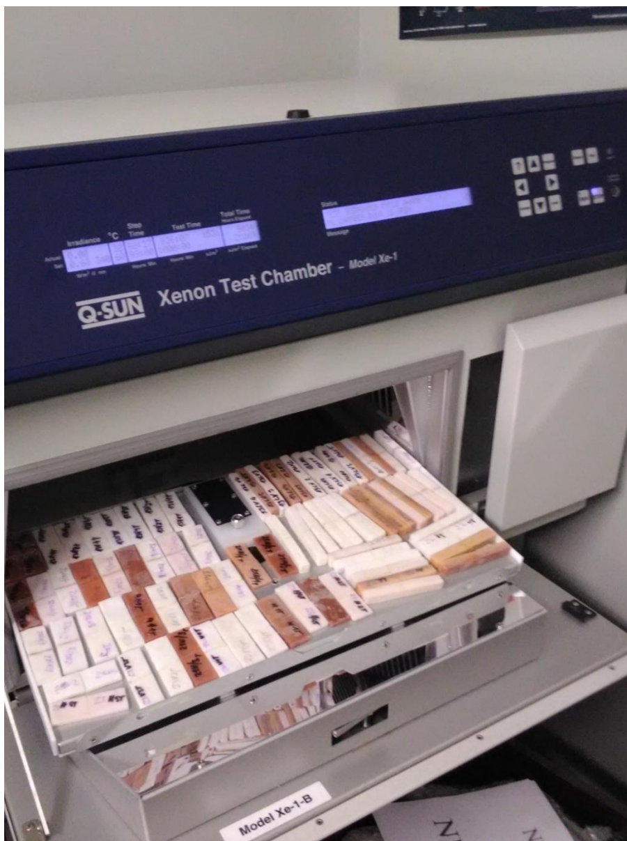
Obr. č. 59 Příprava vzorků pro testování barevných změn
