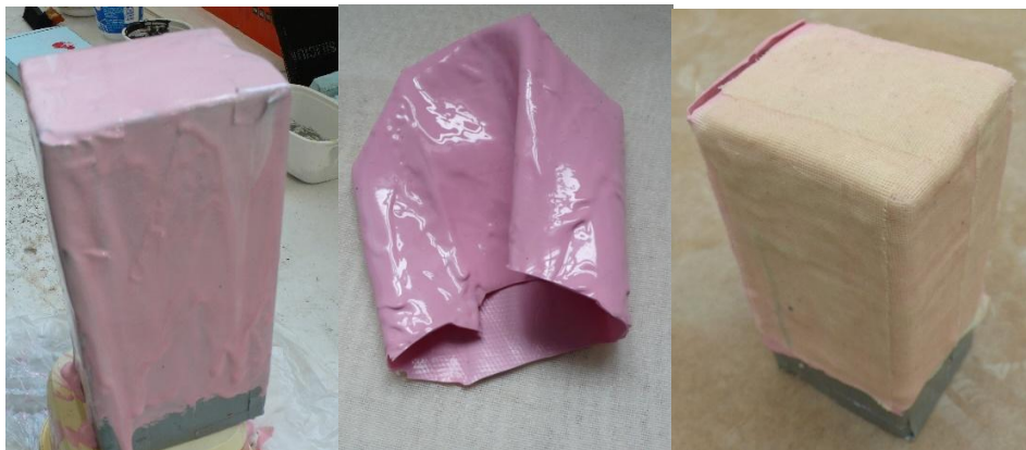
Obr. č. 79 Zhotovení pláště z ACC silikonu
