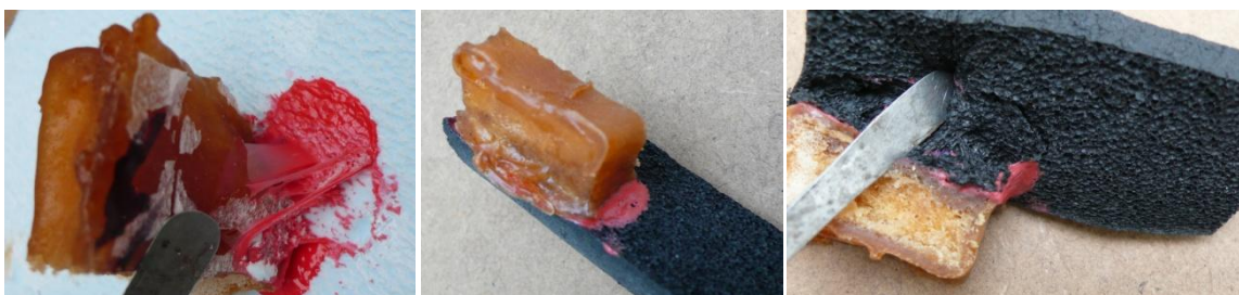
a Lepení Revultexu b, c Revultexu k syntetického kaučuku Armaflex HT k extrudovanému polystyrenu XPS
