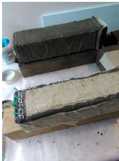
b) Ukázka fixace sekundárních řezů včetně pomocné bandáže
