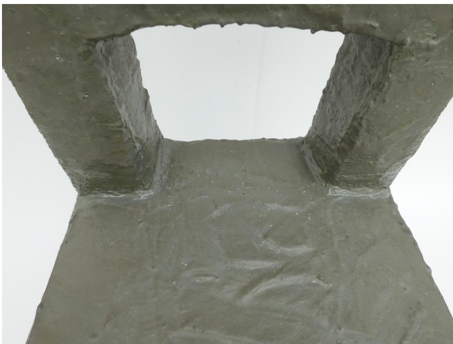
Obr. č. 116 Konečné retuše prasklin opěradla a spojů opěradla a sedací části
