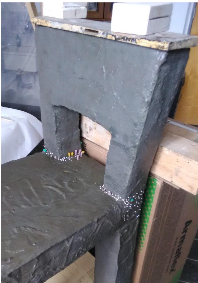
Obr. č. 105 Lepení opěradla k sedací části
