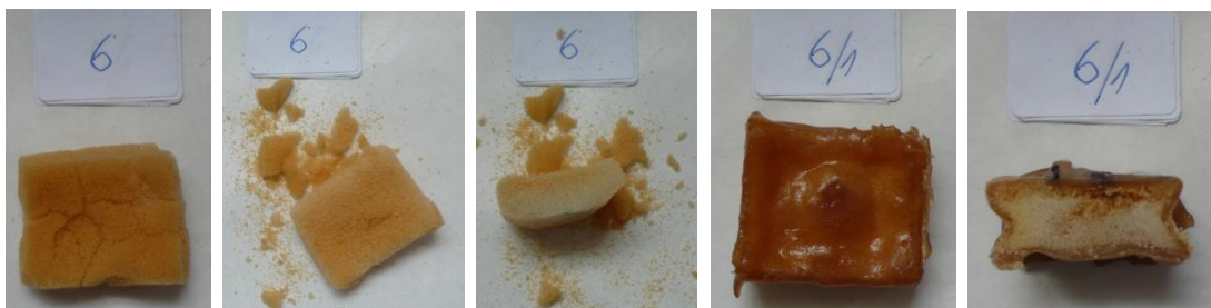
Vzorek č. 6; 6/1 PUR studená pěna R 4040 bez nátěru a s nátěrem Revultexu MR
