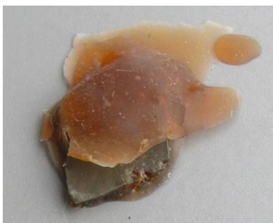
Obr. č. 12 Na původní vrstvě Revultexu je nanesena nová vrstva Revultexu MR
