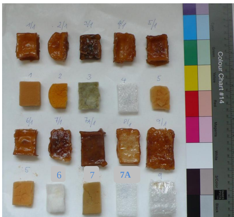
Obr. č. 8 Vzorky po testu – barevné změny
