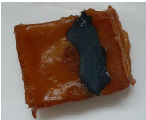
Obr. č. 10 Nanesený barvený Revultex na vzorek vyjmutý z komory po 23 dnech
