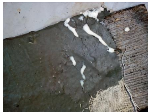
Obr. č. 69 Test tmelení přírodním kaučukem Revultexem, po zaschnutí nebyl materiál soudržný
