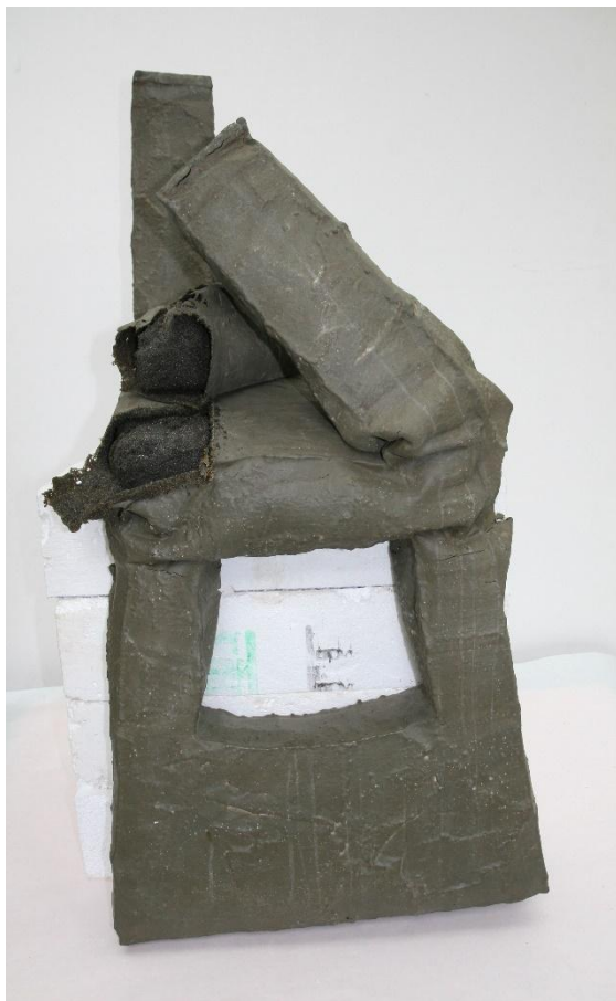
Obr. č. 3 až 5 Snímek v denním světle, ukázky poškození – degradace obou materiálů, úbytek hmoty Molitanu a praskliny v Revultexu
