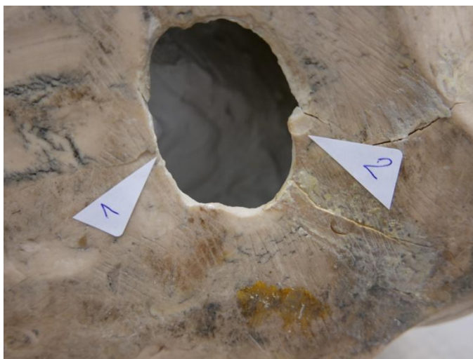
Obr. č. 52 Vzorek č. 2 Test na určení hmoty lokálně zpevňující sádrové jádro
