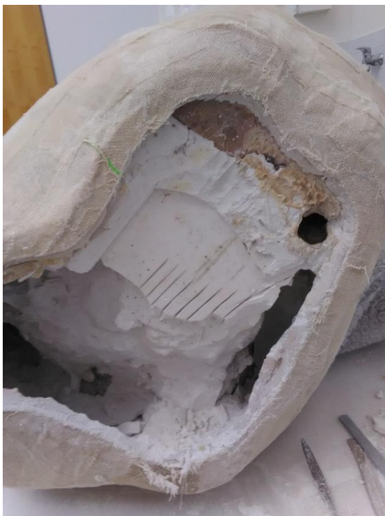
Obr. č. 91 a 92 Postupné obrušování odkrytého sádrového jádra
