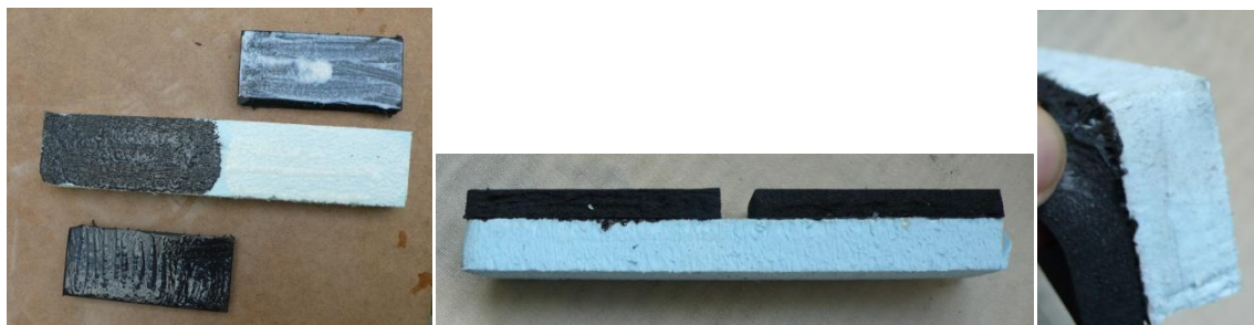
Obr. č. 61 Lepení syntetického kaučuku Kaiflex EPDM k extrudovanému polystyrenu
