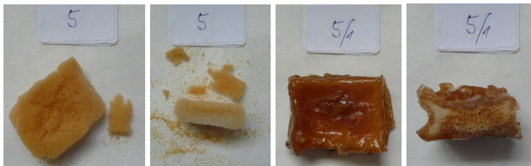
Vzorek č. 5; 5/1 PUR studená pěna N 3050 bez nátěru a s nátěrem Revultexu MR
