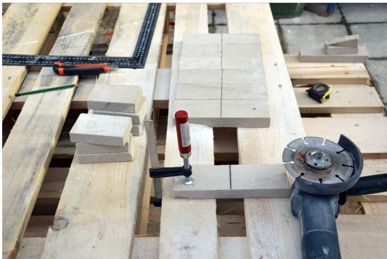
Formátování pískovcových desek na vzorky
