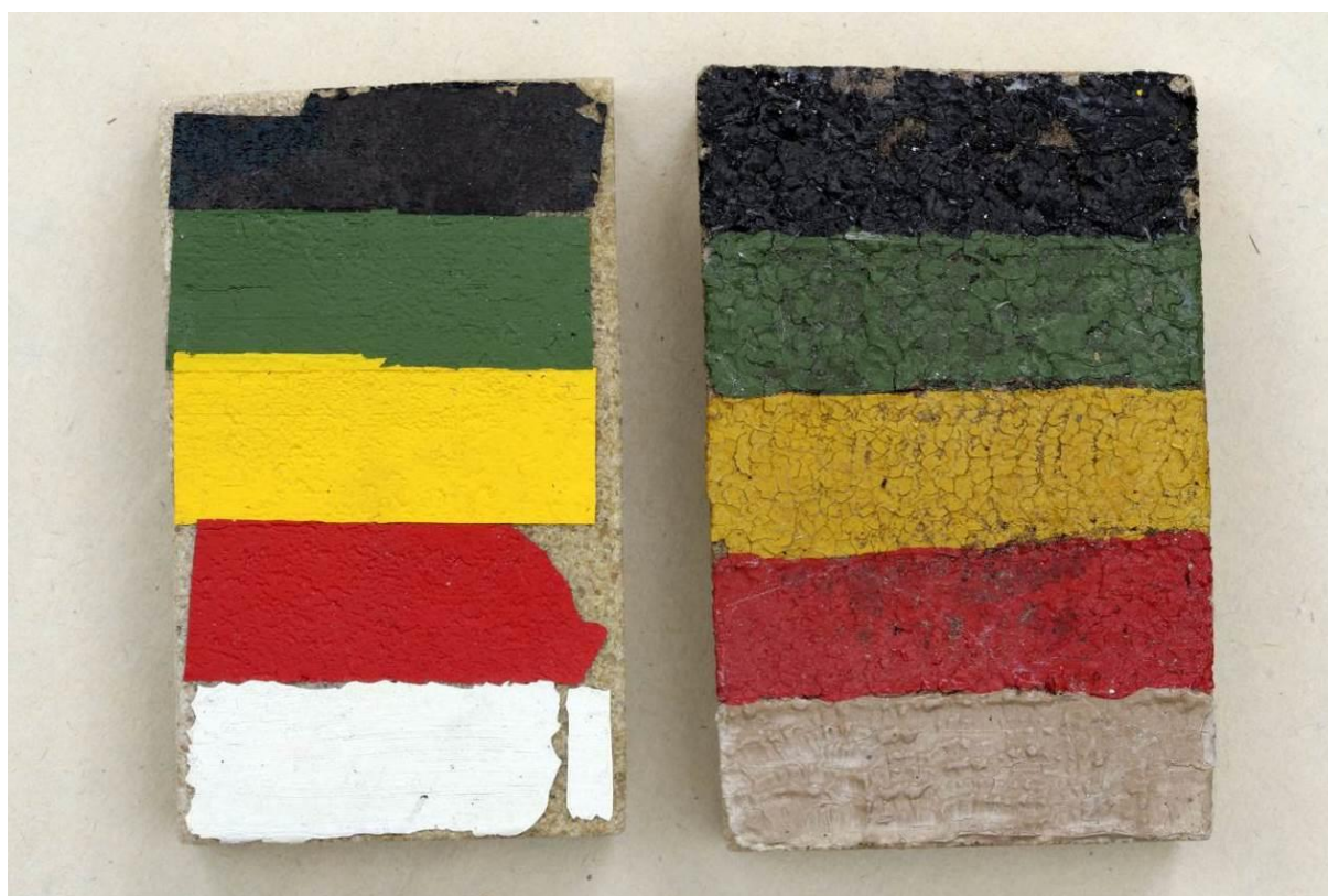
Po namáhání v klimatické komoře
