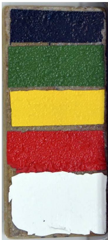
Před namáháním v klimatické komoře
