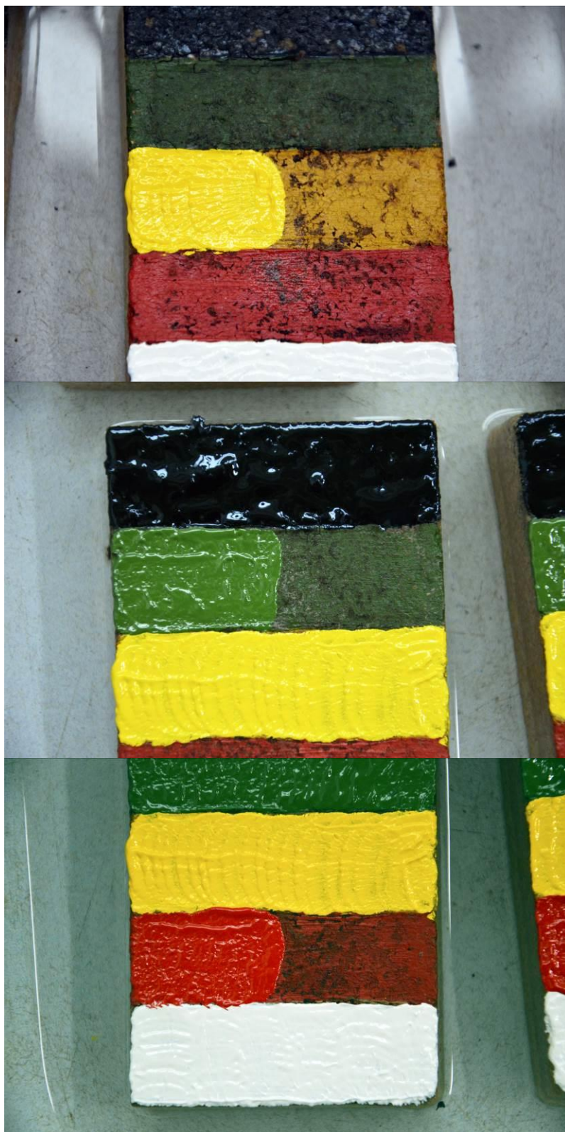
Rozdílnost barevných odstínů nové a staré olejové vrstvy (kadmium žluté střední, chromoxid tupý, kadmium červené tmavé)
