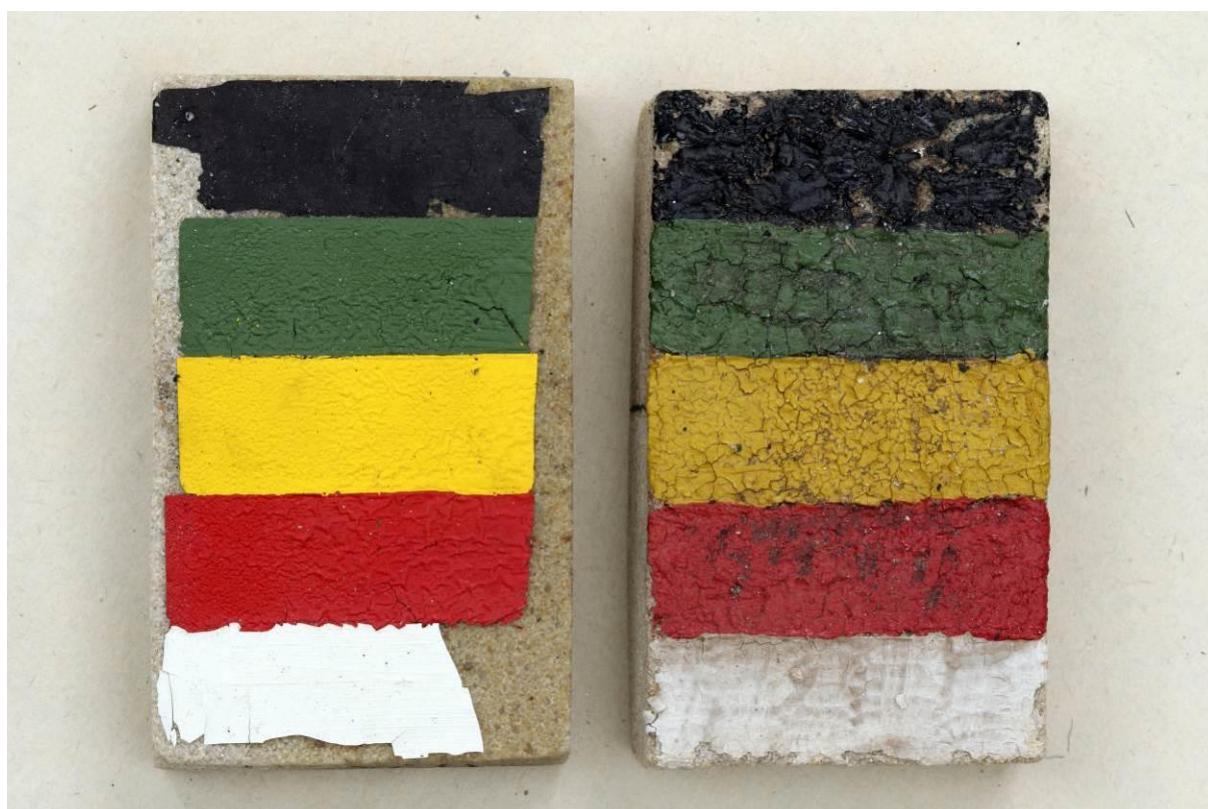
Po namáhání v klimatické komoře
