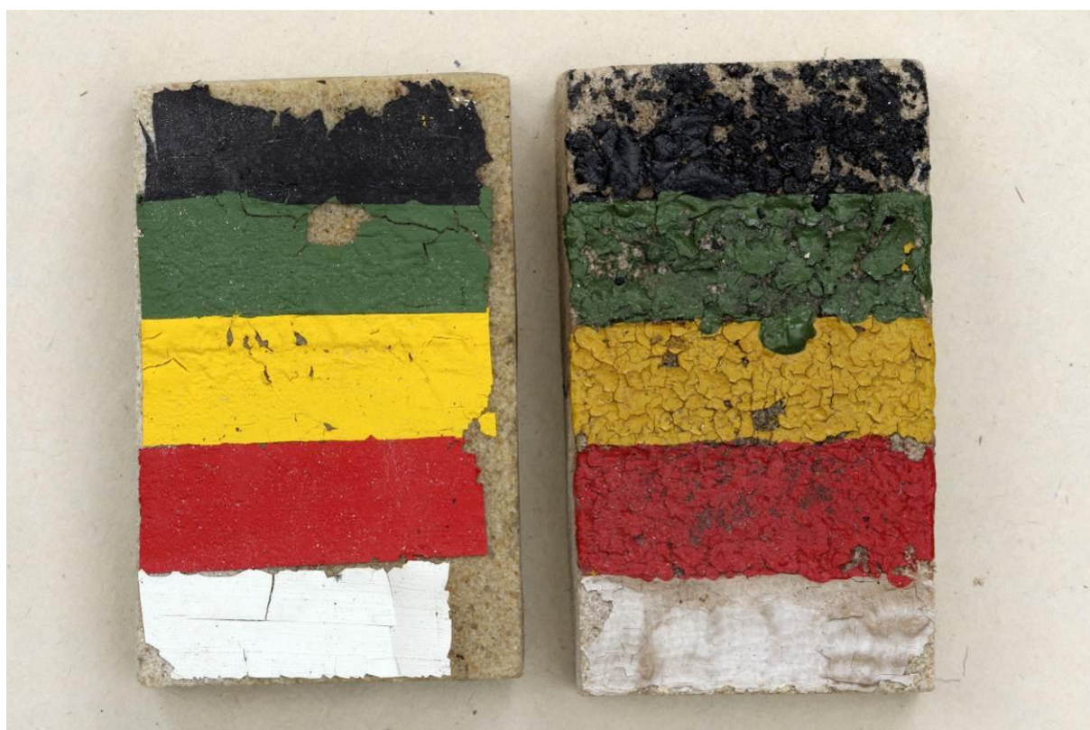
Po namáhání v klimatické komoře
