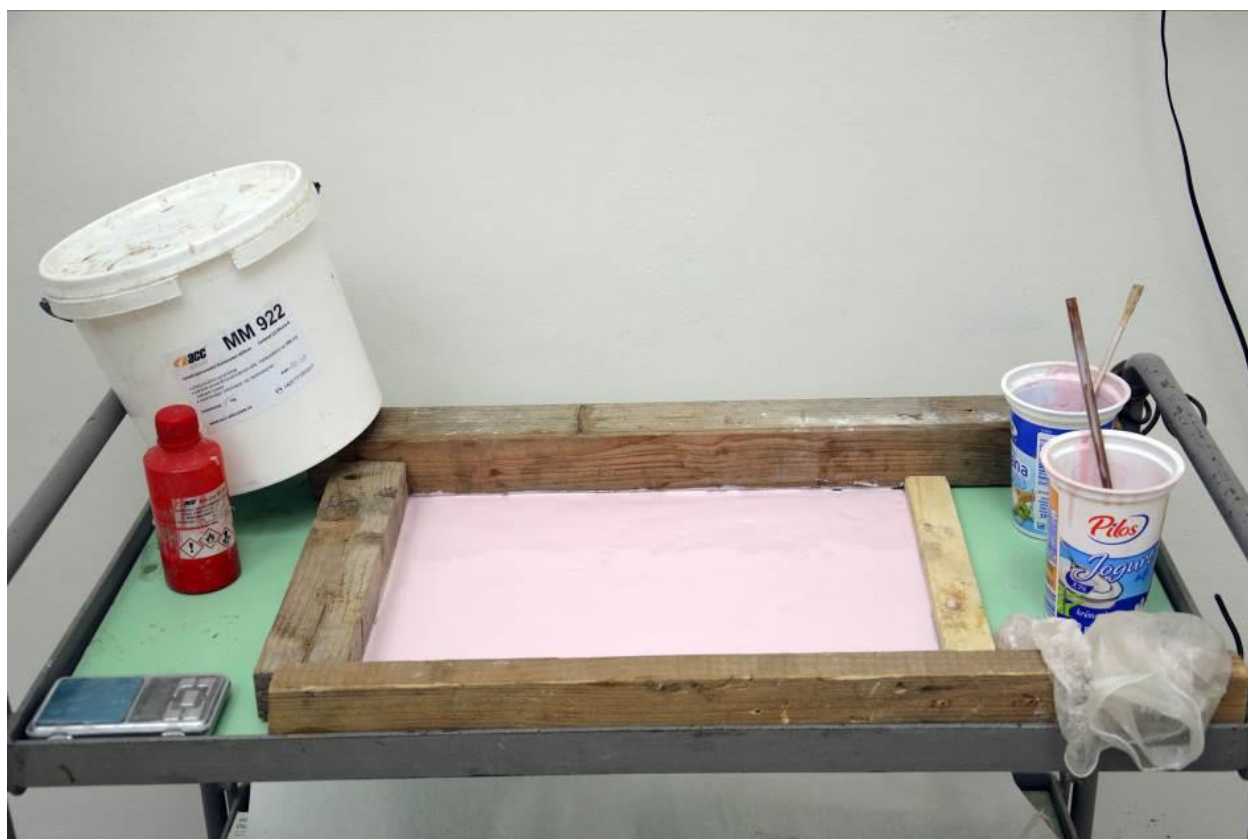
Vytváření silikonové podložky
