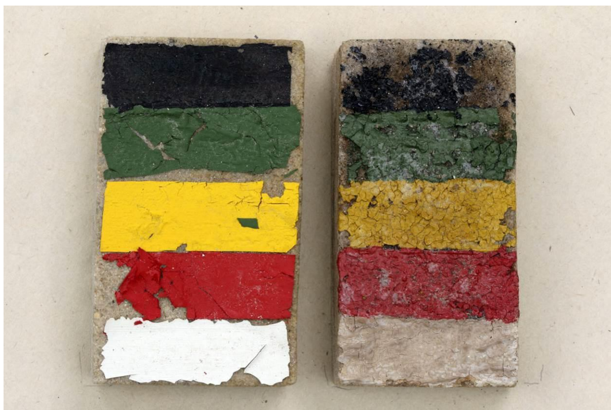
Po namáhání v klimatické komoře
