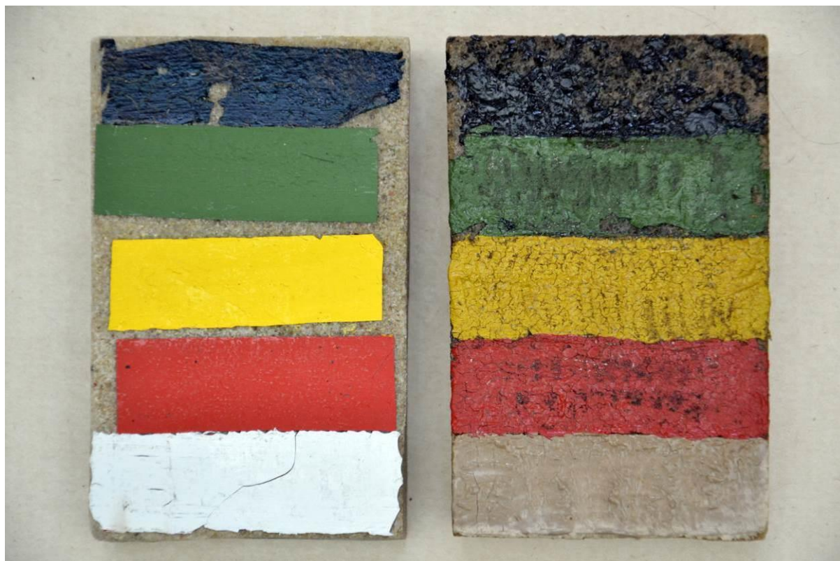
Před namáháním v klimatické komoře
