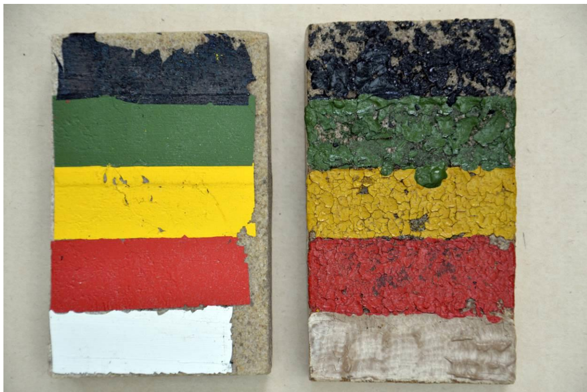
Před namáháním v klimatické komoře
