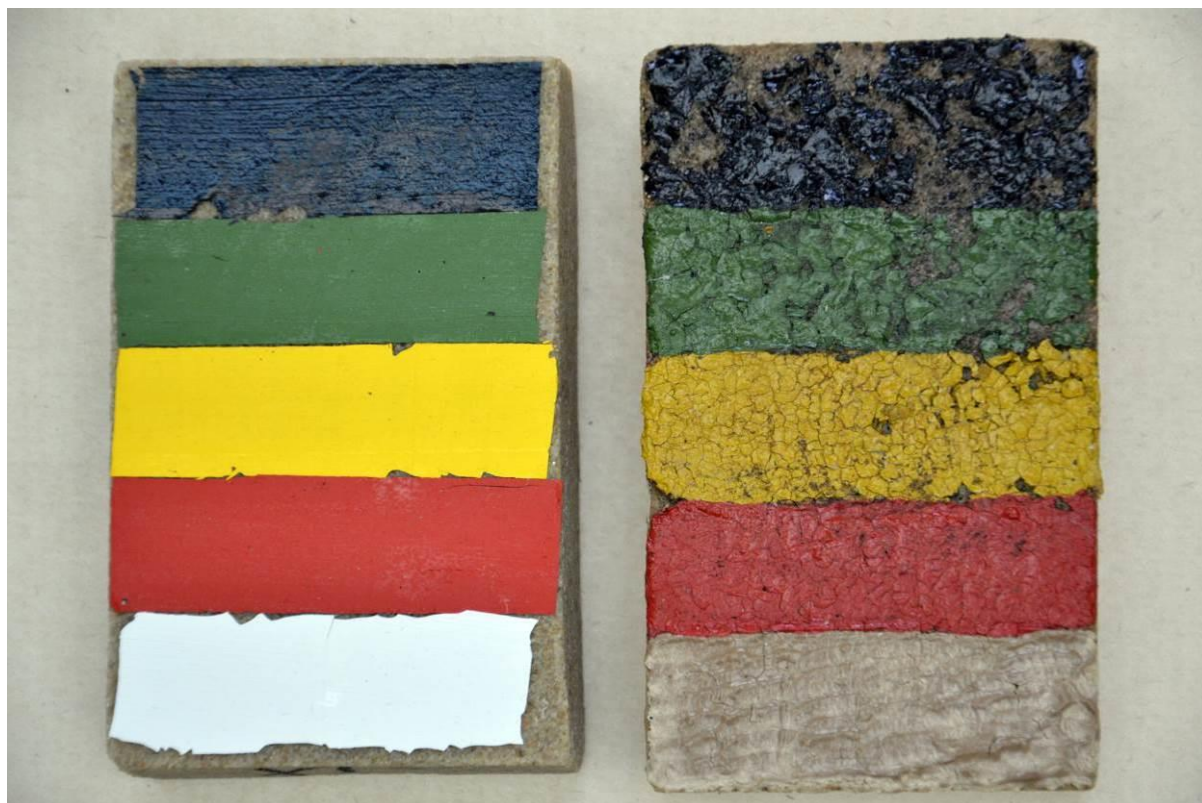
Před namáháním v klimatické komoře
