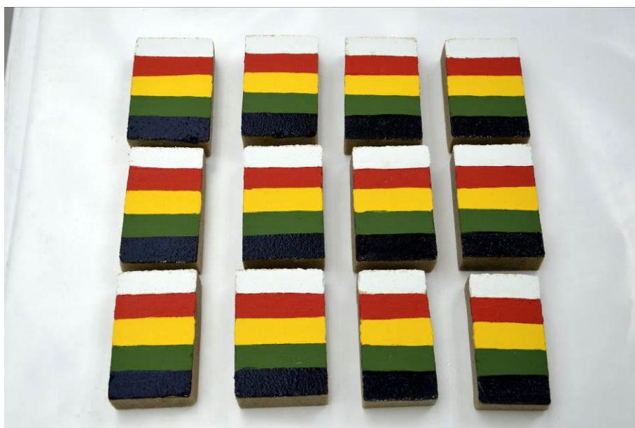
Kamenné vzorky natřené olejovými barvami
