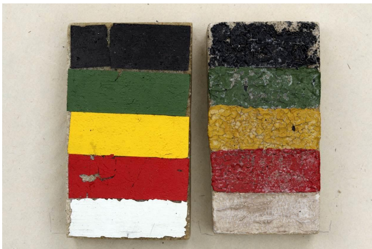
Po namáhání v klimatické komoře
