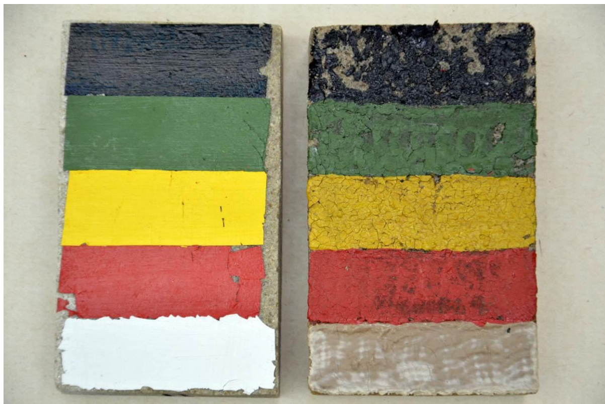
Před namáháním v klimatické komoře
