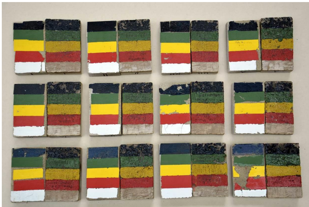
1. a 2. skupina zkušebních těles po upevnění olejových filmů adhezivy ke kamennému podkladu (vždy levý vzorek – nalepený film, pravý vzorek – upevněná krakeláž)
