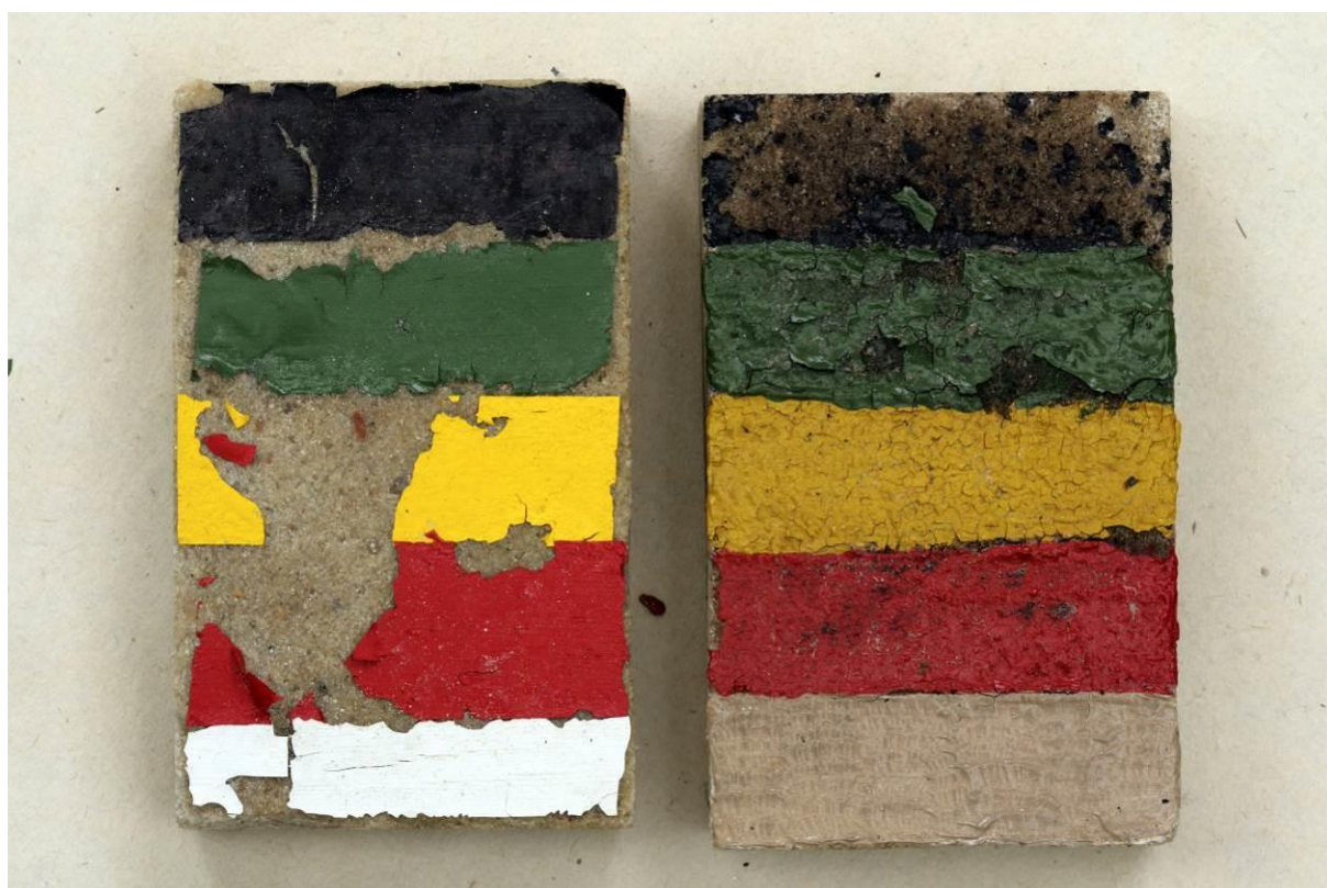
Po namáhání v klimatické komoře
