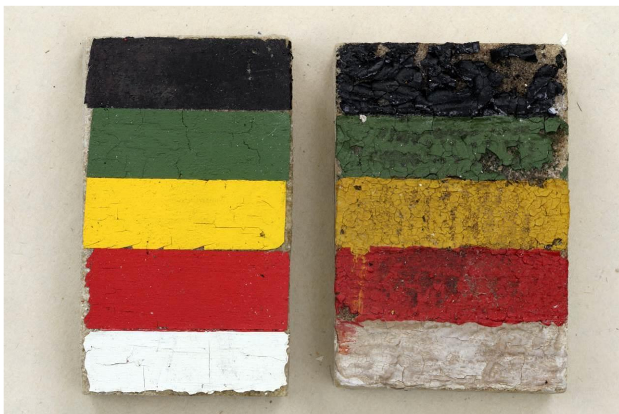
Po namáhání v klimatické komoře
