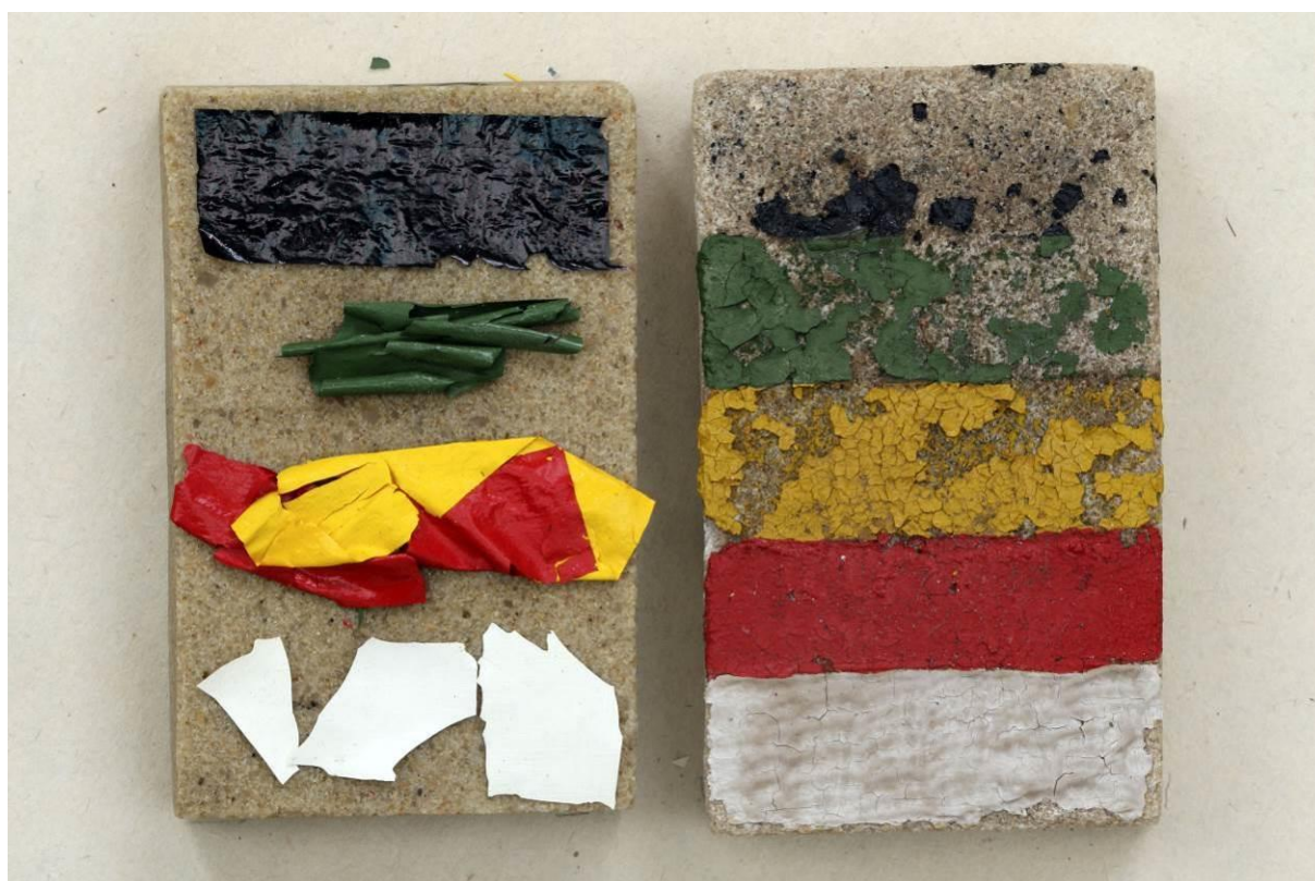
Po namáhání v klimatické komoře
