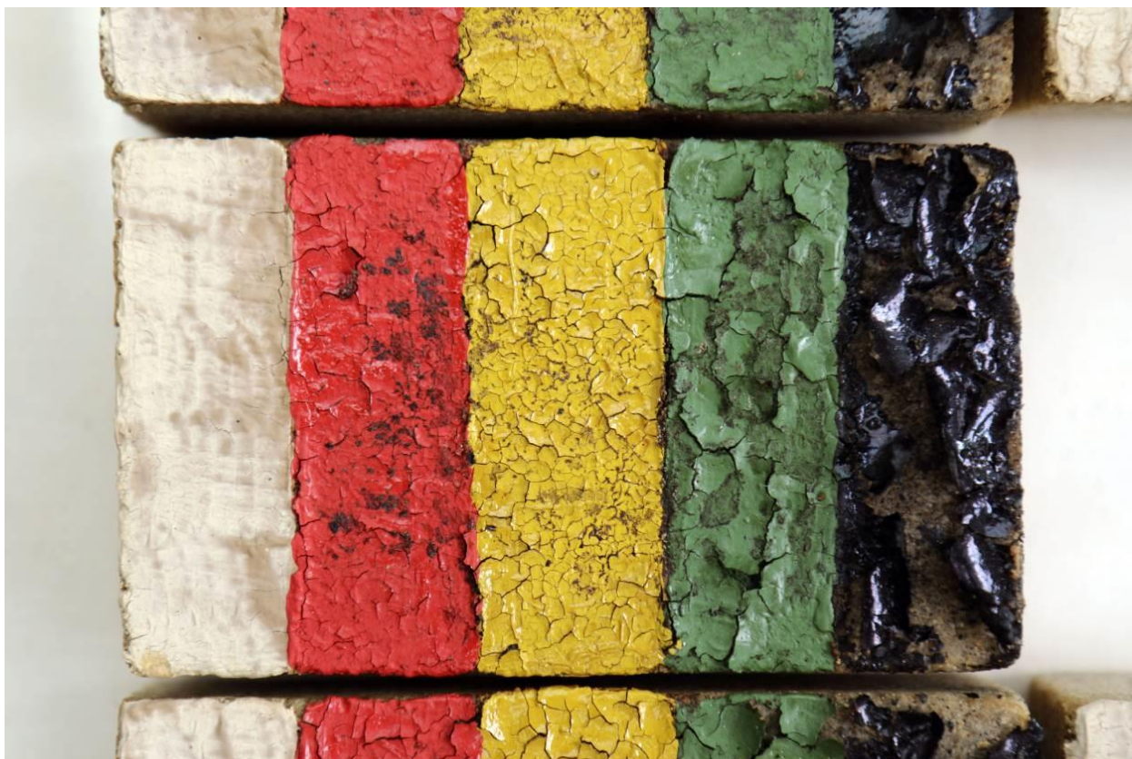
Detail degradovaných olejových vrstev po namáhání tepelnými šoky
