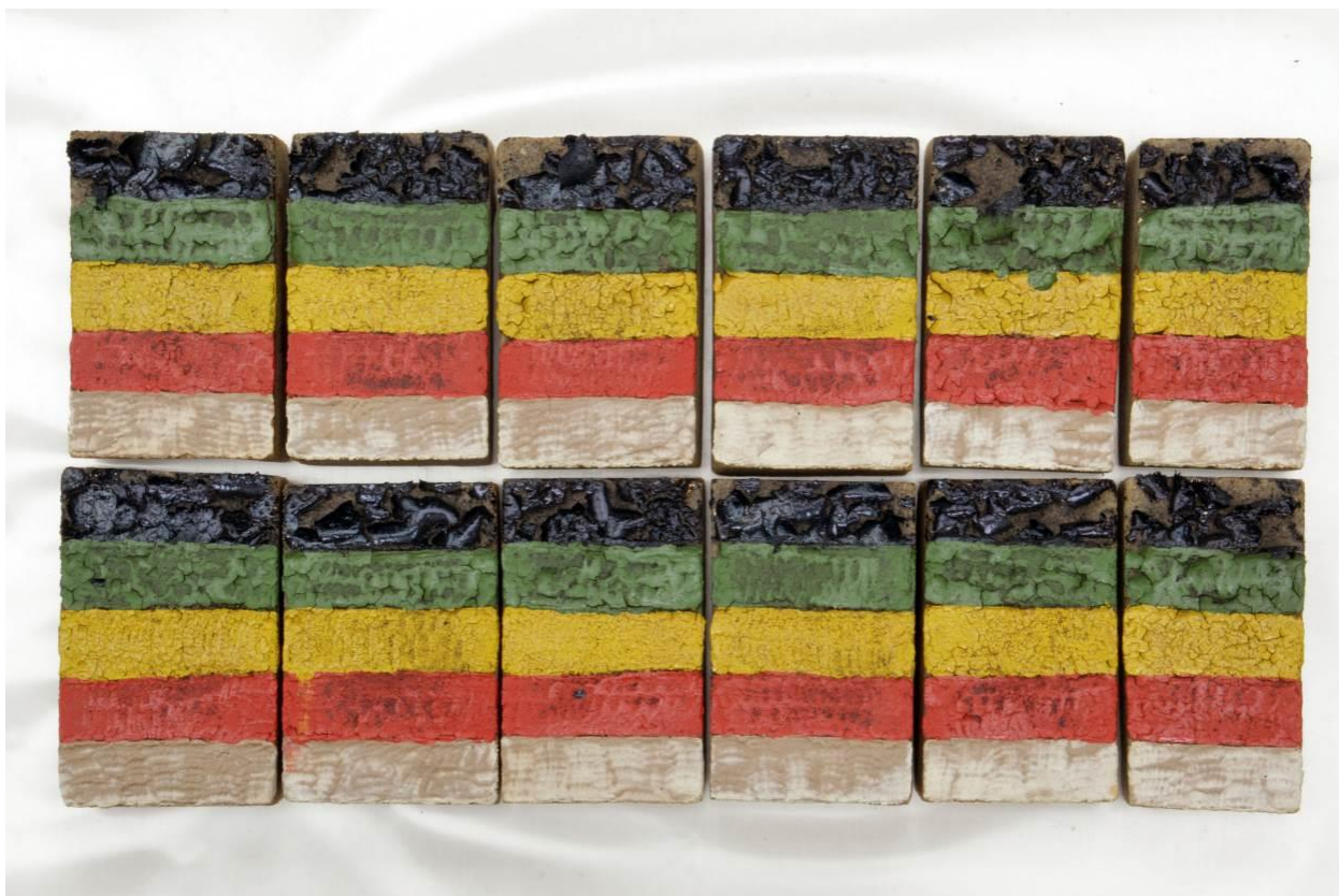
Degradované olejové vrstvy po namáhání tepelnými šoky, vzorky připravené k upevňování adhezivy
