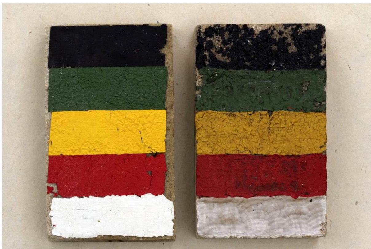
Po namáhání v klimatické komoře
