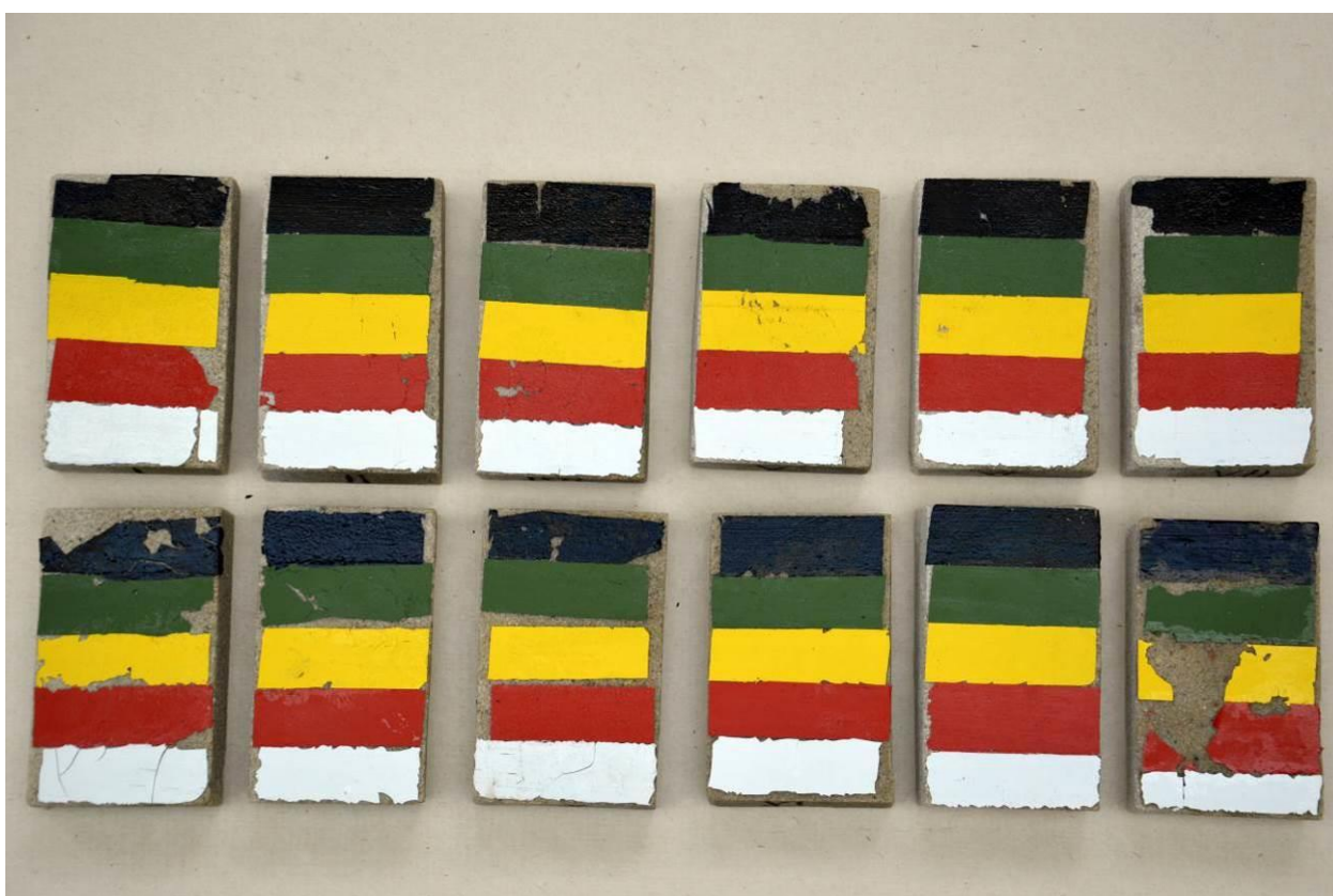
Upevněné olejové filmy adhezivy na kamenné vzorky
