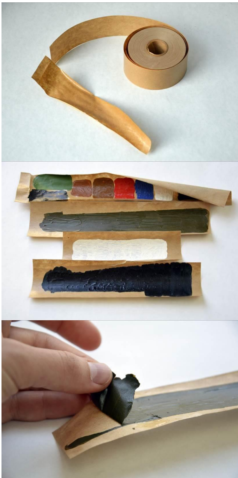
Samostatná klišová lepenka a klišová lepenka podpořená dodatečným nátěrem kožního klišu
