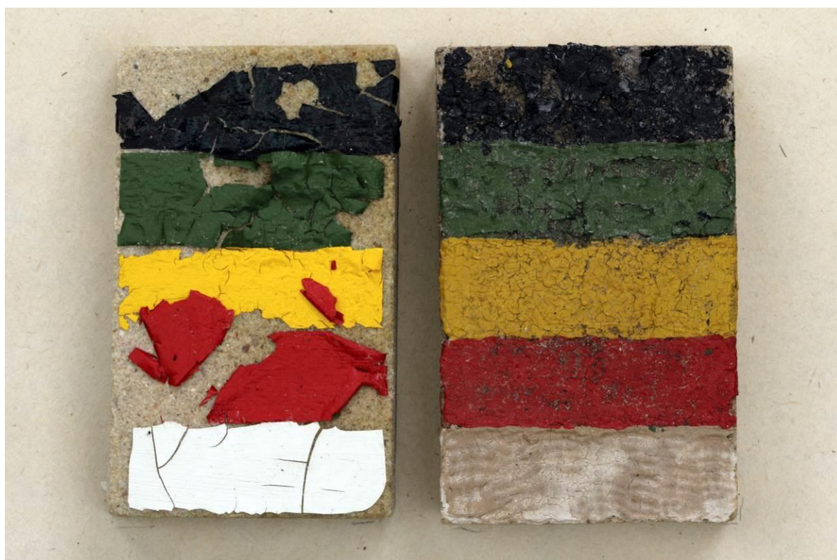
Po namáhání v klimatické komoře
