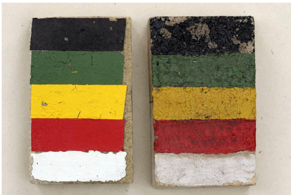
Po namáhání v klimatické komoře
