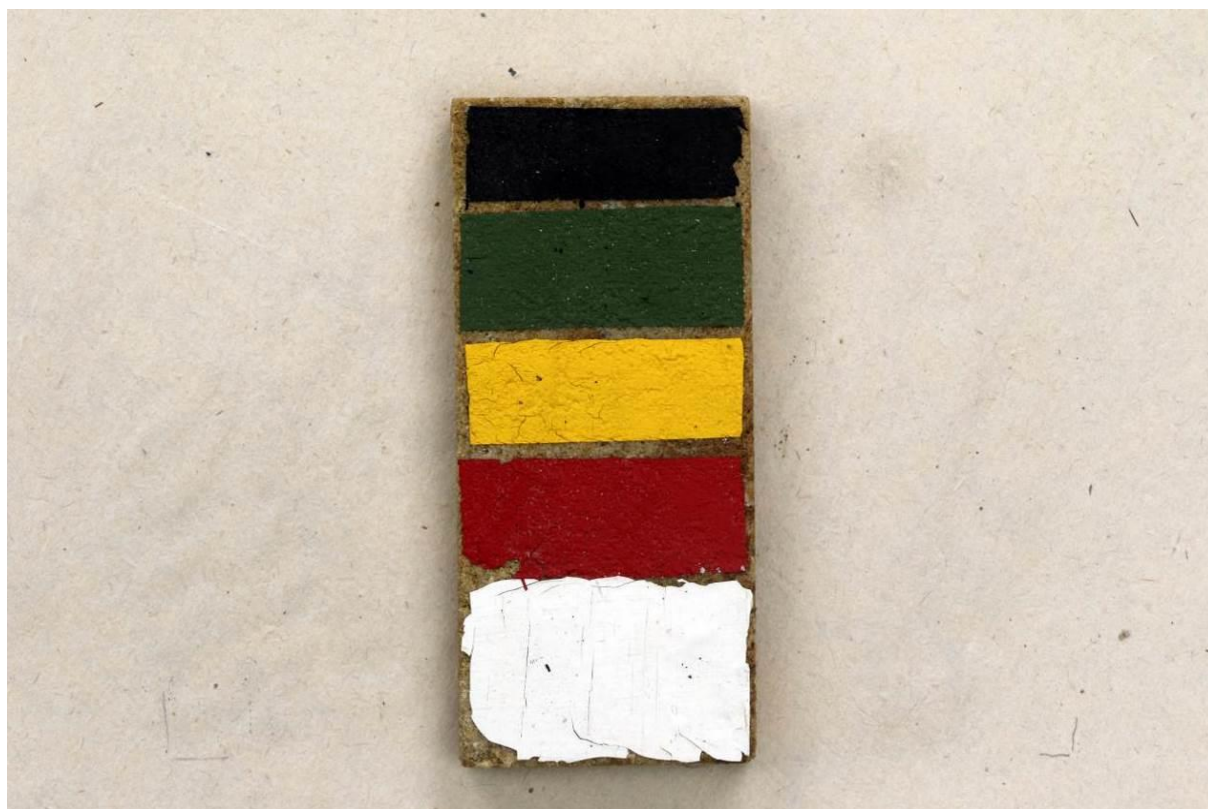
Po namáhání v klimatické komoře
