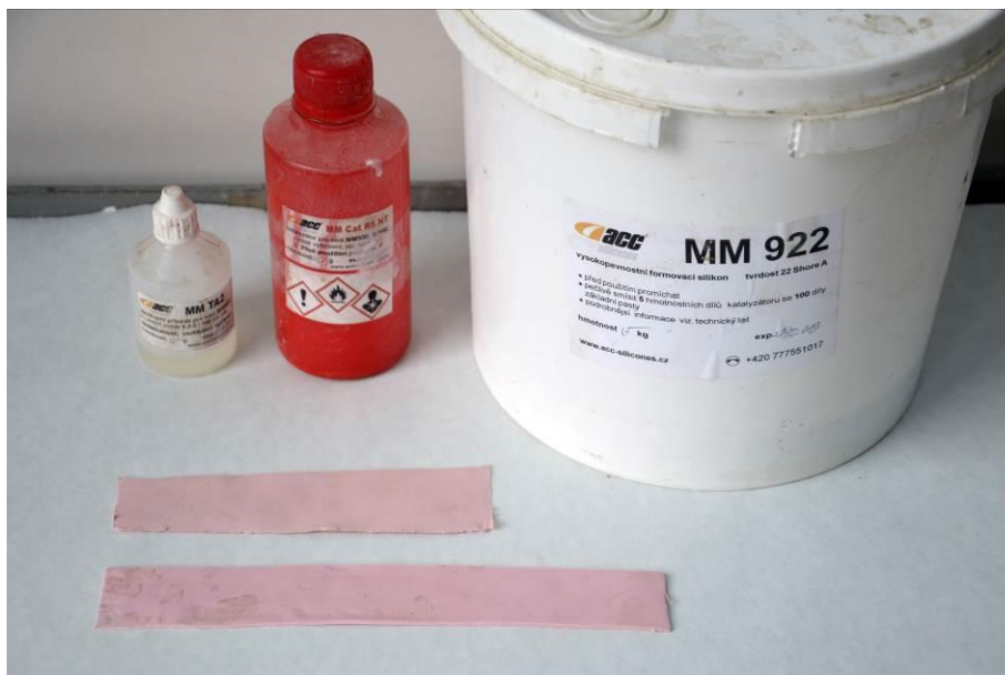
Silikon ACC MM 922 s katalizátorem a tixotropem, pruhy vytvrzeného silikonu
