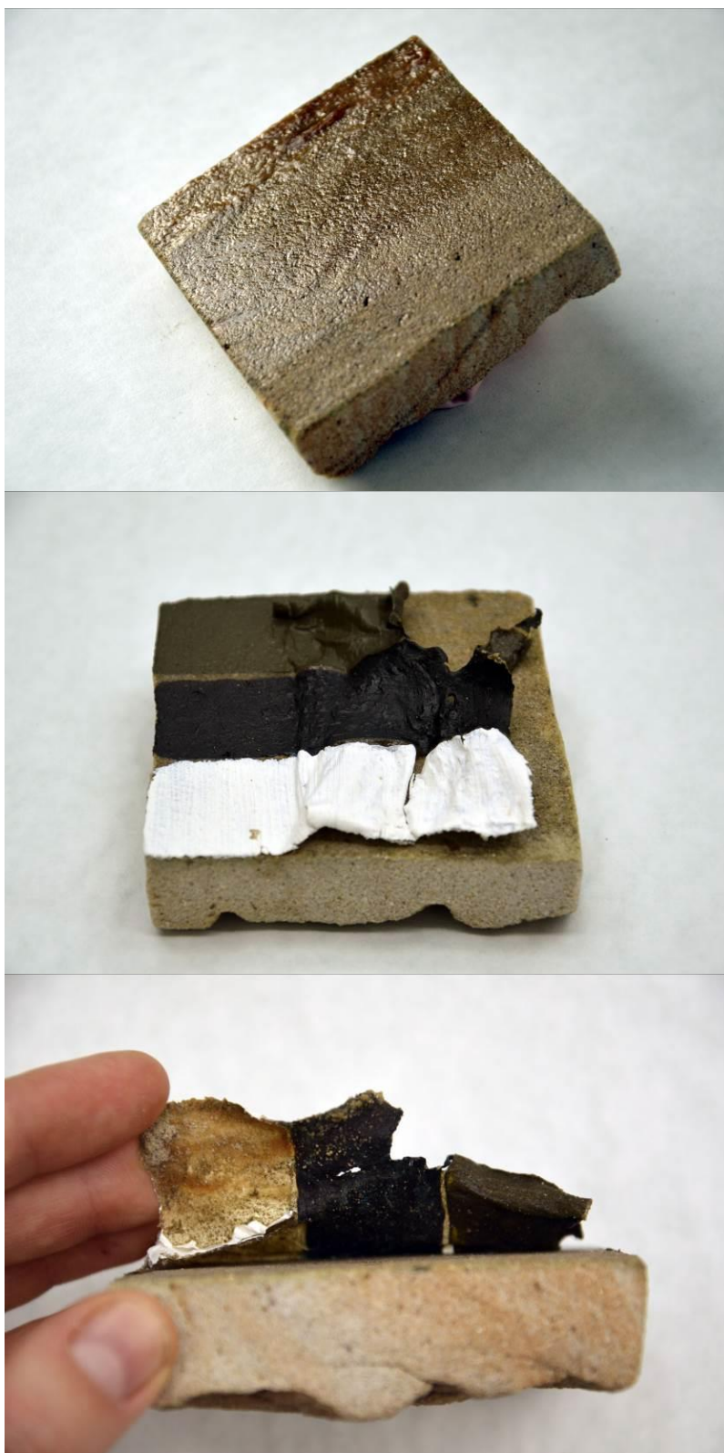
Kamenný vzorek natřený kožním kličem o různých koncentracích, výsledek zkoušky
