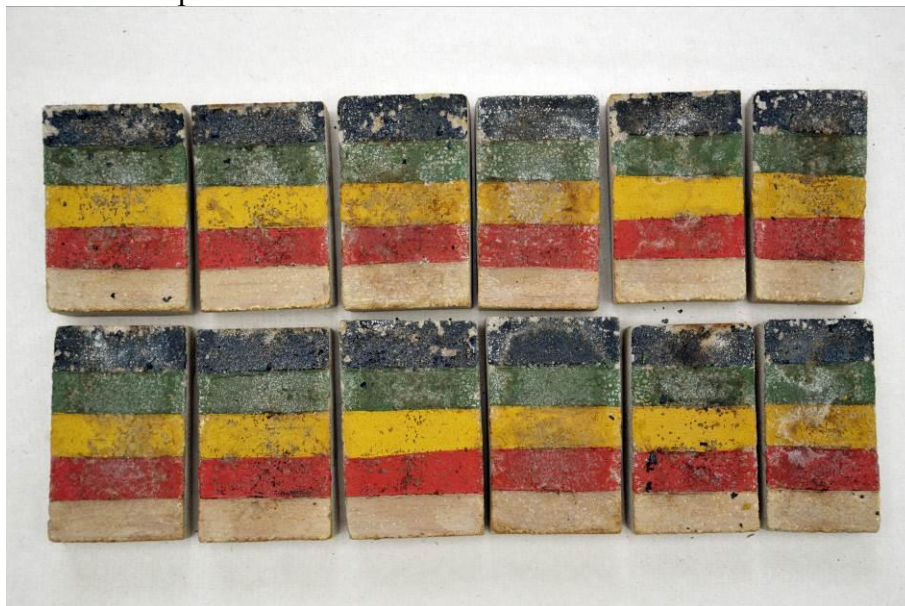
Vzorky po namáhání tepelnými šoky
