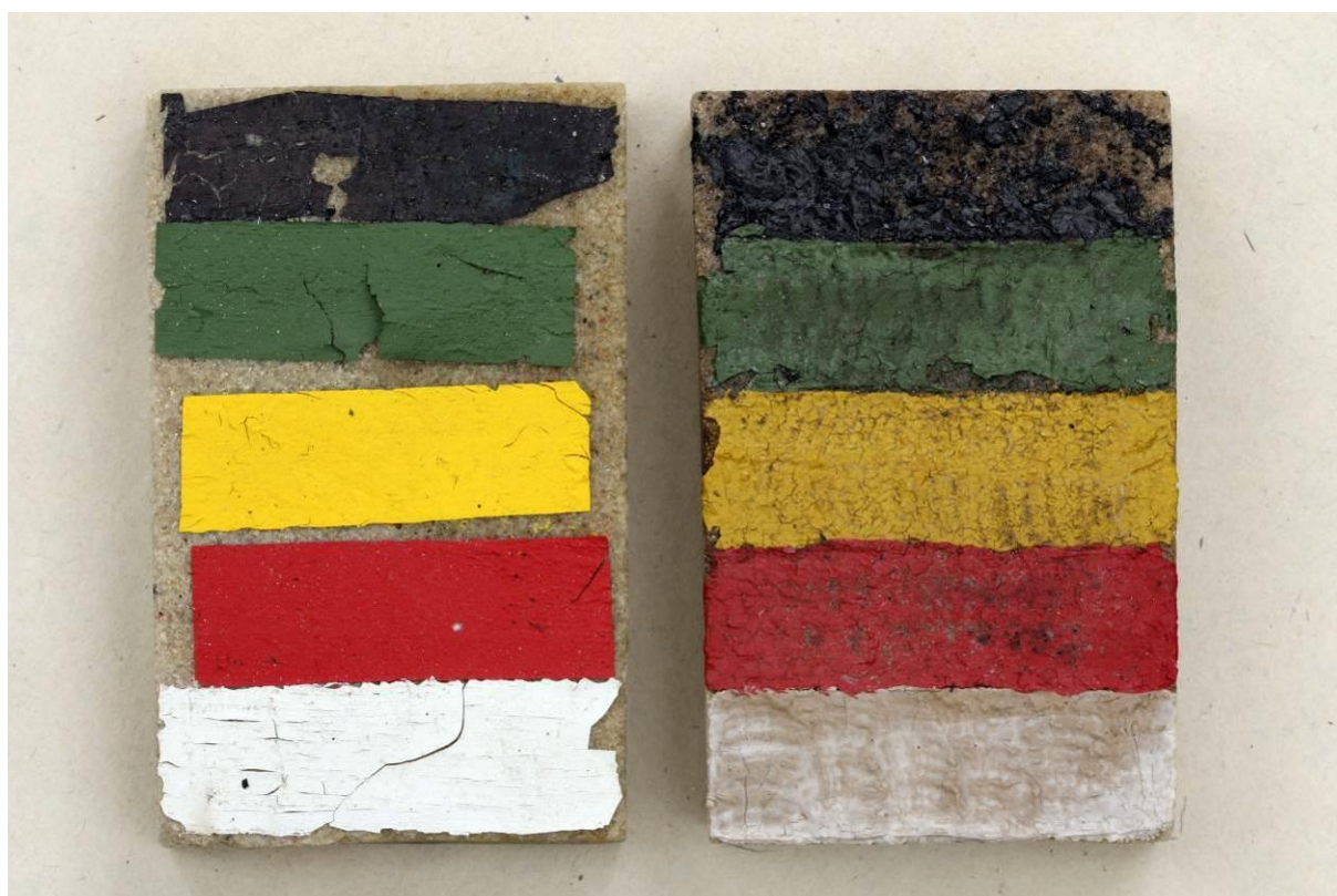
Po namáhání v klimatické komoře
