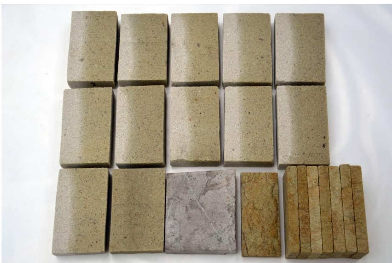
Kamenné vzorky: levé poloviny vzorku bez úpravy, pravé poloviny napuštěné lněnou fermeží
