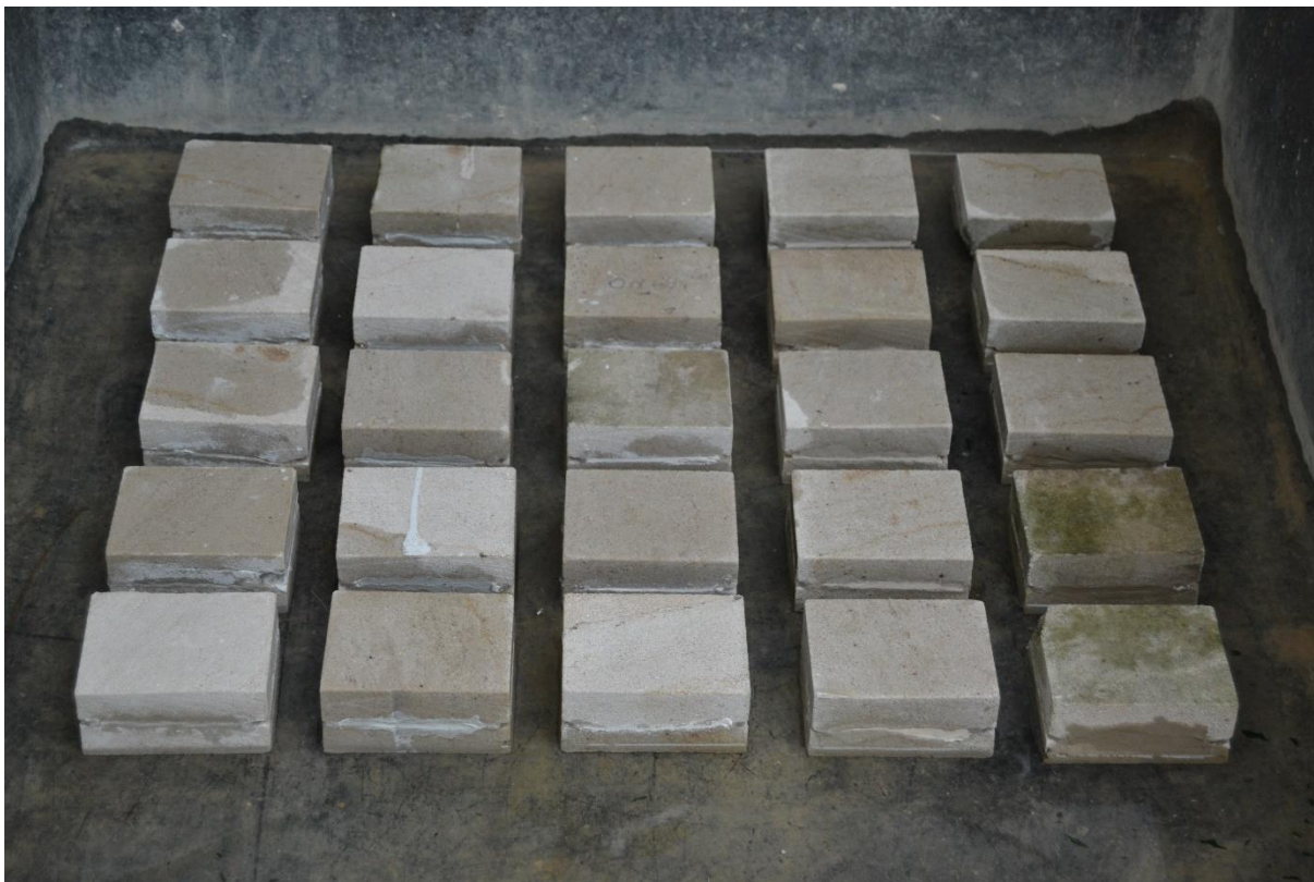
Namočené vzorky po jedné a půl hodině vsakování
