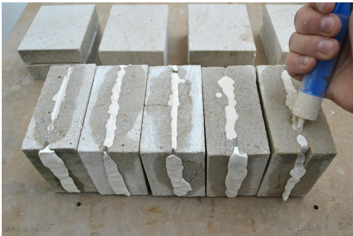
Aplikace injektážního materiálu
