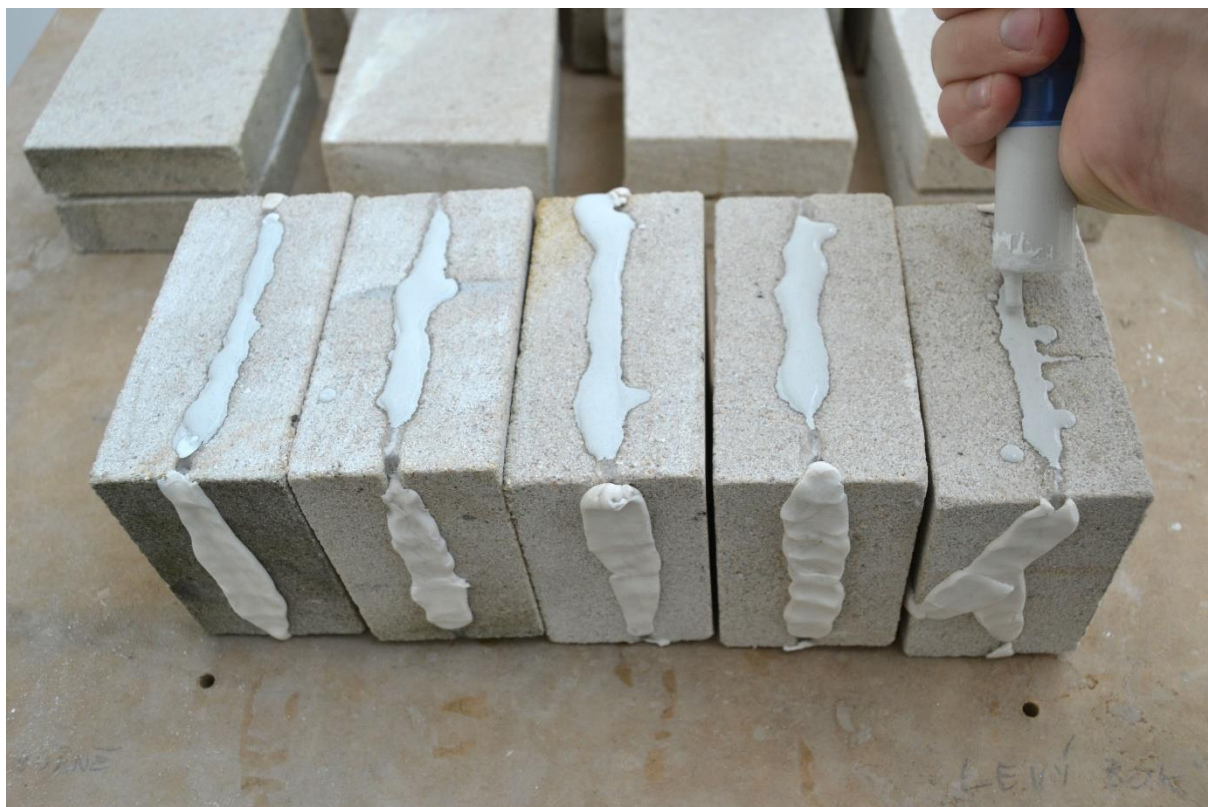
Aplikace injektážního materiálu
