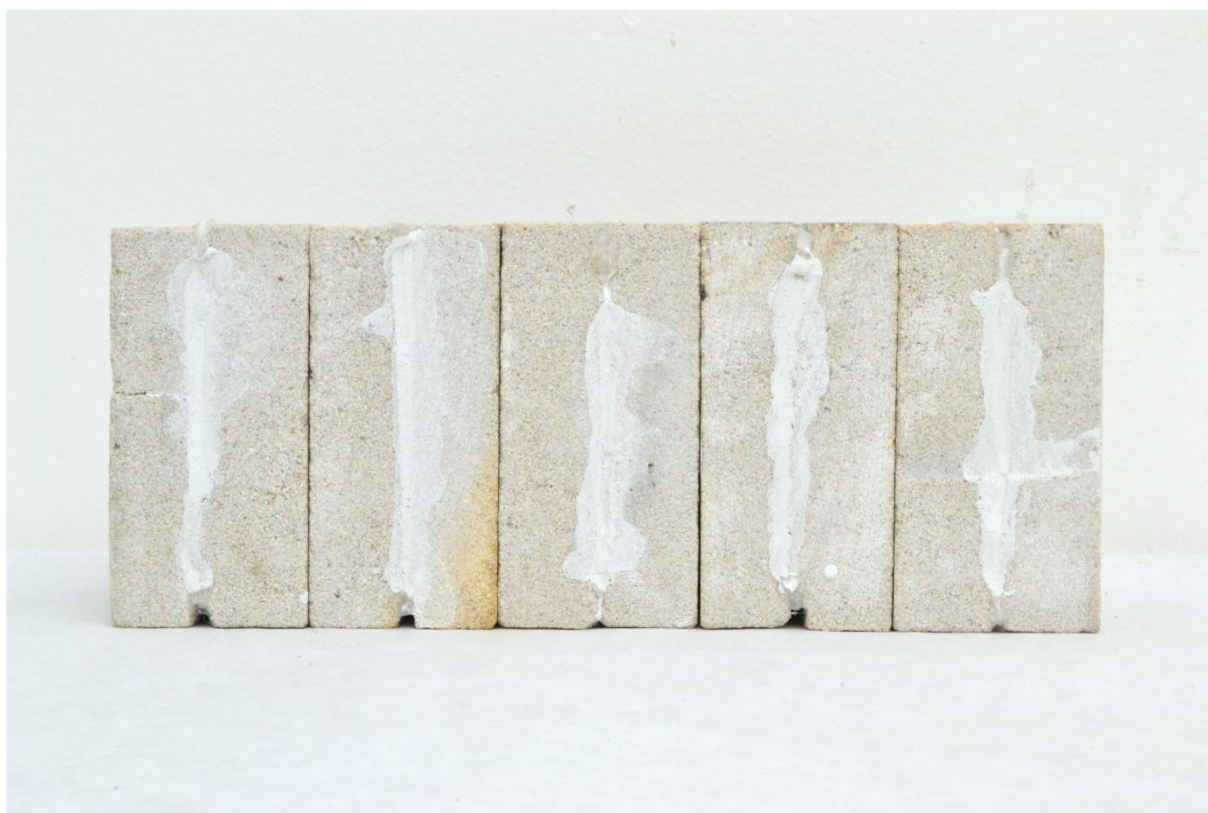
Materiál po čtyřech týdnech zrání
