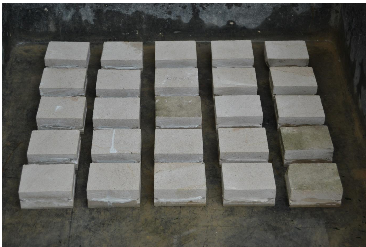
Vzorky před namáčením zleva: Remmers, Ledan, Nanovápeno, VAPOinjekt, Tassulo-B
