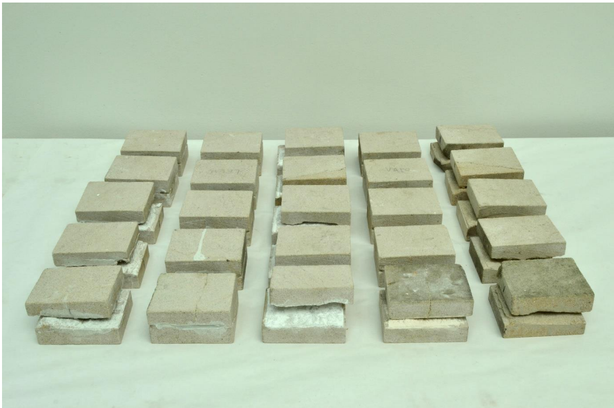
Tělíska po testech v komoře zleva – Remmers, Ledan, Nanovápno, VAPOinjekt, Tassulo-B
