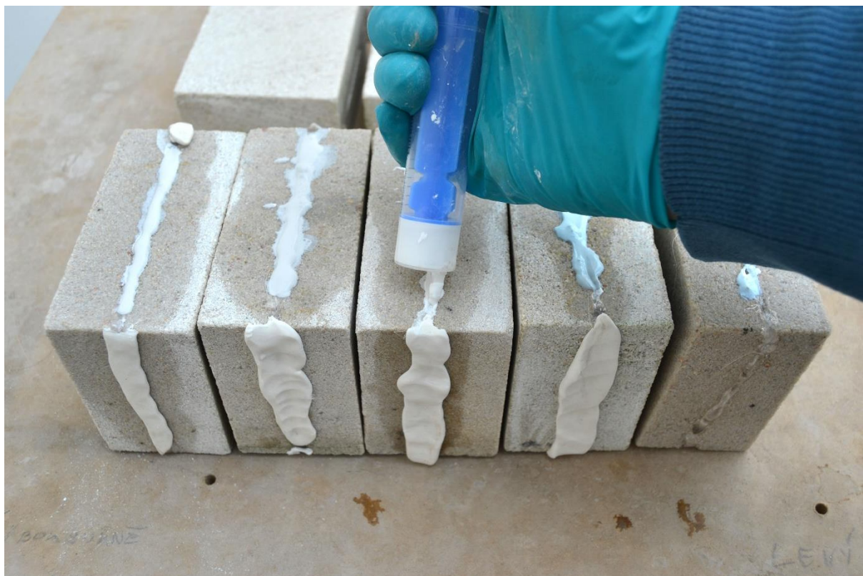
Aplikace injektážního materiálu
