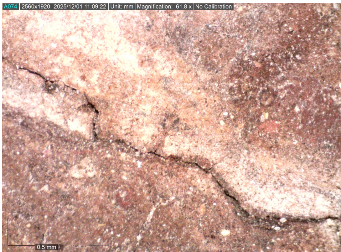
Obr. 14 vizuální průzkum, fotografie pořízena mikroskopem Leica CLS 150 MR, čelní strana sochy-místo pod kolenem levé nohy sv. Antonína, blíží zkoumání praskliny
