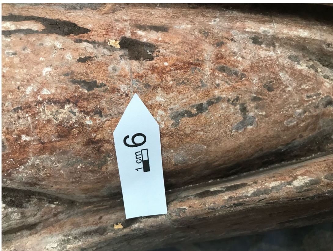
Obr. 13 vizuální průzkum, zkoumání soudržnosti výplně praskliny, čelní strana sochy-místo pod kolenem levé nohy sv. Antonína, blíží zkoumání praskliny
