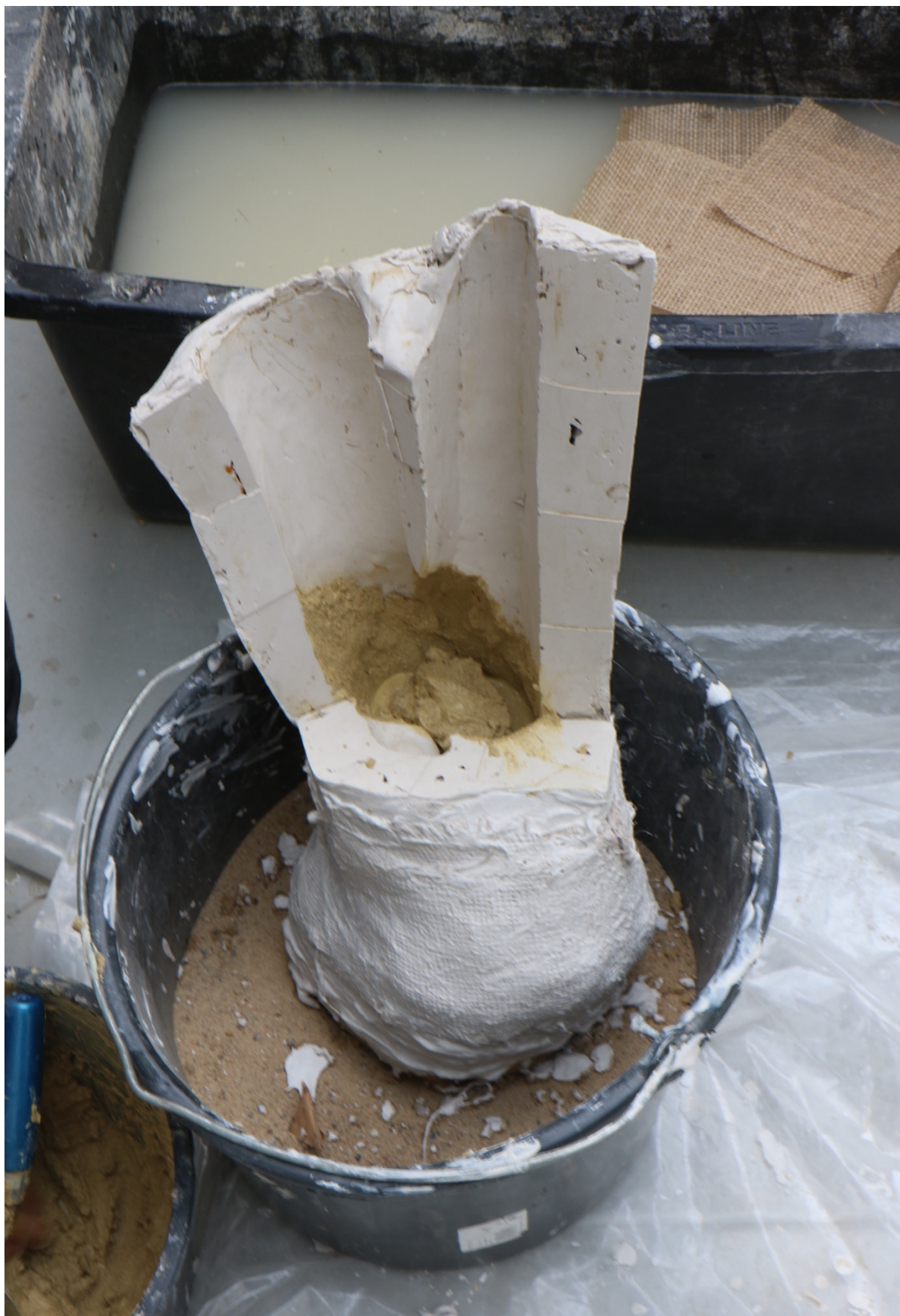
Obr. 115 rekonstrukce atributu pochodně, proces dusání
