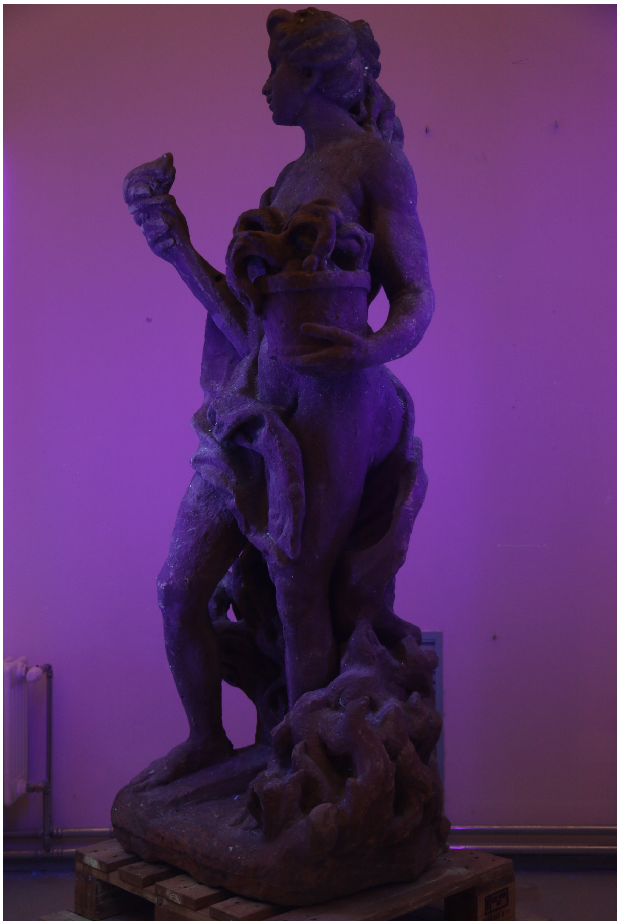
Obr. 15 vizuální průzkum v UV světle, tříčtvrtěční pohled
