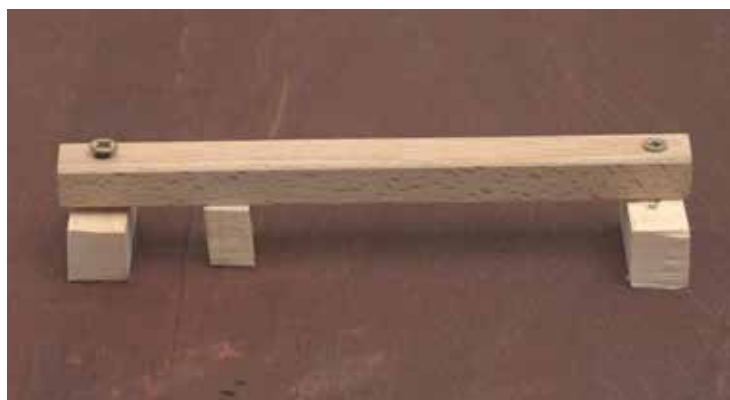
systém pro postupné vyrovnaní prakliny, umístěný ze zadní strany desky
