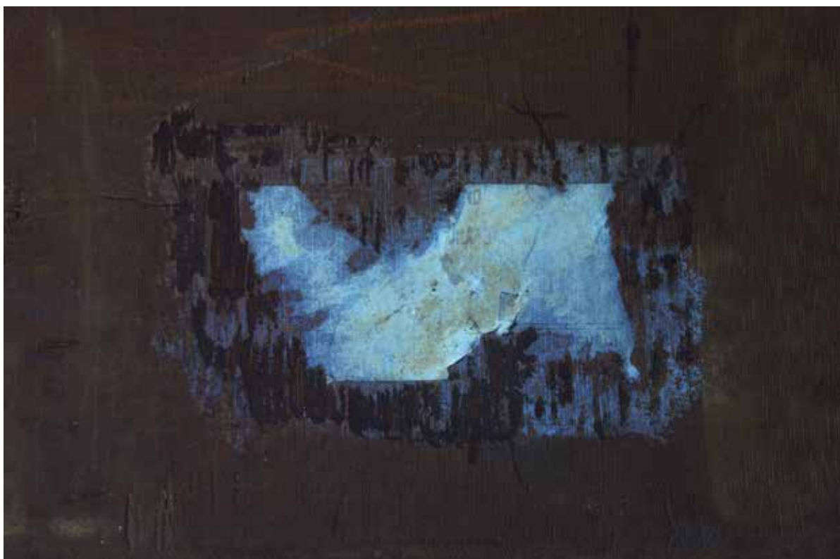
Detail ve VIS a UVL zbytek lepu po některým ze štítků zadní strana
