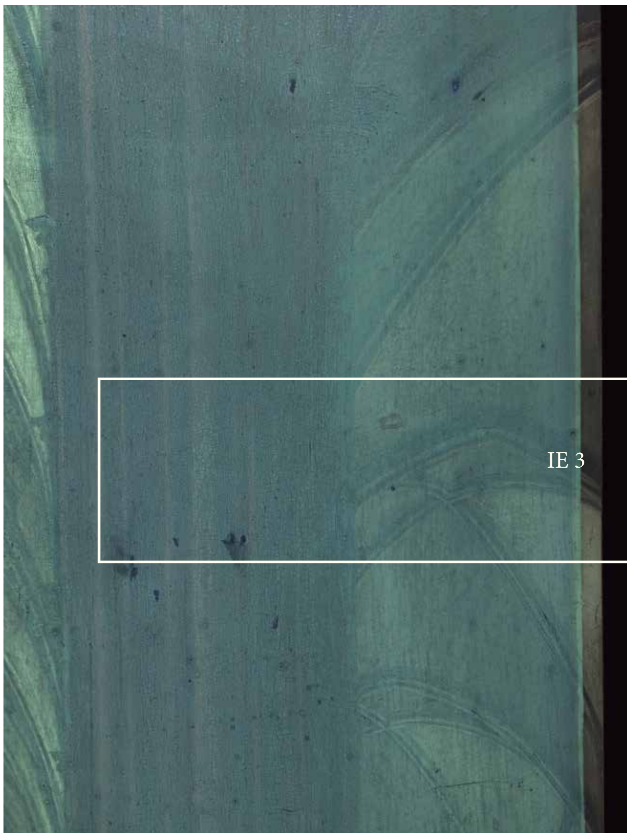
detail VIS zkoušky snímání první lakové vrstvy se zalakovanou nečistotou pravý horní okraj
