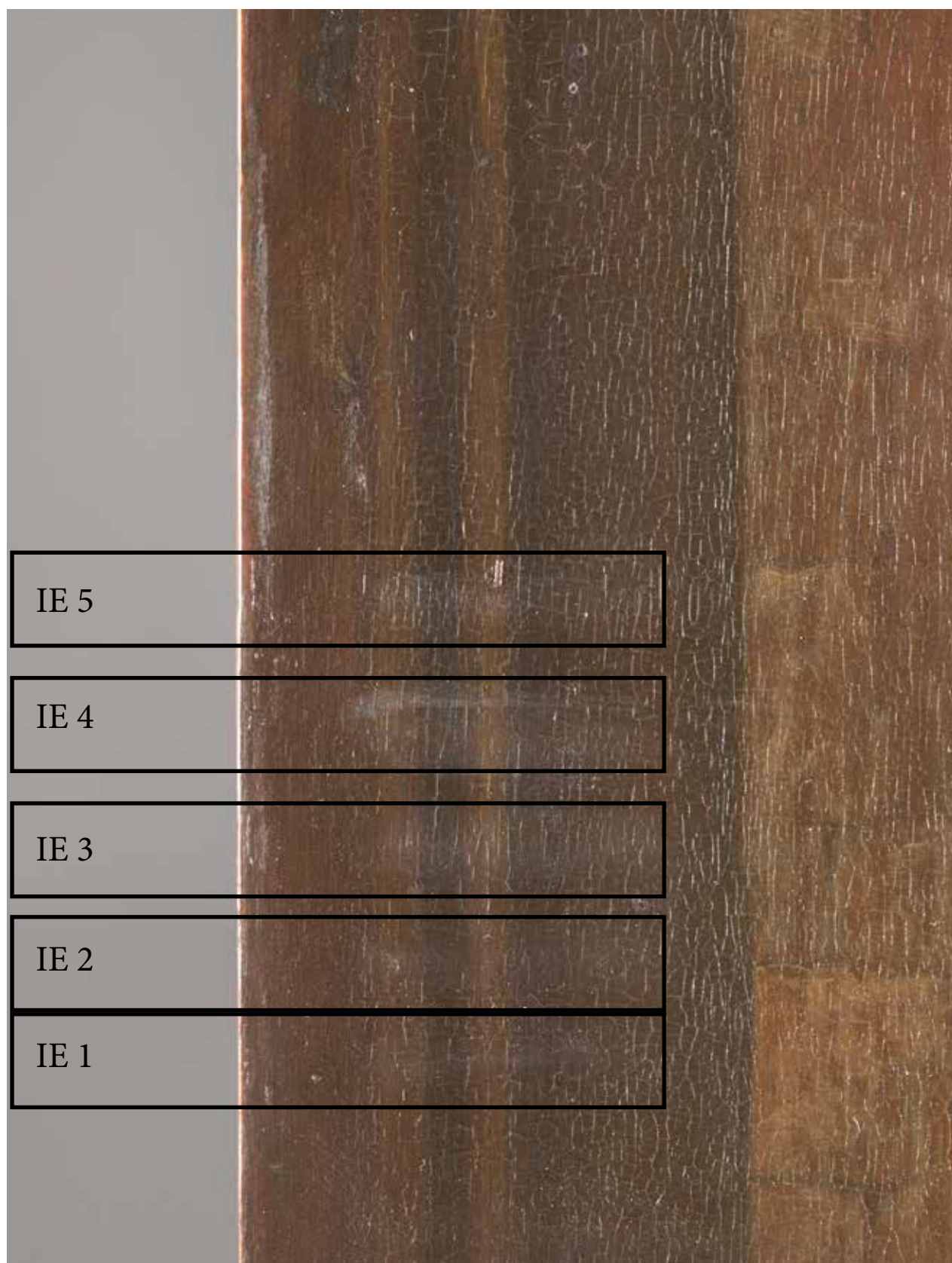
detail VIS zkoušky snímání první lakové vrstvy se zalakovanou nečistotou levý okraj
