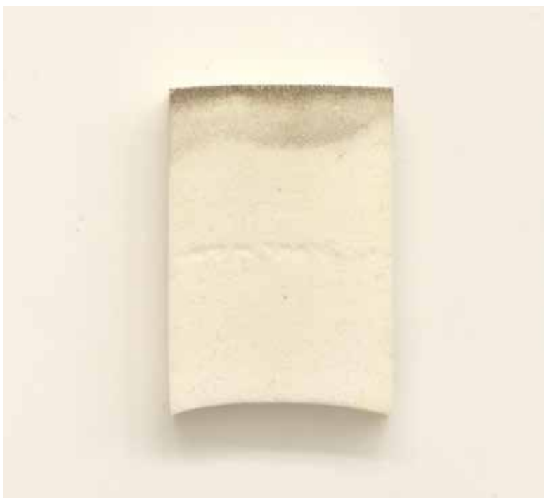
zkouška citlivosti na vodu snímání povrchových nečistot suchou cestou
