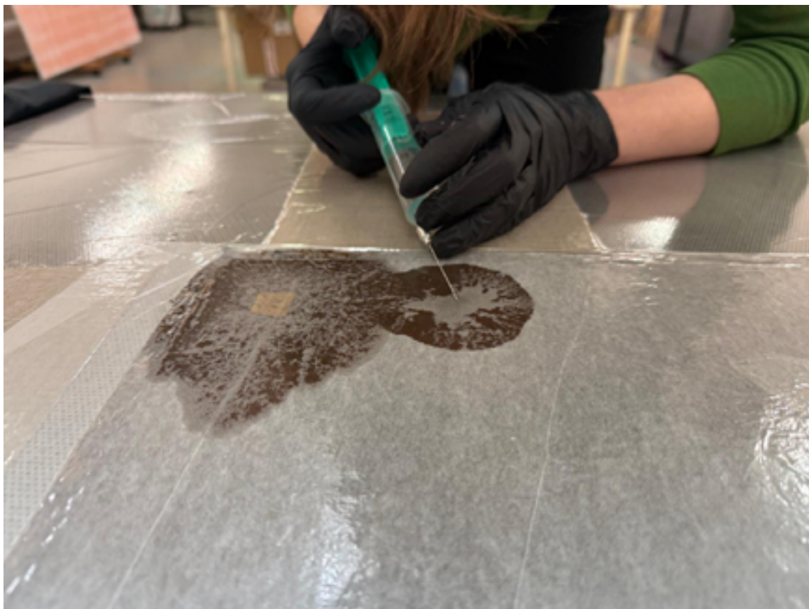
aplikace konsolidantu v podtlaku
