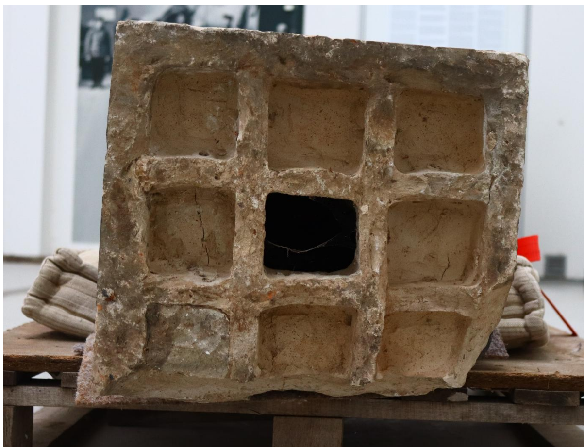
Obrázek 22 Fotografie zobrazující spodní část sochy, vystavěných žeber a místo zlomu v zadní části sochy. Také lze zde vidět vyplnění cementovým materiálem ve spodní levé části.
