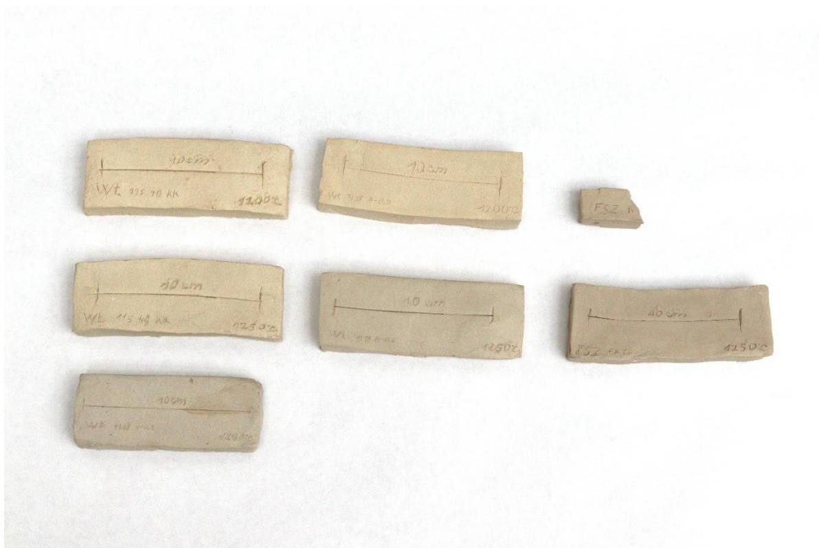
Obrázek 42 Zkoušky plastického doplnění, hledání vhodné keramické hlíny a teploty výpalu, které budou nejvhodnější pro doplnění restaurované sochy.
