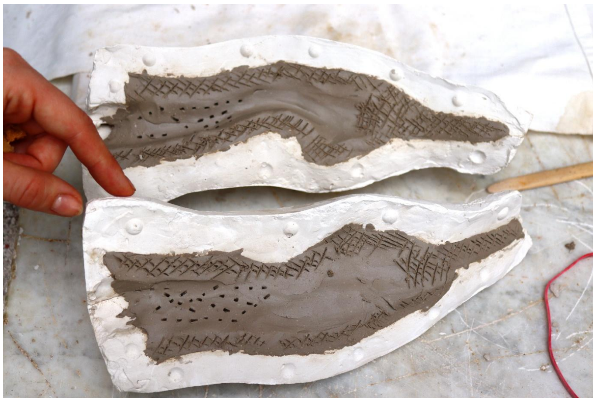
Obrázek 51 Etapa vtlačování keramické hlíny do klínové formy, Následně byly tyto dvě části spojené na tzv. šlíkr
