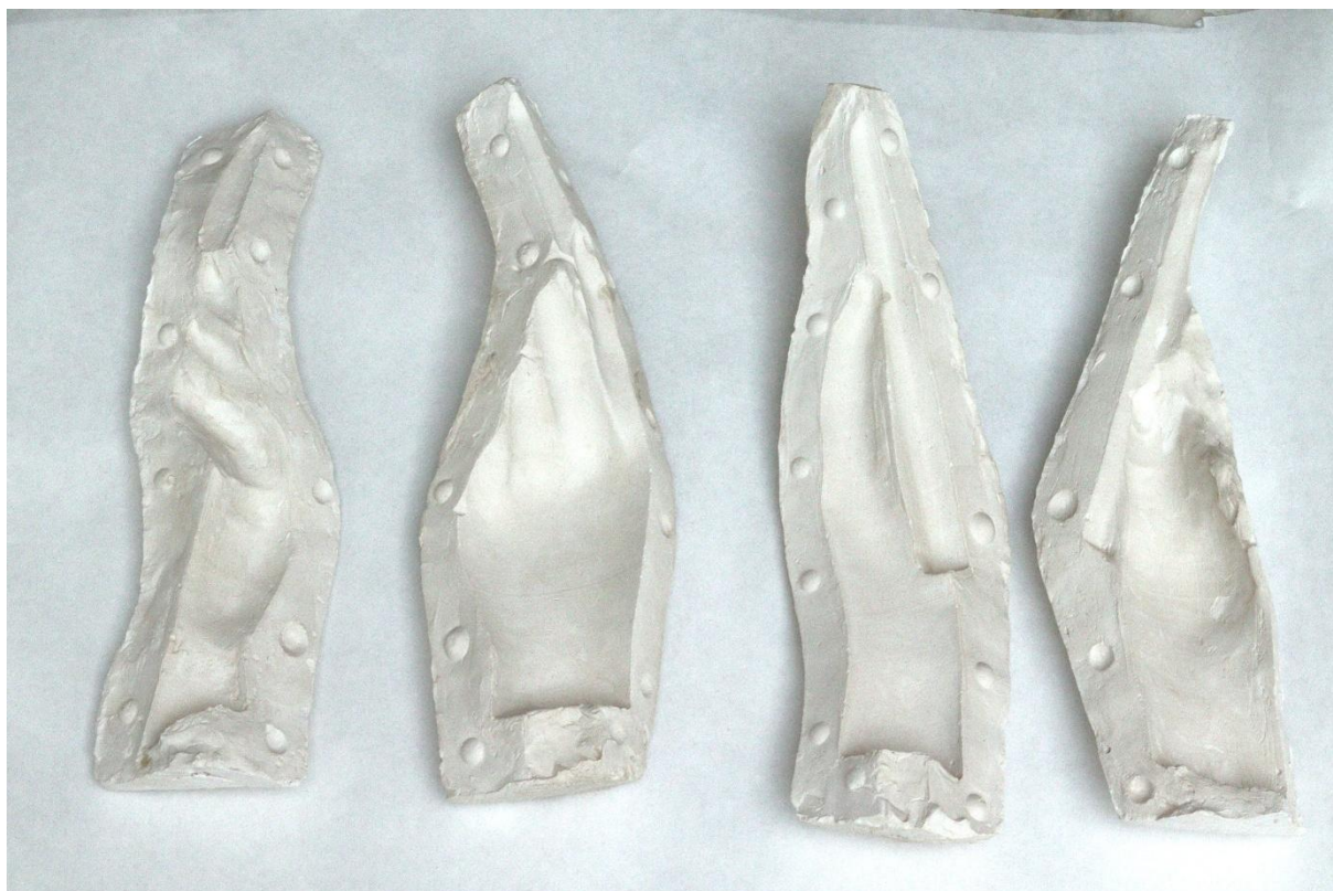
Obrázek 50 Vytvořená sádrová klínová forma pro zrealizování doplňku ruky do keramické hlíny
