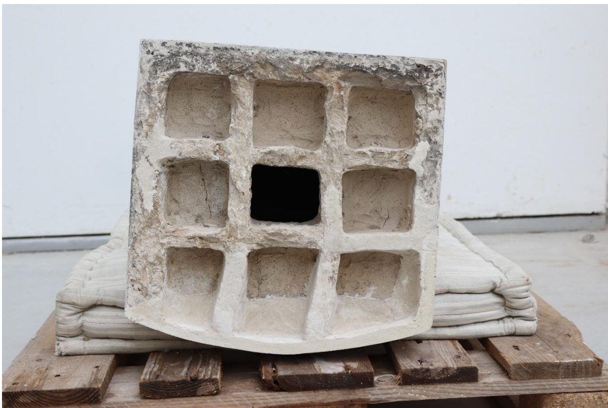
Obrázek 72 Stav stojné plochy po přisazení zadní části keramického doplňku. Po očištění horkou párou a propojení žeber originálu a doplňku za pomoci křemičité moučky a cementu v poměru 3:1
