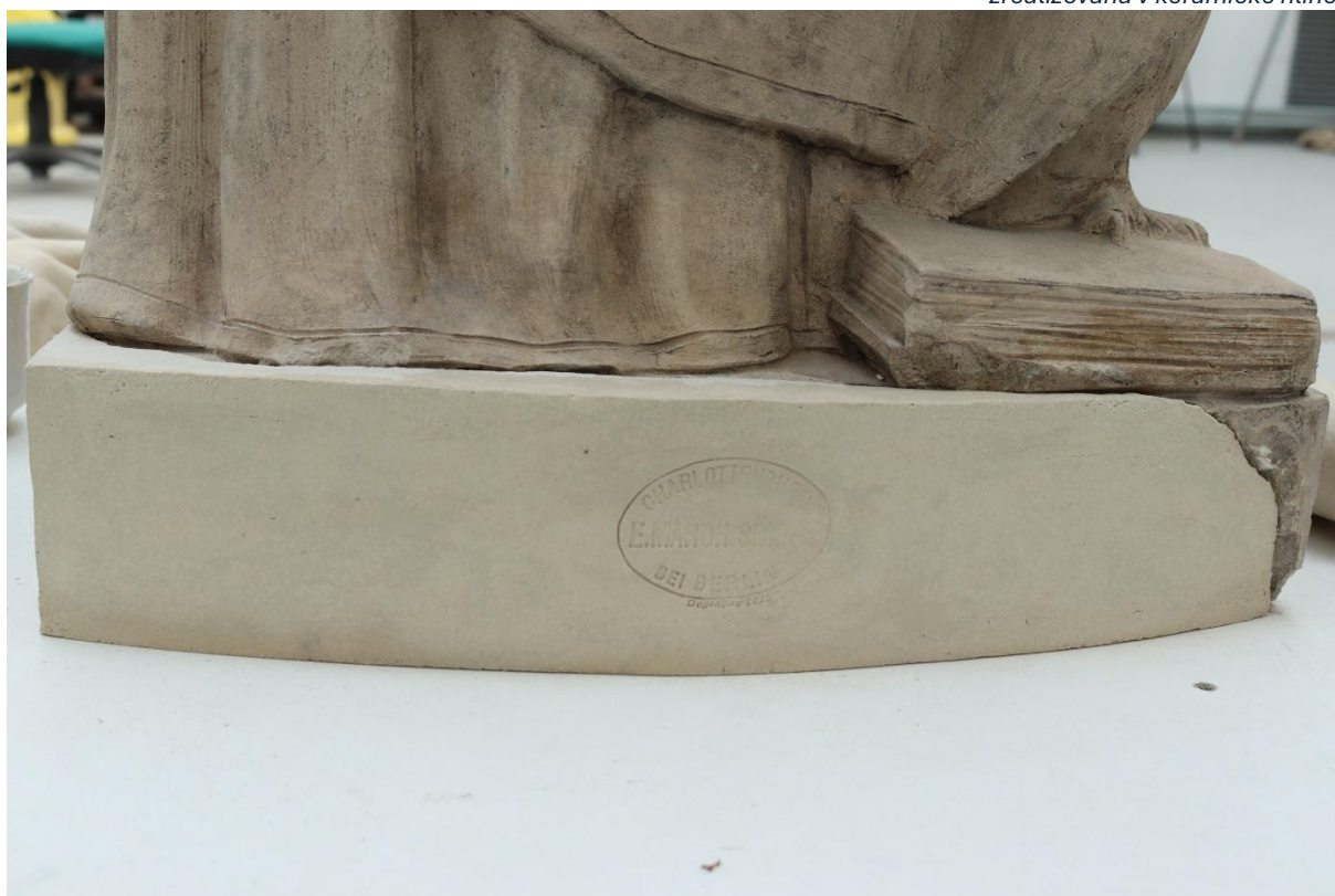
Obrázek 46 Plastické doplnění soklové části. Rekonstrukce doplňku byla vymodelována v sochařské hlíně a následně zrealizována v keramické hlíně.
