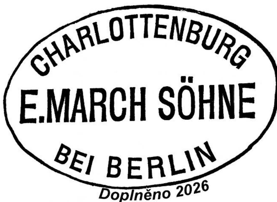
Obrázek 44 Vytvoření razítka pro plastické doplnění soklové části. Byla vytvořena vizualizace razítka s dodatkem o jeho doplnění v rámci restaurátorského zásahu. To bylo vytvořeno v 3D programu a následně vytištěno na 3D tiskárně.
