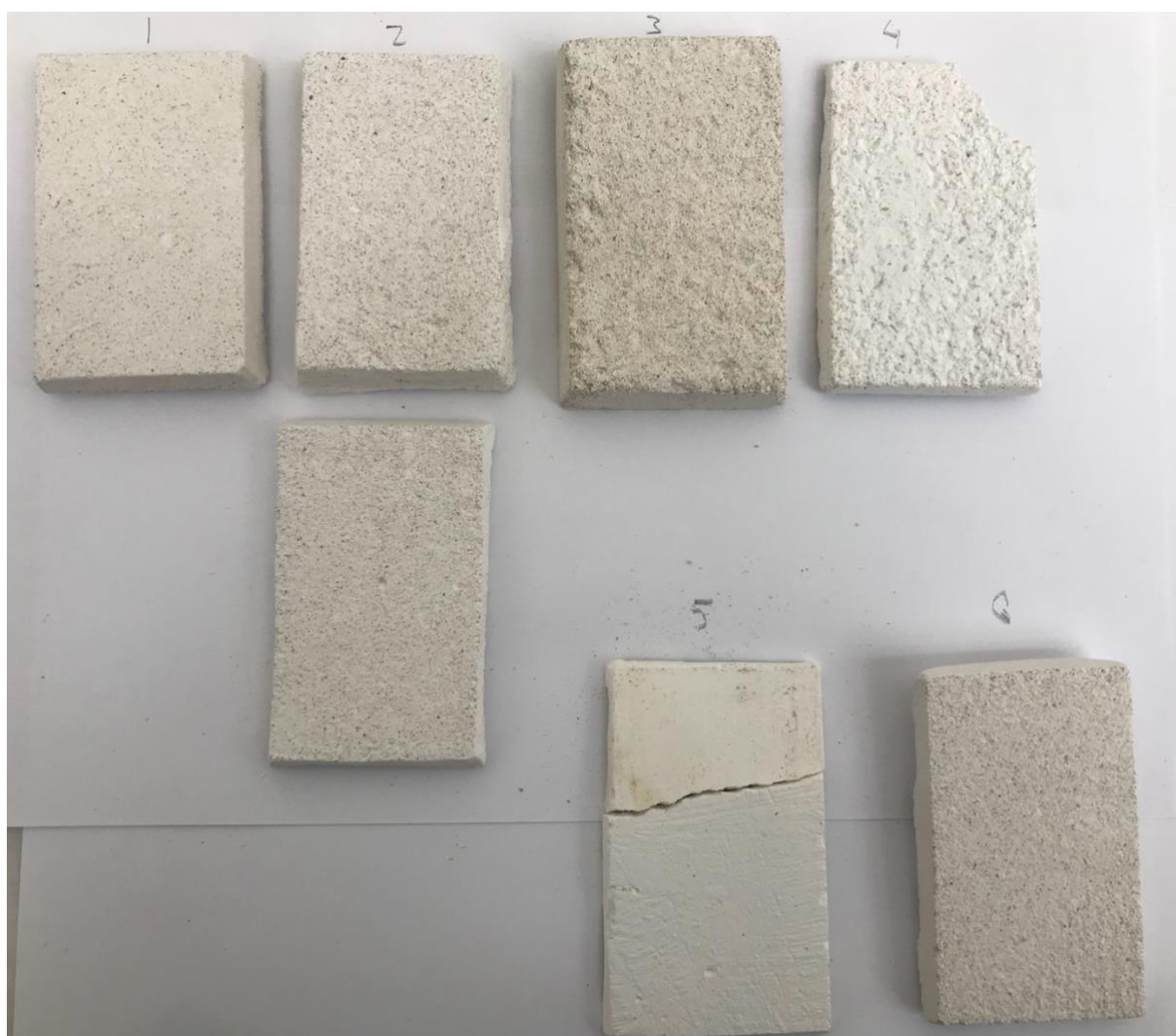
Obr. 1. vzorky z první tabulky po vytažení z formy a po škrábnutí
