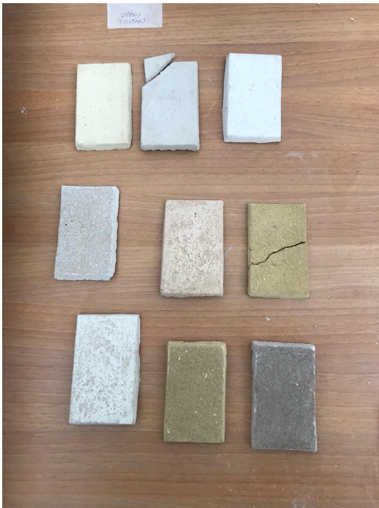
Obr. 2. vzorky z druhé tabulky po vytažení z formy a po škrábnutí
