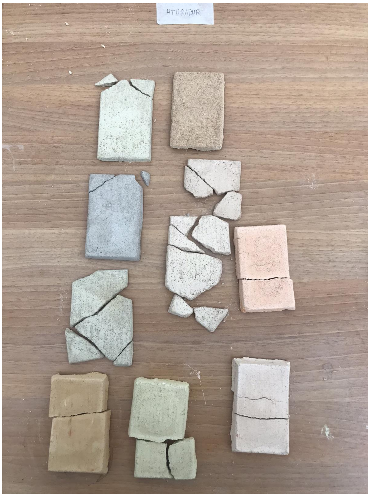
Obr. 3. vzorky z třetí tabulky po vytažení z formy a po škrábnutí
