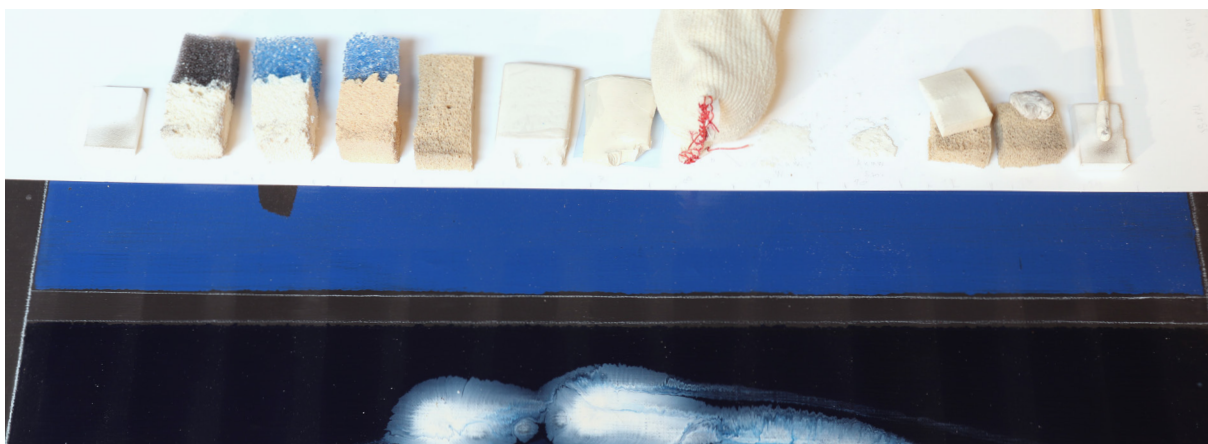
Fotografie jednotlivých materiálů a jejich kombinací po zkouškách snímání nečistot na vybraném díle.
