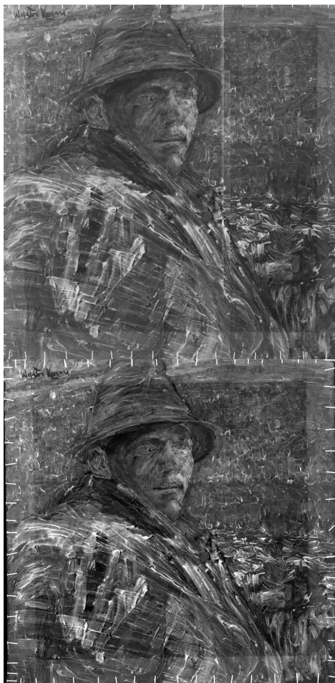
• Obr. 38 - Porovnání radiografických snímků, nahoře RTG snímek naměřený s pomocí nepřímé digitalizace na fotografickou fólii, dole mikroradiografie ve vysokém rozlišení s využitím detektoru Wipepix. Zdroj: InsightArt a ÚTEF
