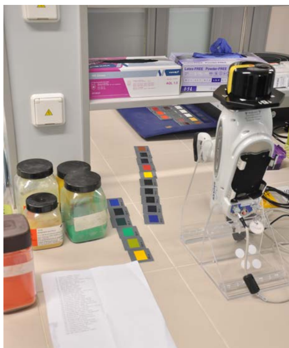
• Obr. 74 - Kontrolní měření prvkového složení kalibračních vzorků pomocí XRF.
