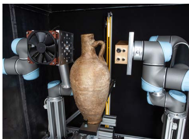
• Obr. 64 - RToo 3D umožňuje tomografické skenování archeologických nálezů a předmětů užitého umění. Zdroj: InsightArt, foto: Rudy Kovář, 2018
