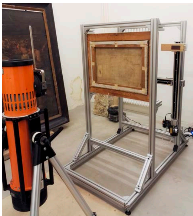
• Obr. 55 - První prototyp modulární skenovací aparatury instalovaný v RTG místnosti na AVU. Zdroj: InsightArt, 2016
