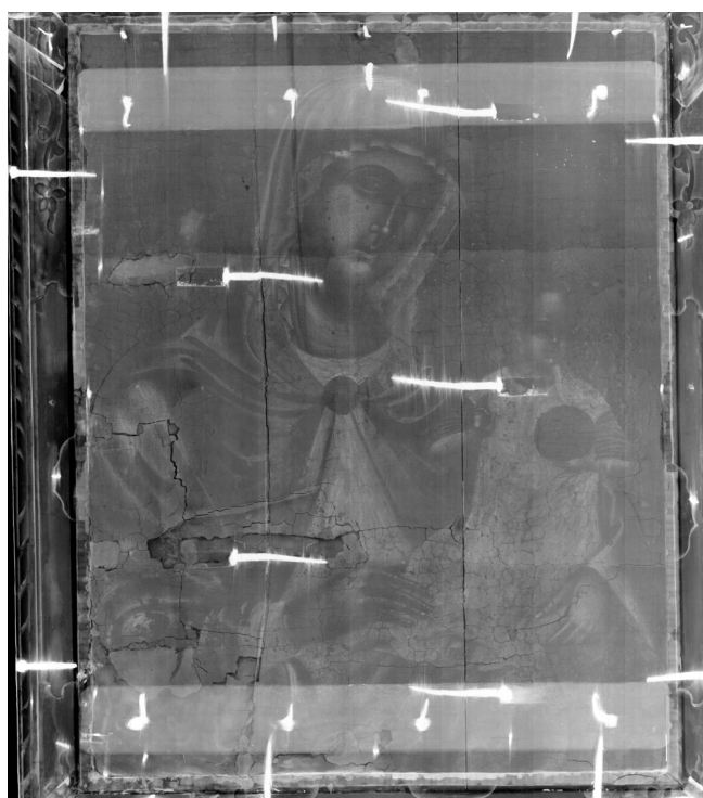
• Obr. 117 - Radiografie ve vysokém rozlišení pomohla přesně lokalizovat místa destrukce vrstvy malby a dřevěné nosné desky, díky tomu bylo možné šetrně odstranit nevhodné výplně a přemalby bez rizika dalšího poškození originální malby. Zdroj: InsightArt
