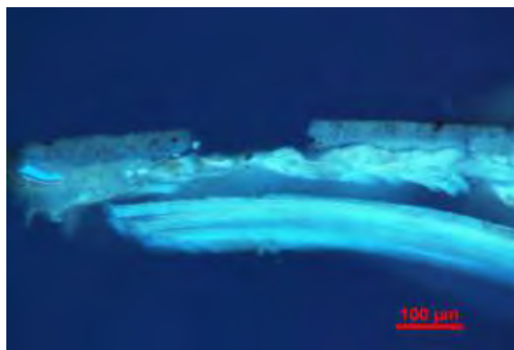
89.b Snímek v UVL příčného řezu mikrovzorku s patrným obarvením červeného pigmentu z exponované plochy malby. Antonín Slavíček, Pohled z Letné (1908) © Národní galerie Praha
