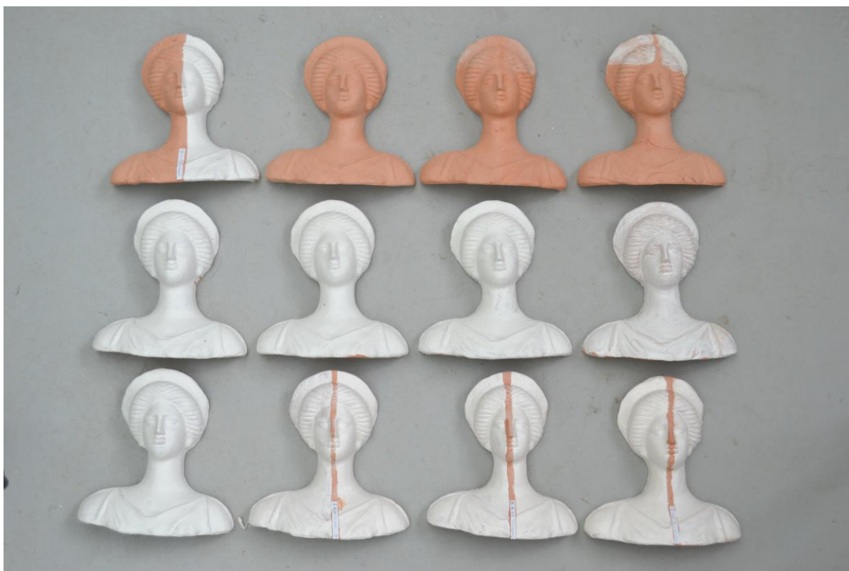
Obr. č. 12) zkoušky aplikace podkladové vrstvy (kaolin)
