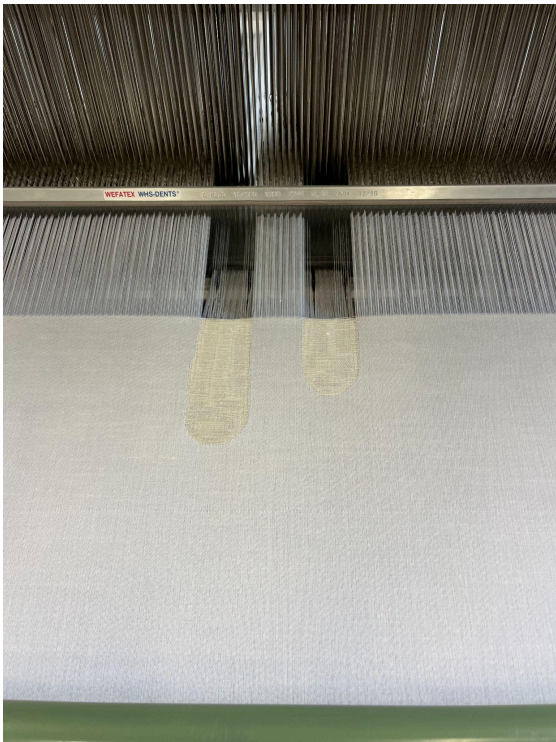
Obr. 5, 6 Tkaní na digitálním žakárovém stavu a detail tkané struktury.
