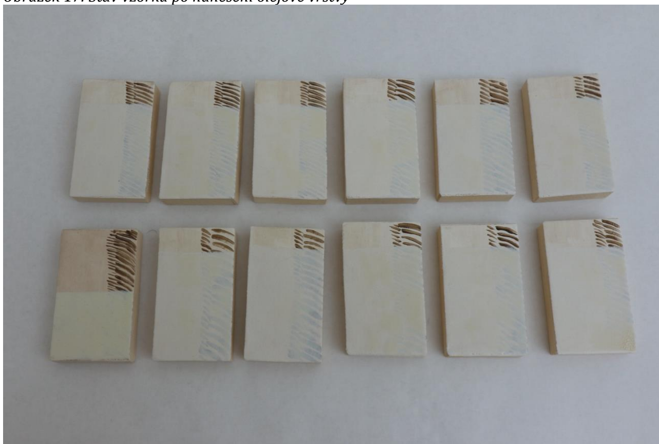
Obrázek 18: Stav vzorků po procesu stárnutí v UV komoře
