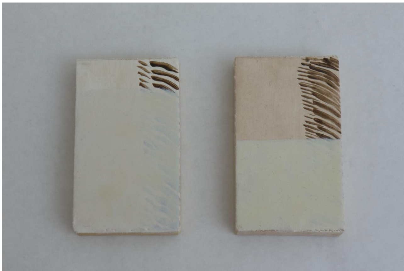
Obrázek 19: Porovnání vzorku bez stárnutí a po druhém stárnutí v UV komoře
