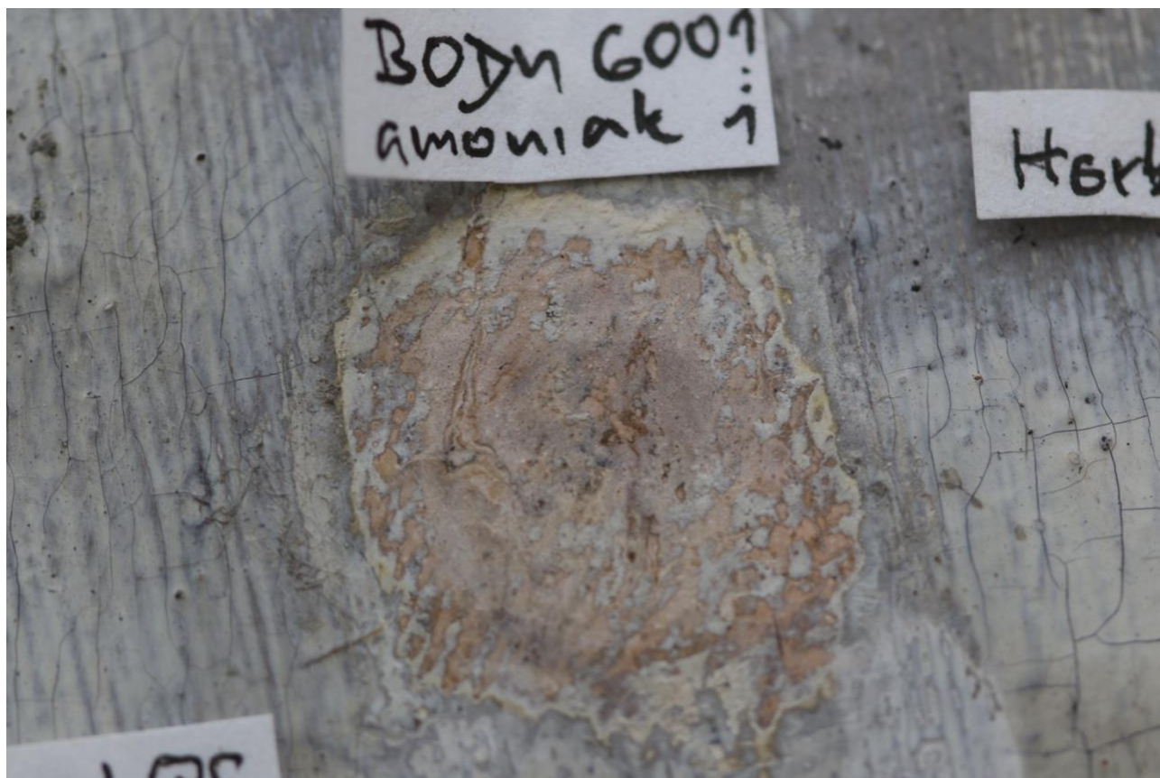
Obrázek 30: Detail povrchu po snímání rozpouštědly
