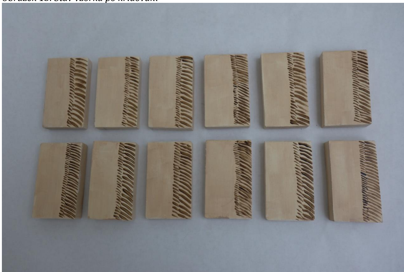
Obrázek 14: Stav vzorků po nanesení tempery a voskodamarového laku
