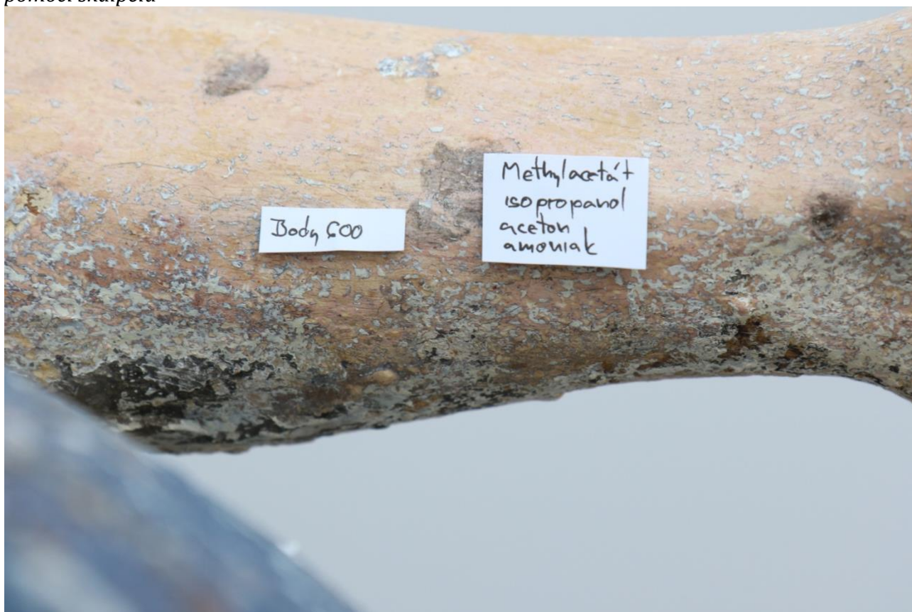
Obrázek 33: Zkoušky čištění částí, které nebylo možné snímat mechanicky
