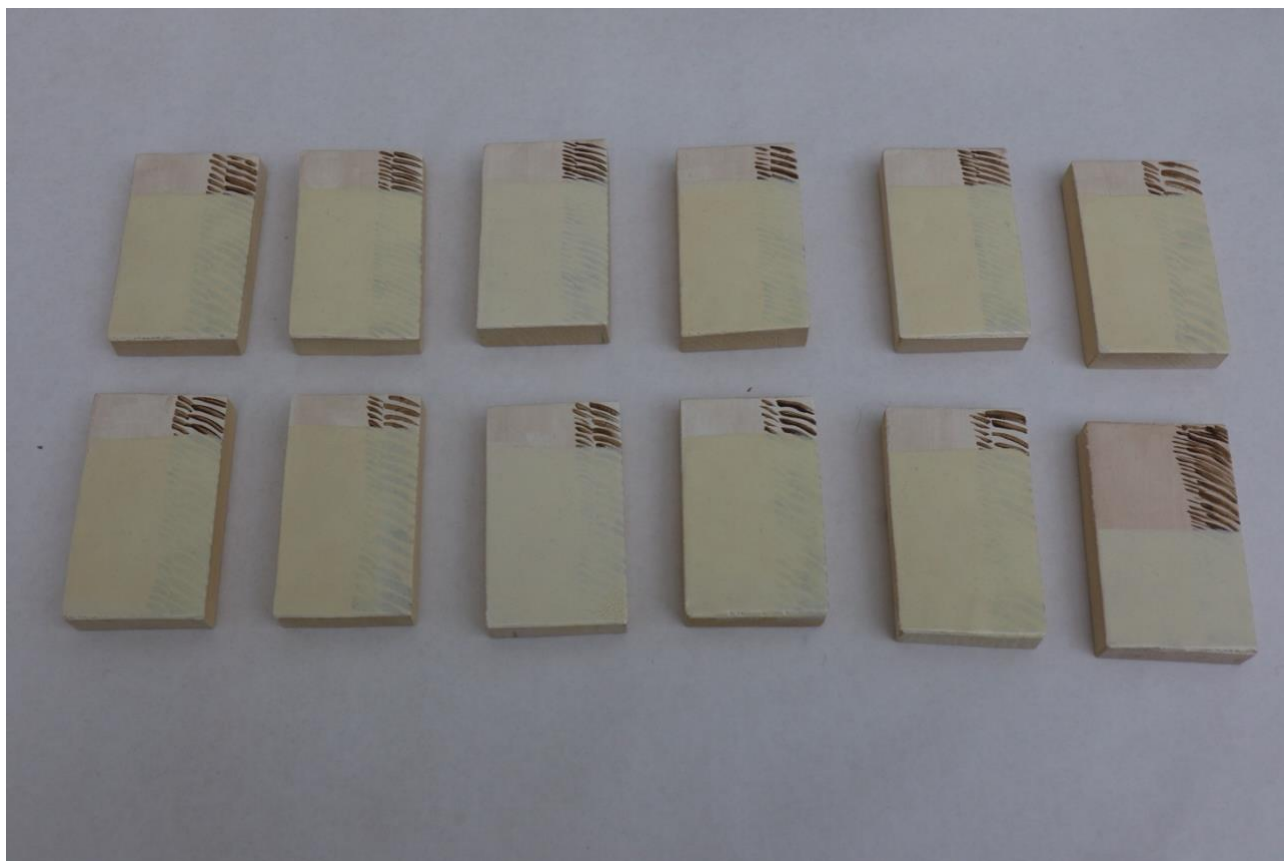
Obrázek 17: Stav vzorků po nanesení olejové vrstvy
