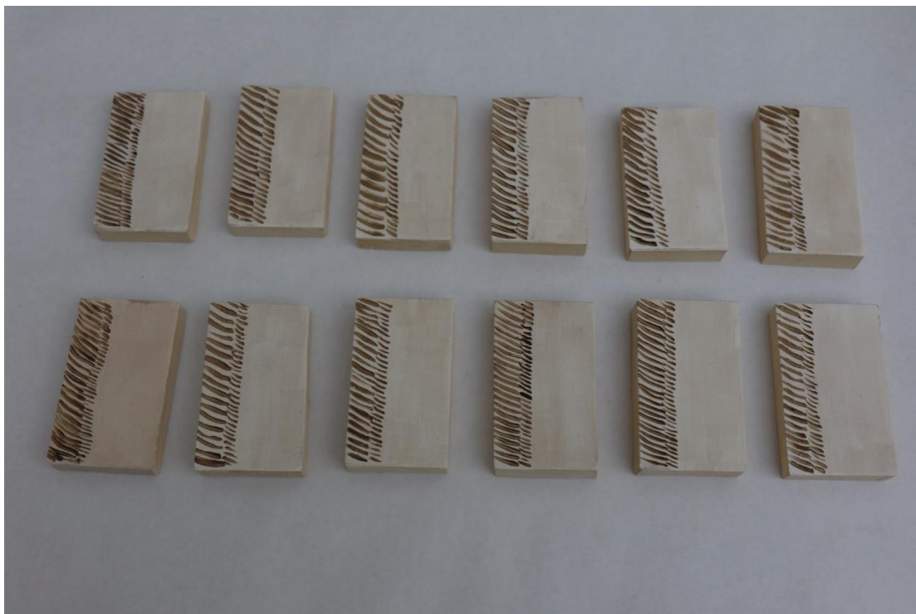
Obrázek 15: Stav vzorků po prvním stárnutí v UV komoře
