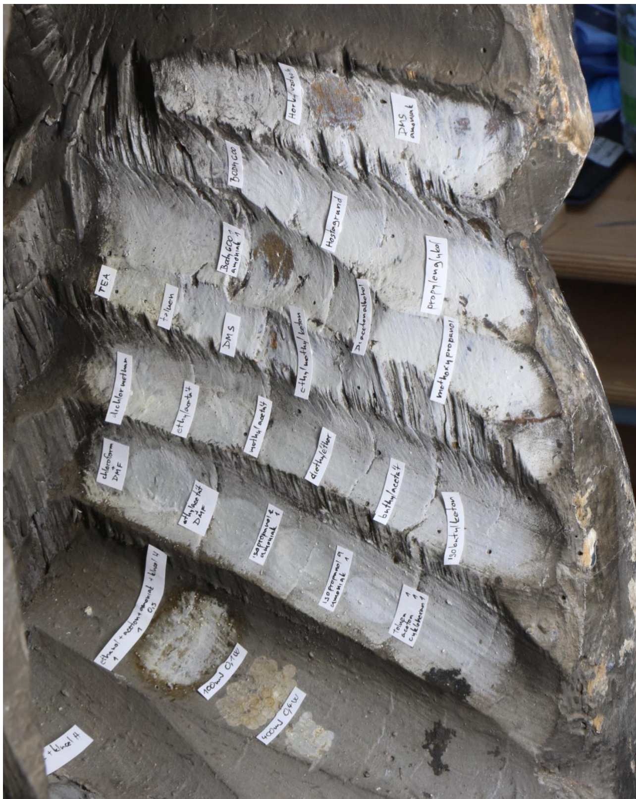
Obrázek 24: Zkoušky snímání olejových vrstev na dřevěném podkladu
