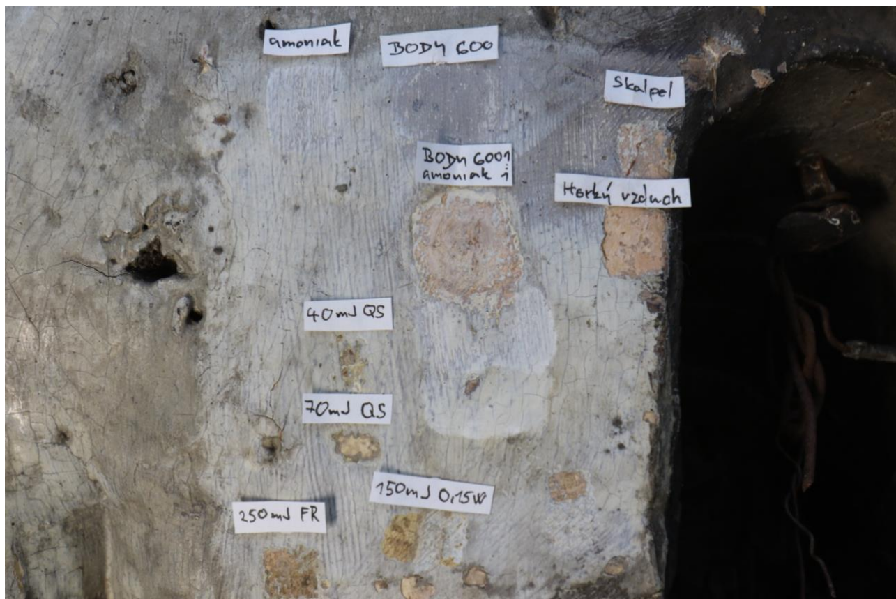
Obrázek 26: Zkoušky snímání olejových vrstev na temperovém podkladu
