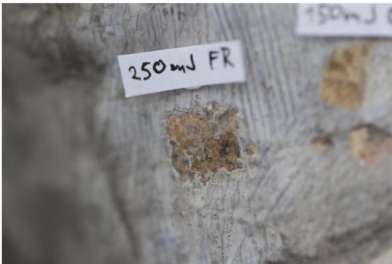
Obrázek 27: Detail povrchu po snímání laserem, je zde patrné změny barevnosti inkarnátu
