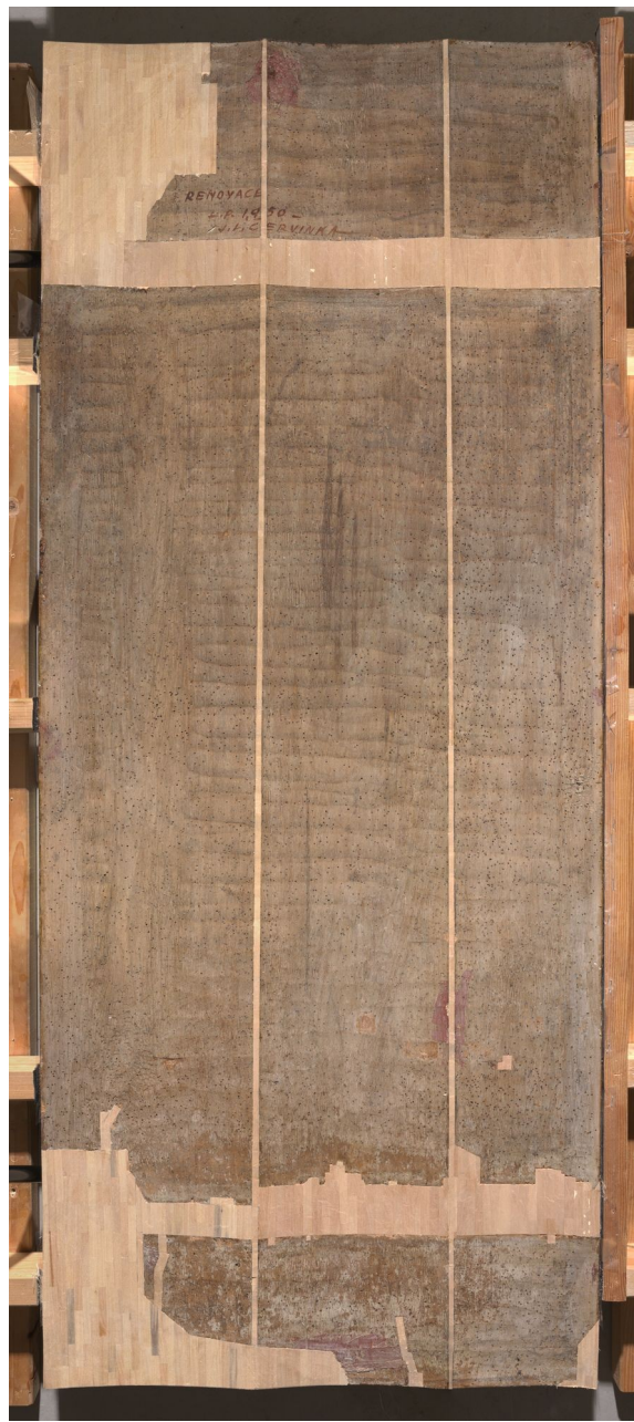
Stav desky po slepení fragmentů, doplnění chybějících částí desky novými lipovými klínky.
