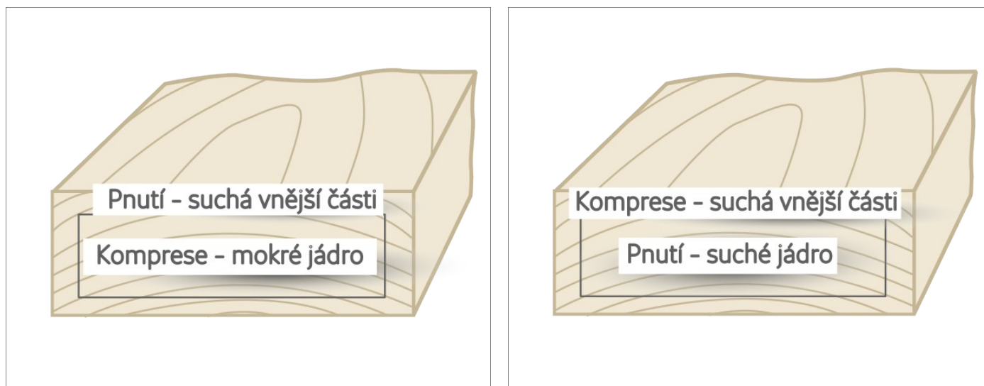
Sesychání dřevěné fošny. Vlevo – na začátku procesu sesychání. Vpravo – v pozdější fázi schnutí
