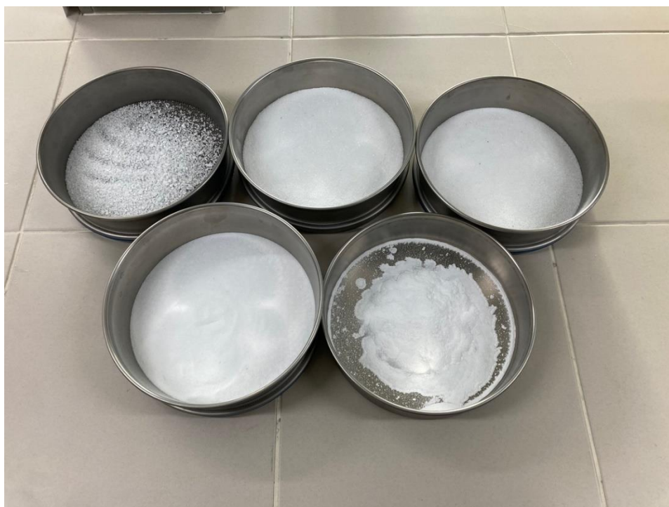
Obrázek č. 28: Jednotlivé frakce drti, vlevo nahoře nejhrubší, vpravo dole nejjemnější
