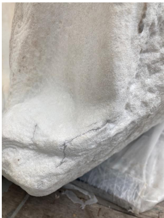
Obrázek č. 22: Trhliny na mramoru
