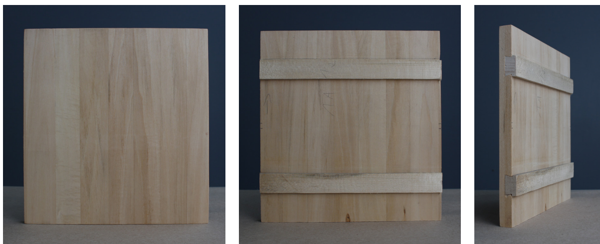
Přední, zadní a boční strana lipové destičky slepené z tenkých lišt a opatřené volnými svlaky ze zadní strany (fotila J. P. Tomíčková)
