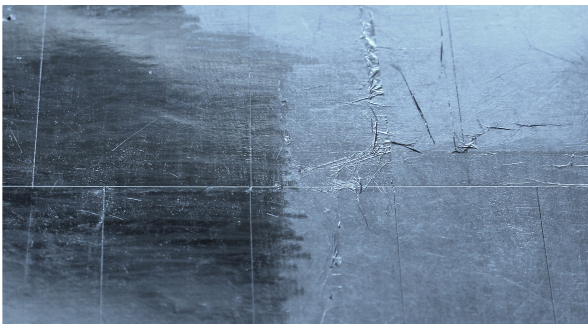
Fotografie rozdílu mezi vyleštěnou a matovou plochou stříbrných plátků na polimentu (fotila J. P. Tomíčková)
