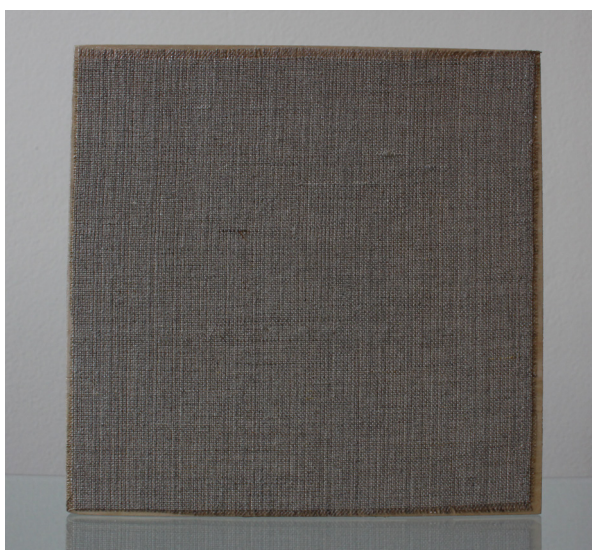
Přední a zadní strana lipové destičky opatřené lněným plátnem (fotila J. P. Tomíčková)
