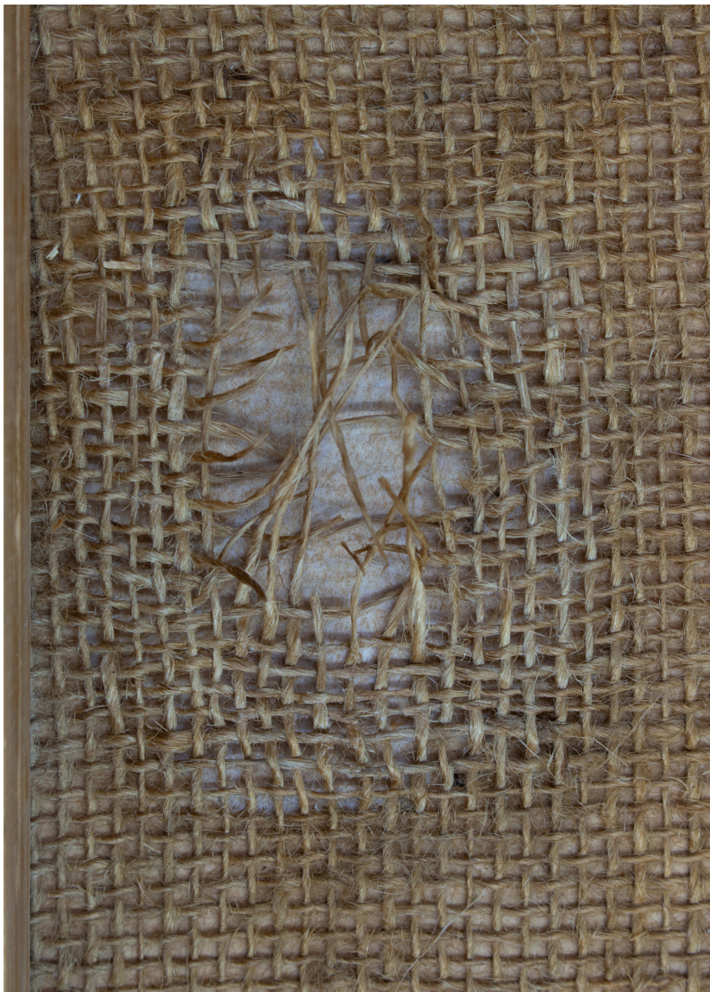
Scelování jutového plátna metodou vlákno na vlákno tepelnou špachtlí a polyamidovým práškem
