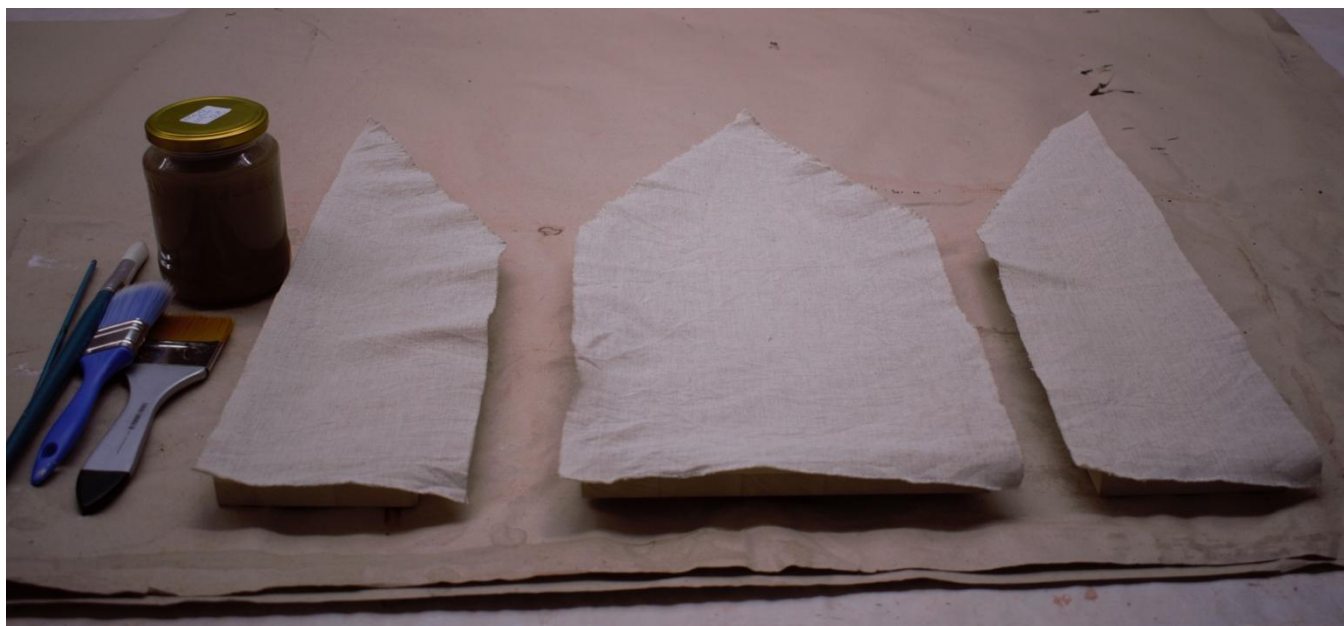
priebeh lepenia pomocou 20 % roztoku kožného klíhu
