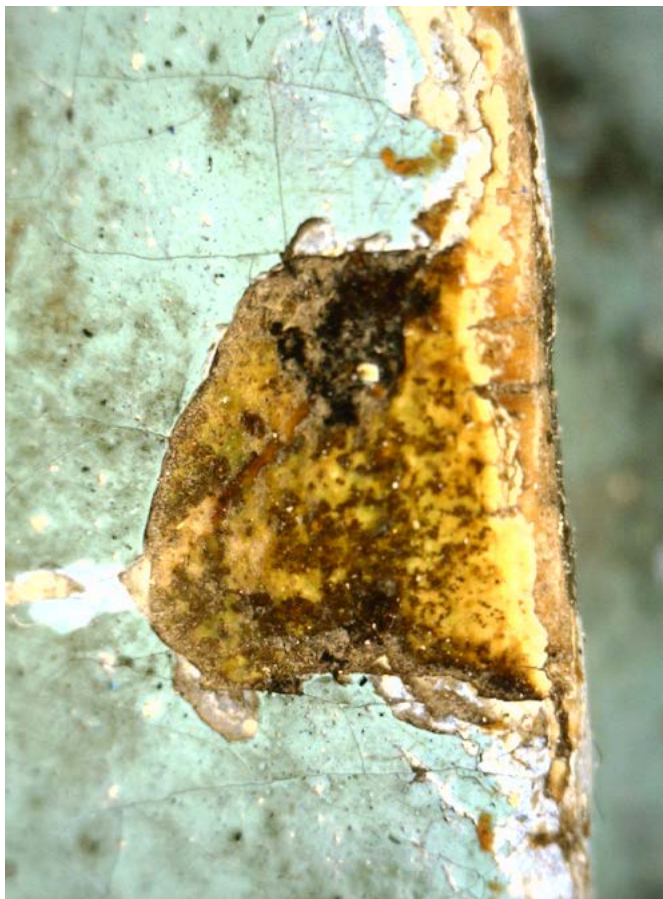
lem rukávu ruky, detail Dino-Lite, defekt až na drevo
