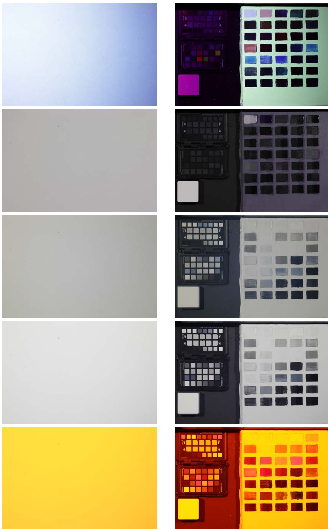
obr.15-28 - Multispektrá po vyfotení bez post-procesu, spolu s uniformnou reflexnou plochou (použitá na vyváženie WB), v poradí : VIS, UVL, UVL2, UVR, IRR, VIL, VIVL
