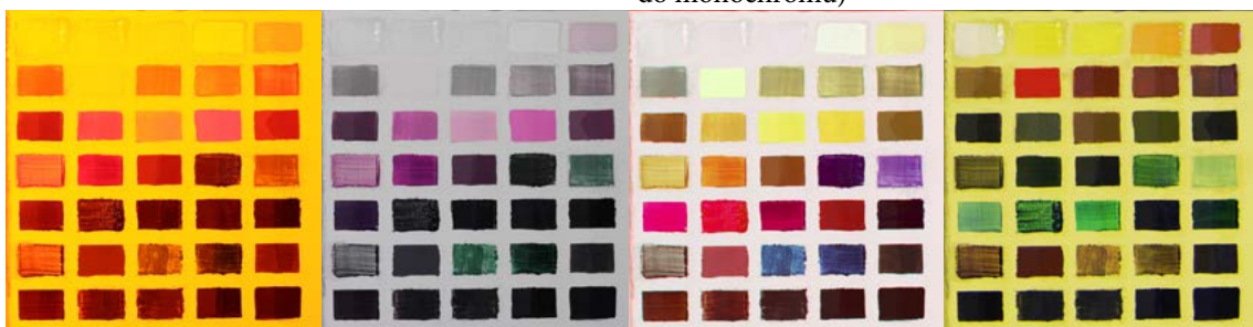
obr. 40-41 Viditeľným svetlom vyvolaná viditeľná luminiscencia VIVL pred a po spracovaní v NIP 2 (flatfielding, farebná kalibrácia)
