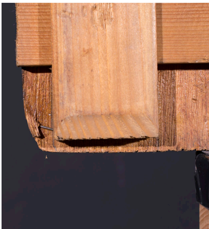
Detail defektu v rohu dřevěné podložky VIS a UV luminiscence
