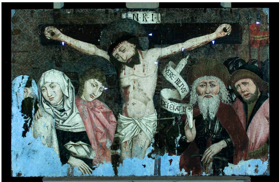
Zkoušky snímání zbytku pryskyřičného laku UV luminiscence
