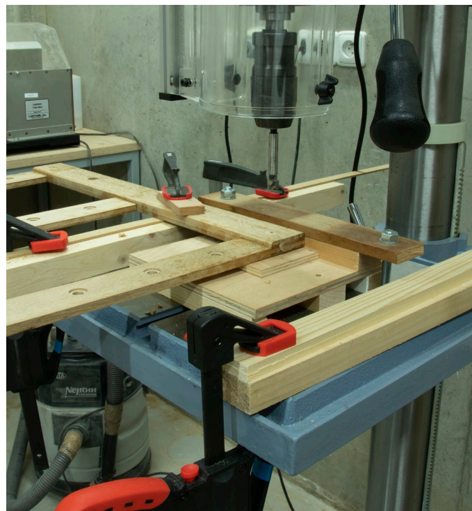
Dovrtání otvorů do rohů rámu po slepení
