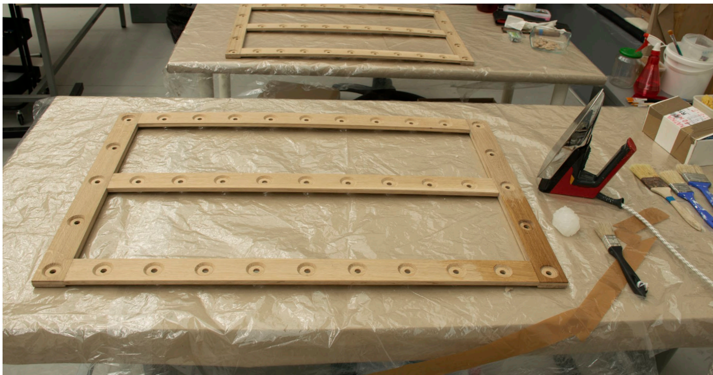
Průběh voskování rámu parafinem
