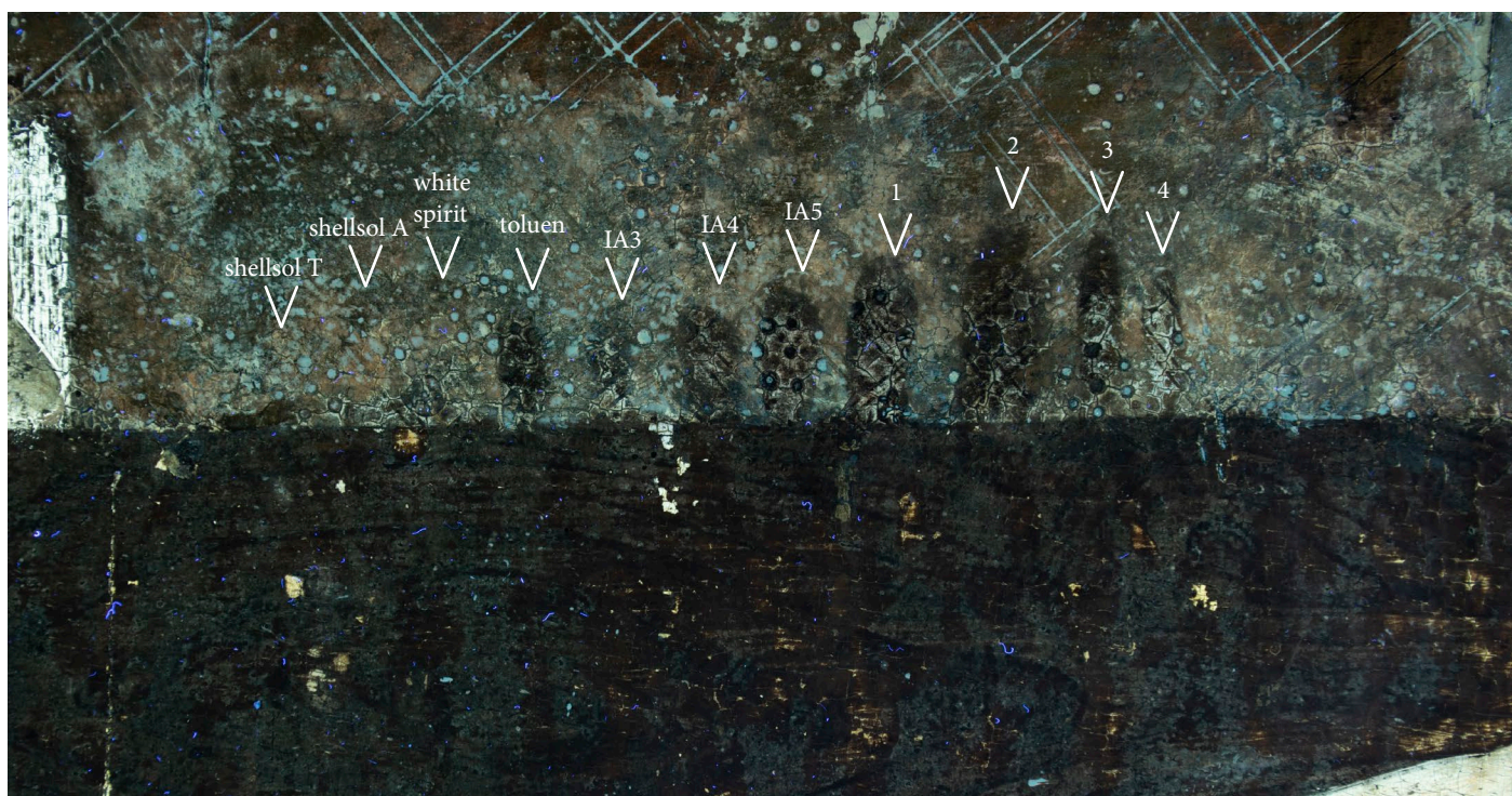
Zkoušky snímání olejpryskyřičného laku UV luminiscence
