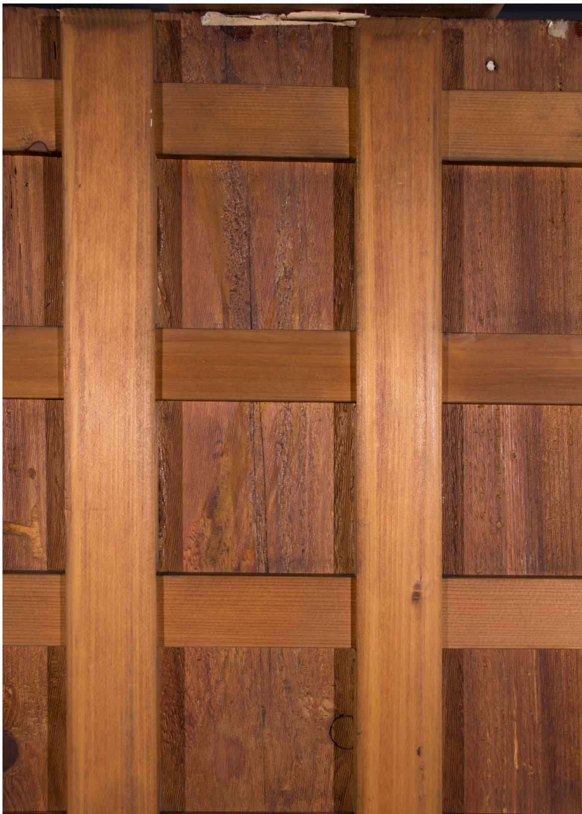
Detail největší prakliny dřevěné podložky a lepená prasklina (pravděpodobně akrylátovým lepidlem, stejným jako k připevnění parketáže) VIS
