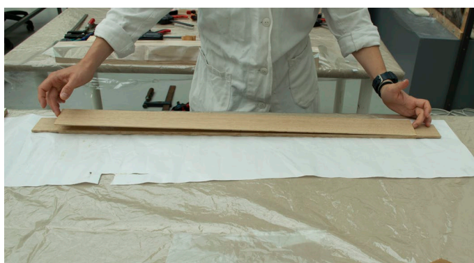
Výroba nového podpůrného systému - průběh lepení lamel epoxidovým lepidlem Araldite AW 106
