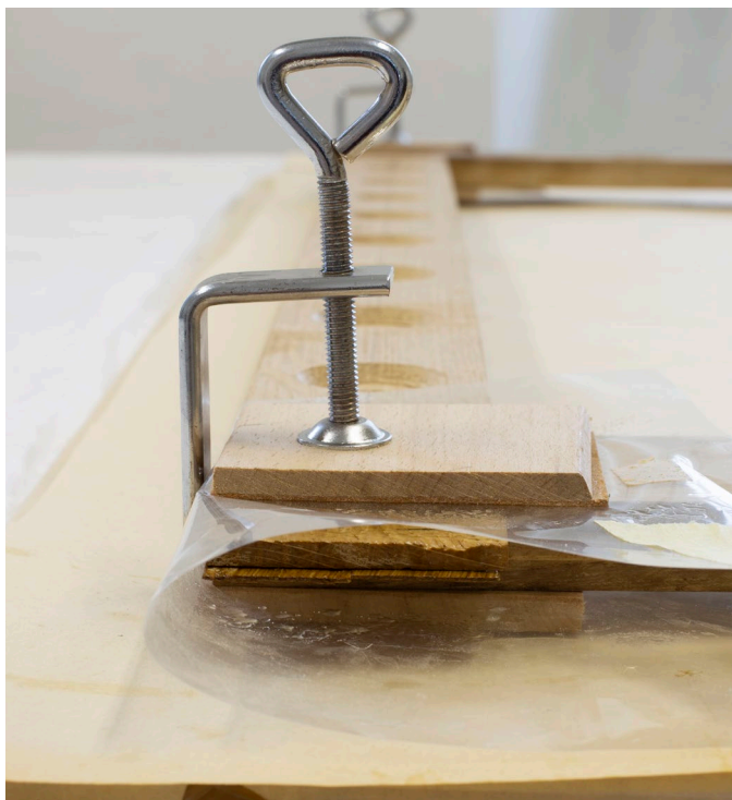
Detail lepení rámu epoxidem Araldite AW 106
