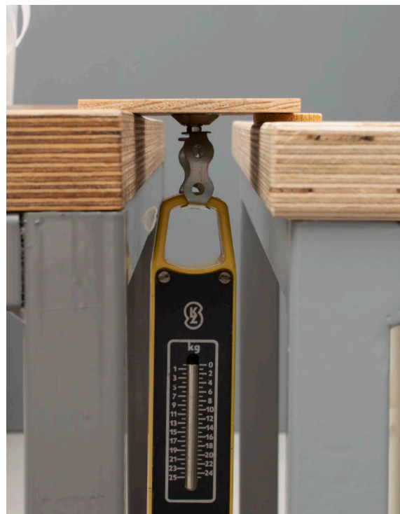
Zkoušky pevnosti lepidla postupným zatěžováním
