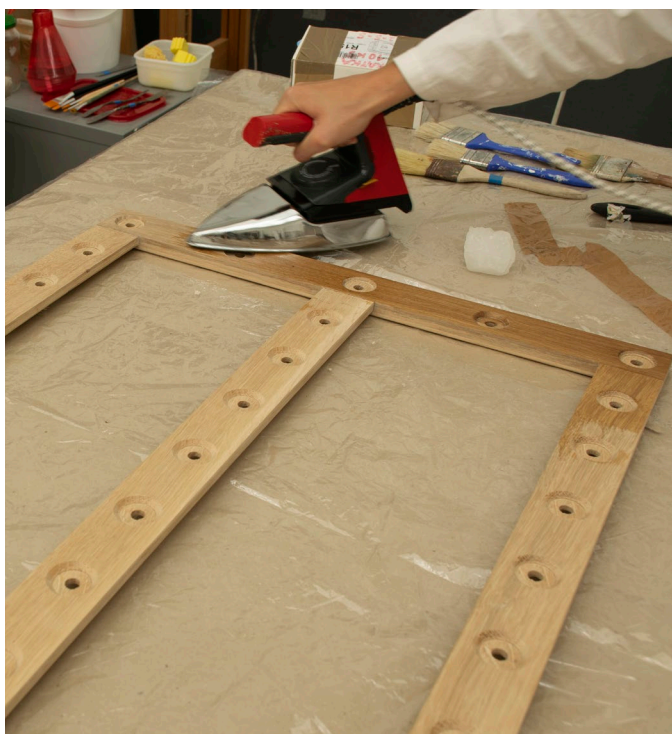
Průběh voskování rámu parafinem
