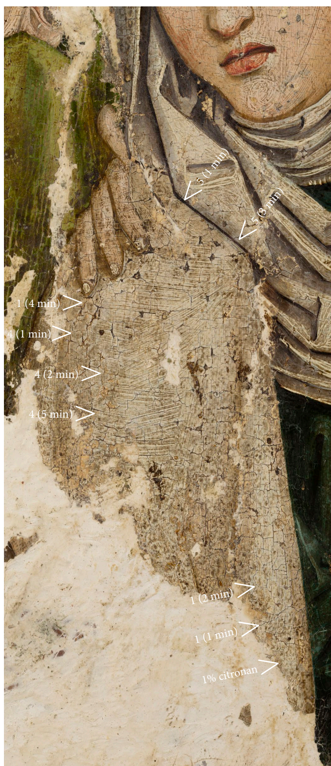
Zkoušky snímání povrchových nečistot - 5 - zahuštěná emulze VO s pufovaným roztokem a chelátem pH 8,5 VIS a UV luminiscence
