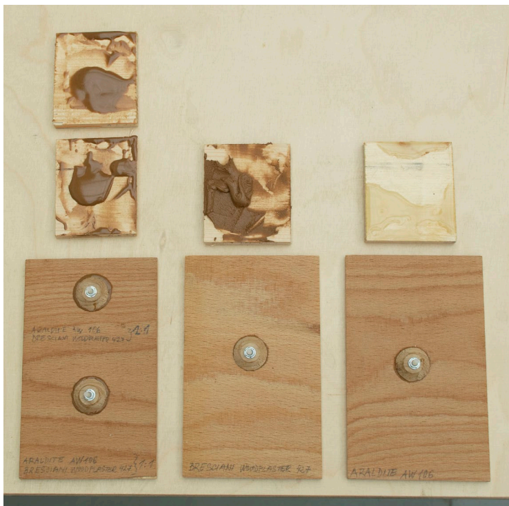
Zkoušky různých epoxidových lepidel a poměrů před přilepením tortellin na zadní stranu desky
