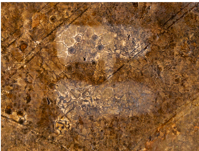
Sondy snímání olejoprskyřičného laku pomocí isooktanu:acetonu:benzylalkoholu 3:6:1; fotografie dole: zkoušky isooktanu:acetonu:benzylalkoholu v různých poměrech (5:3:2, 3:6:1) VIS a UV luminiscence
