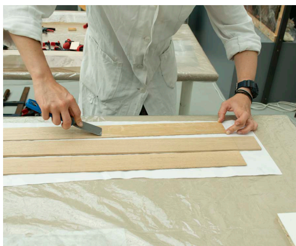
120 - Průběh lepení dubových lamel epoxidovým lepidlem
