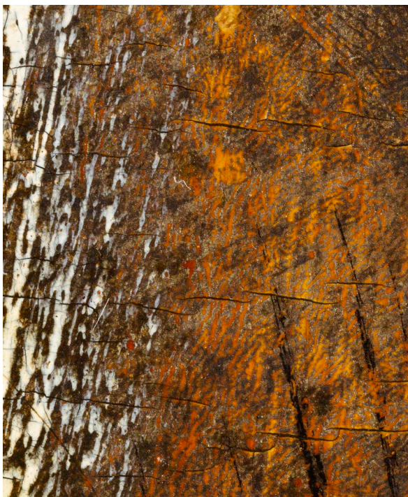
100 - Detail poškození stříbrného pokovení na brnění Longina
