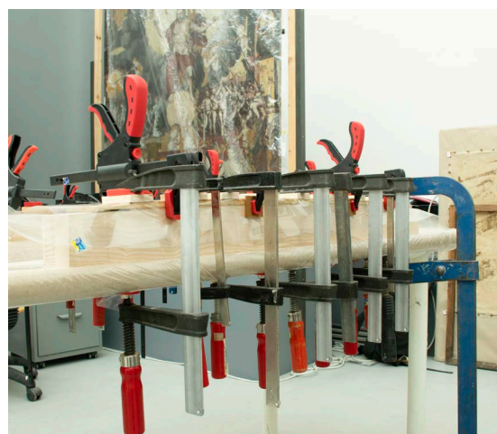
121 - Lepení lamel do křivky, kterou deska přirozeně zaujímá
