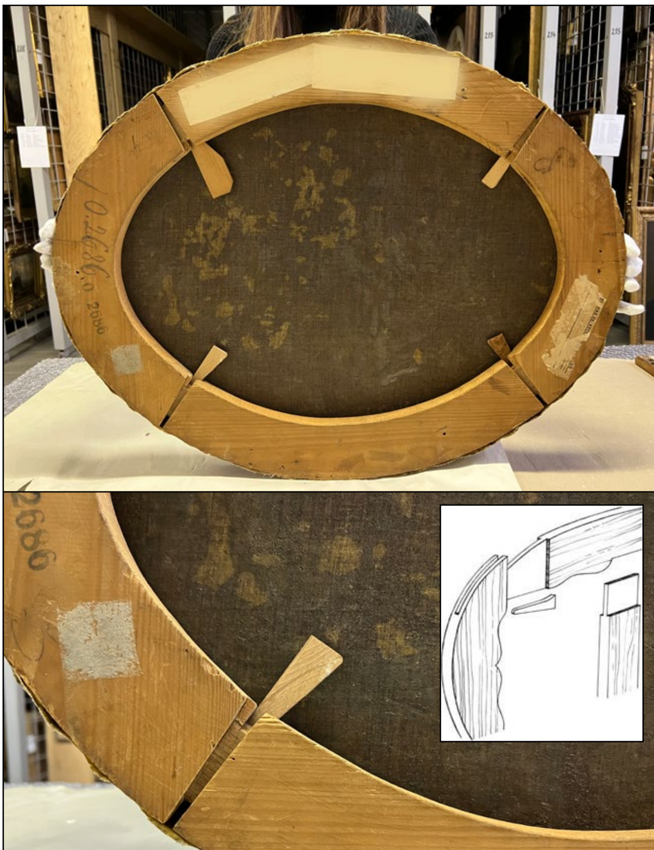
Oválný spodní vypínací obrazový rám se čtyřmi čepovými spoji (drážka a čep) s možností klínkování Detail spoje s vyklínkováním
