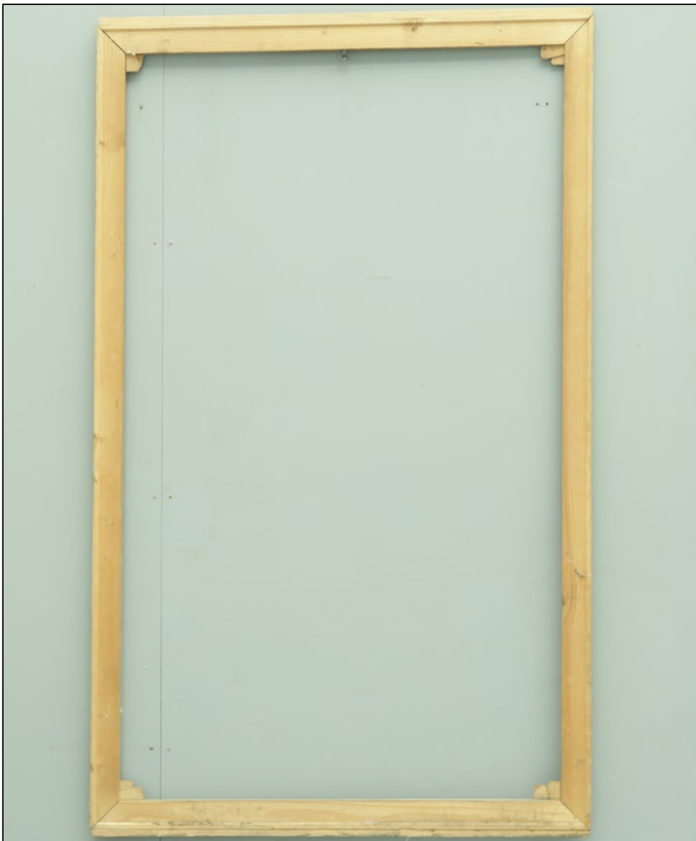
Dřevěný spodní vypínací obrazový rám Rám s možností dopnutí v rozích s oboustraným pokosovým spojem a dvojím klínkováním Rámová lišta je po obvodu zvýšená na bočních lištách pomocí přidané latky Přední strana
